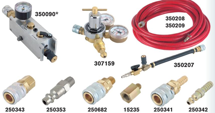
**Nr. 307159** – Druckreduzierventil. Ermöglicht den Einsatz von Flaschengas zum Aufblasen der Kissen (für CGA-580 Stickstoff-, Argon- oder Heliumflaschen). Mit Standard-Anschlussarmatur am Einlass und 1/4-Zoll-Innengewinde nach US-Industrienorm am Auslass. Gewicht 1,8 kg.
