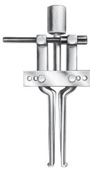
**Innenabzieher** haben schmale Backen, die mittig durch das abzuziehende Teil geschoben werden. So wird die Zugkraft senkrecht ausgeübt und das Gehäuse wird nicht beschädigt. Die Backen sind verstellbar, so dass sie an den jeweiligen Durchmesser des abzuziehenden Teils angepasst werden können (siehe Seite 204).
