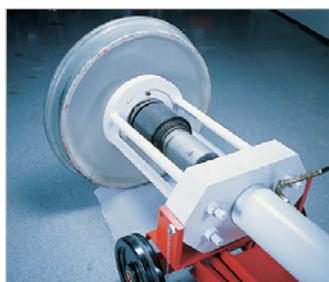
Das Foto zeigt den Universalabzieher, fertig zum Abziehen des Rollenlagers.
