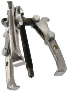
**Backenabzieher:** mechanisch oder hydraulisch. Für mehr Kraft und einfachere Handhabung empfehlen wir die Verwendung von hydraulischen Abziehern. Beide Typen sind in 2- oder 3-armiger Ausführung erhältlich; die Backen greifen um den äußeren Rand des Werkstücks; sie können jedoch auch zusammen mit Abziehplatten für Lager oder Riemenscheiben verwendet werden (siehe Seiten 196 bis 197, 210 bis 222 und 223).
