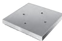
Embase de vérin en aluminium – Lorsqu'une base plus large s'avère nécessaire ou avantageuse. Se fixe à la base des vérins RA556, RA556L et RA5510 avec quatre vis de 3/8"-16 vis (incluses). Les stries assurent une stabilité supplémentaire.
