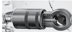
Kesici bıçakta ölçekli hizalama işareti.
