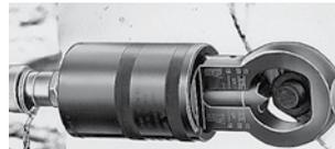
**Markierung des Schneidmessers an Skalierung ausrichten.**
