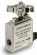
Dosificación precisa para el retorno controlado del pistón de cilindro. Operación: Permite el caudal libre al extender el cilindro y el alivio de la presión interna; mientras que la función Posi-Check® bloquea y retiene la carga en posición elevada hasta que el operador abre la válvula. Número de pedido: 9596
