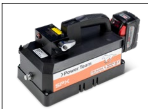
Hydraulikpumpe mit 690 bar, Lieferung in betriebsbereitem Zustand, Antrieb über Lithium-Ionen-Akku (18 VDC), Versand einschließlich Hydrauliköl.
