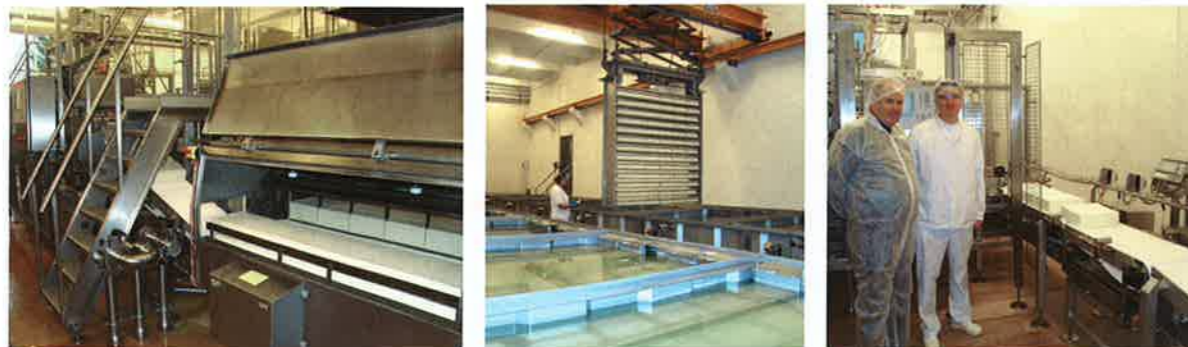
Fra venstre mod højre: Efter udskæring og presning bliver ostene ført til saltning, hvor de placeret i store reoler og med et enkelt tryk på en knap bliver sænket ned i saltkarrene. På billedet til højre ses SPX' projektleder Svend Jessen sammen med Thems produktionschef Morten Christiansen ved siden af transportbåndet, hvor ostene føres videre til efterbehandling og lagring.
