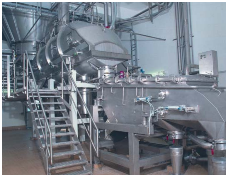
带筛分机的Anhydro（埃海德诺）3-A ® 喷雾干燥设备
