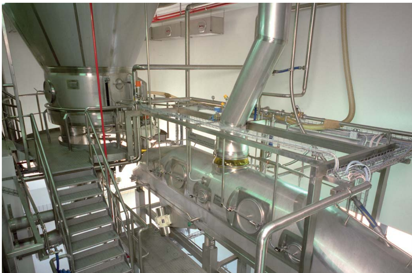
Anhydro (埃海德诺) 流化床与喷雾干燥设备的组合
