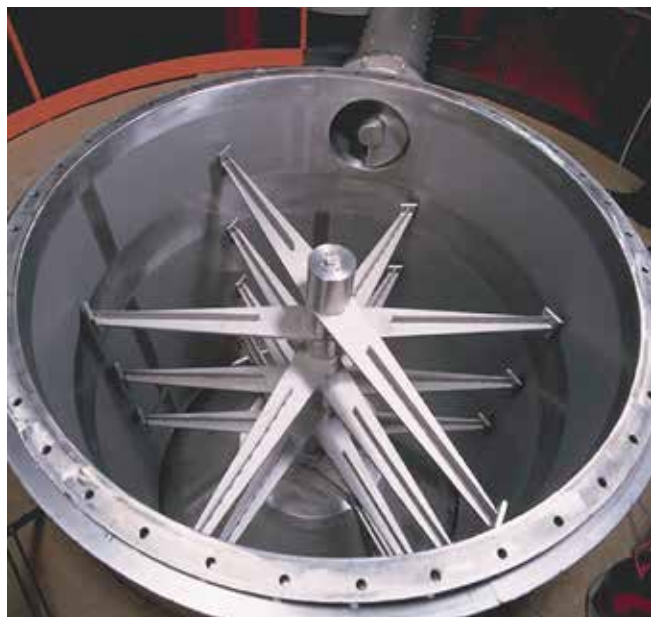
Spin Flash® Trockenkammer von innen gesehen
