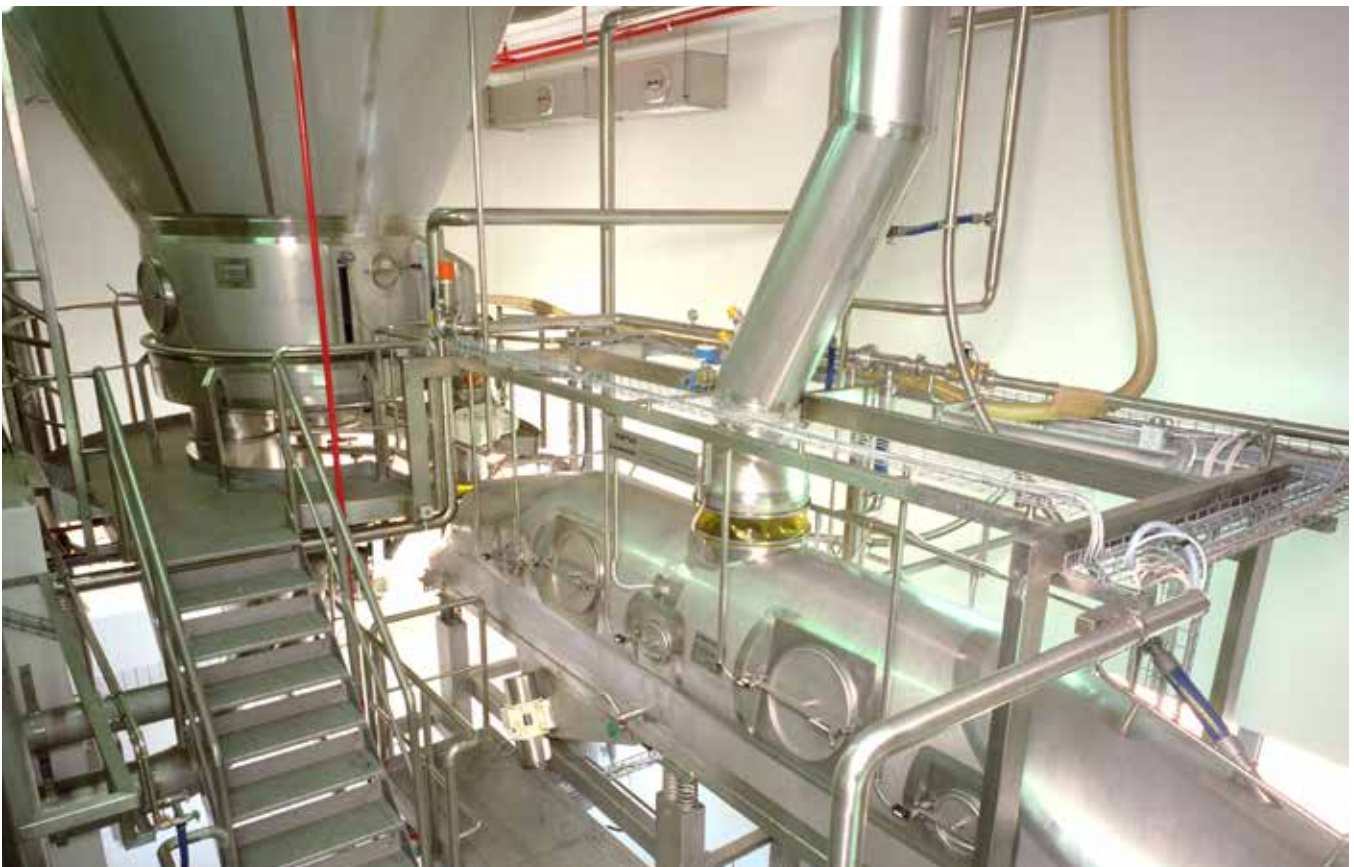
Anhydro Fließbett in Kombination mit einer Anhydro Sprühtrocknungsanlage
