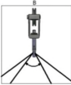
图 34： 吊装钢丝最大角度
