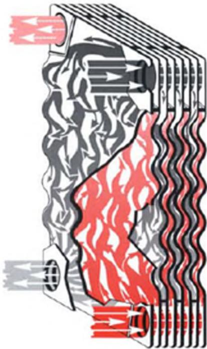
Abbildung 7: Turbulente Strömung
