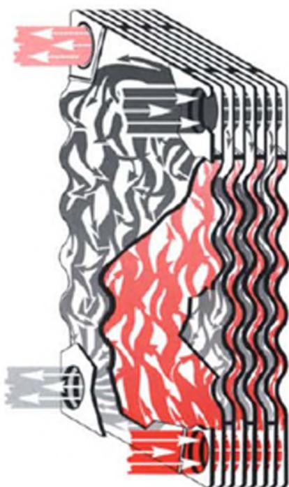
Figura 7: Fluxo Turbulento
