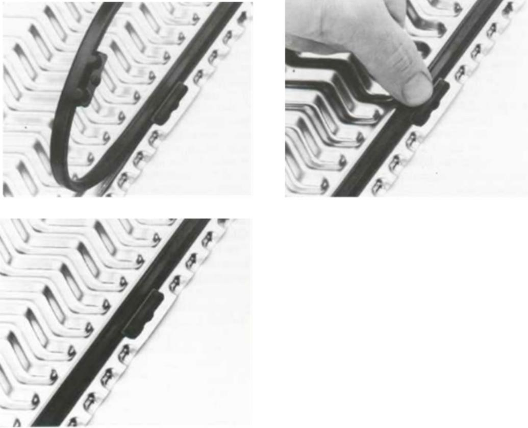
Figura 46: Fixação de gaxetas Paraclip
