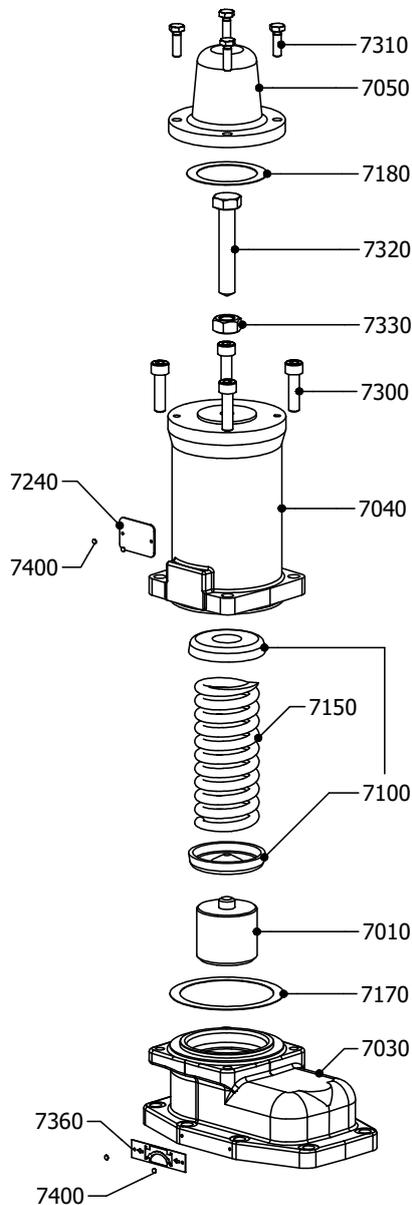
Soupape de décharge de sécurité simple – verticale
