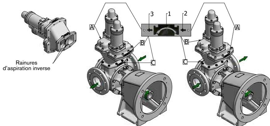
Lorsqu'une soupape de décharge de sécurité double est installée, trois plaques fléchées sont fixées – une sur chaque soupape (A et B) indiquant le sens d'écoulement du liquide (petites flèches 2 et 3) et une sur la culotte de la soupape (C) indiquant le sens le plus favorable de rotation de la pompe (flèche 1).
