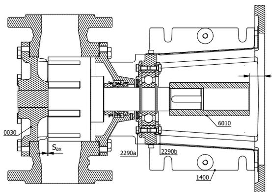
Il est également possible de régler le jeu axial en utilisant un support magnétique et un comparateur à cadran.
