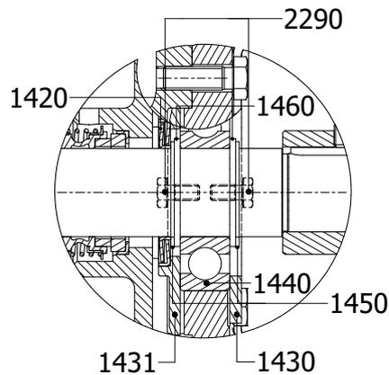
*Démontage et montage du roulement des pompes
