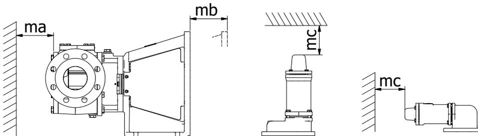
Il est impératif que le dispositif de commande de la pompe/motopompe soit toujours accessible (y compris en cours de fonctionnement).
