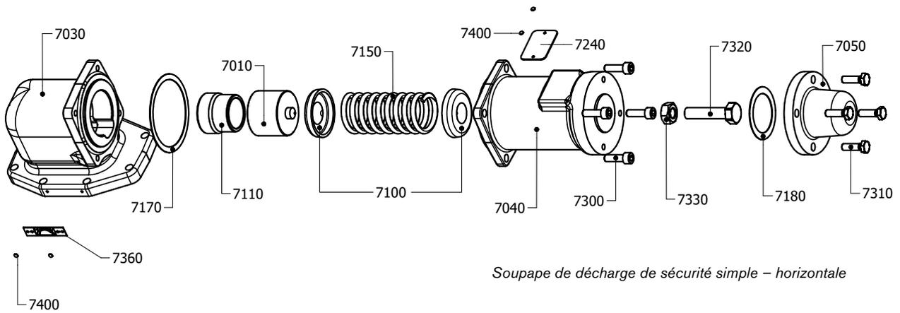
Soupape de décharge de sécurité simple – horizontale
