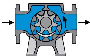
Le rotor et le pignon s'imbriquent et le liquide est poussé dans la conduite de refoulement.
