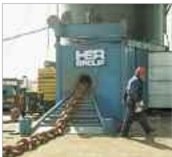
Bomba PE4004S e cilindro RD3006 usados em prensa especial para reparar elos da corrente da âncora para indústria marítima.
