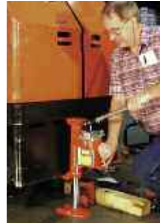
Macacos de unha da série J, extremamente reforçado, usado no levantamento de um caminhão de serviço.
