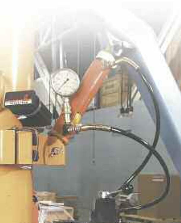
Bomba PA6D com manômetro de pressão digital e cilindro de 25 tons usado em um teste de fixação.
