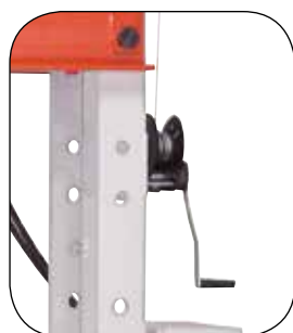
El cabrestante facilita la colocación de la plataforma de la prensa
