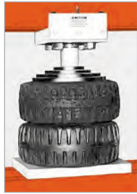
Montage de jante dans un pneu neuf sur la presse Power Team.
