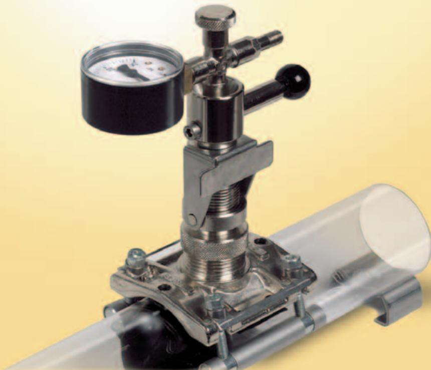
Die Abspernung erfolgt durch das Einsetzen und Aufpumpen eines Ballons in dem abzusperrenden Rohr. Um den Ballon in das Rohr einzuführen, muss eine Manschette montiert und ein Loch in das Rohr gebohrt werden. Die Ballons sind in vier Größen erhältlich. Die Ballons und Werkzeuge sind farblich markiert, um die richtige Größe auswählen zu können. Nachdem die Arbeit erledigt ist, wird der Ballon wieder aus dem Rohr gezogen und die Manschette mit einer Kappe verschlossen.
