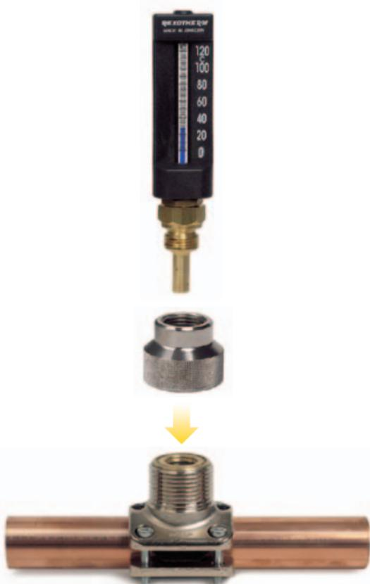
Mit dem Tauchrohradapter kann man ein Thermometer oder andere Messgeräte in ein Rohr im Druckbetrieb einsetzen. Das Leitungssystem muss nicht abgesperrt oder entleert werden. Der Tauchrohradapter wird auf eine Manschette mit einem Rückschlagventil geschraubt. Das Messgerät wird dann durch den Adapter in das Rohr eingesetzt.
