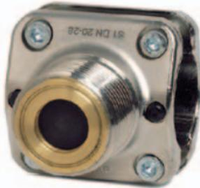
Die Manschette mit Rückschlagventil wird für kleinere Abzweigungen, der Installation von Adaptern für Tauchrohren und für Absperrungen eingesetzt. Für die Abzweigung wird ein Kugelhahn auf die Manschette montiert, der die Rückschlagklappe öffnet. Für das Tauchrohr wird ein Adapter auf die Manschette geschraubt und für die Absperrung wird ein Ballon mit Hilfe eines entsprechenden Werkzeuges in das Rohr eingeführt. Die Bedienungsanleitung finden Sie auf den Seiten 12 und 13.
