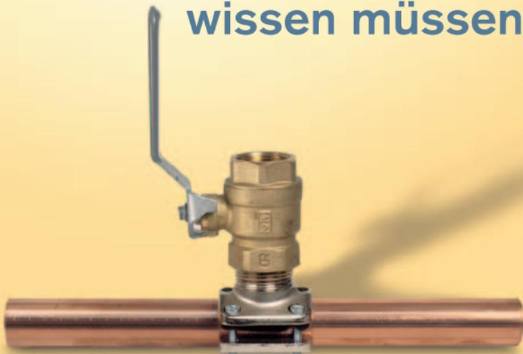
Abzweigungen an Rohren im Druckbetrieb, sei es Wasser oder Luft, können mit NoTap schnell und einfach durchgeführt werden. Die Klemme, die an das Rohr montiert wird, ist die Manschette. Nachdem die Manschette an das Rohr angebracht und festgeschraubt ist, wird mit einem speziellen Bohrer die Arbeit durchgeführt. Währenddessen ist die Leitung unter Druck. Daher muss das System nicht entleert werden.
