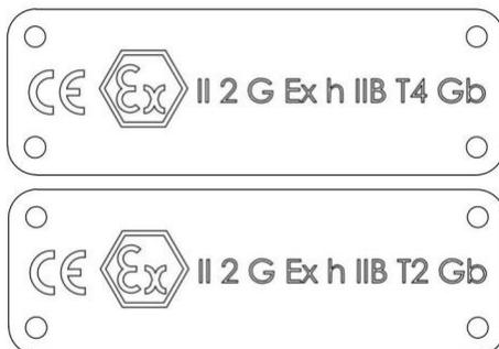
**Ilustración 91 Placas de identificación ATEX**
