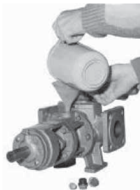
Påfyldning af pumpen
