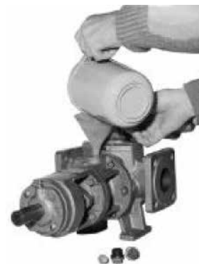
Riempimento della pompa
