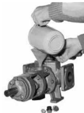
Het vullen van de pomp
