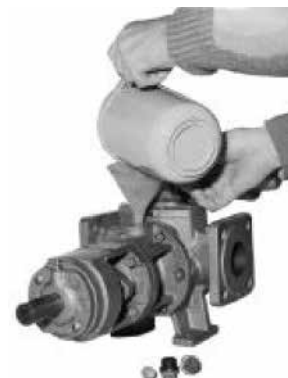
Påfyllning av pumpen
