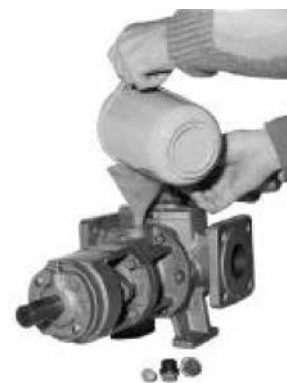
Füllen der Pumpe
