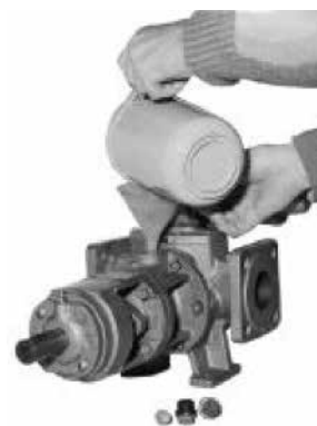
Remplissage de la pompe
