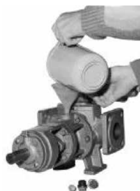
Påfyllning av pumpen
