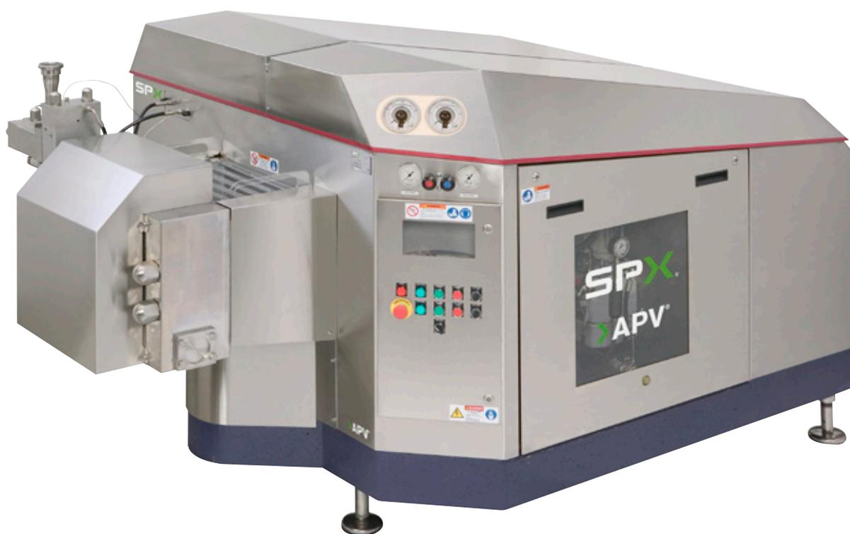
L'homogénéisateur 110T APV est une pompe alternative à trois pistons, équipée d'une vanne d'homogénéisation à étage unique (deux étages en option) avec des vérins hydrauliques réglables manuellement.
