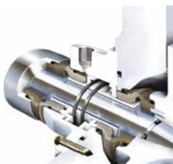
Doppelmechanische Dichtung, vorbereitet für Spülung oder Dampfsperre
