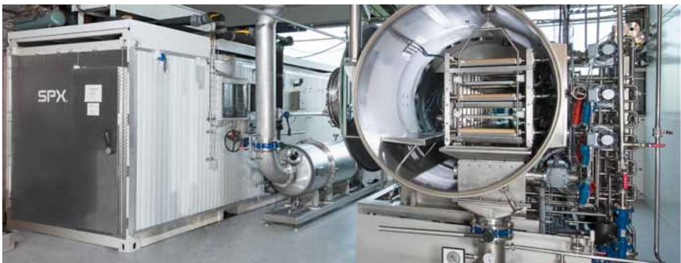
Die Pilotanlage zur Vakuumbandtrocknung ist als Durchlauftrockner ausgeführt. Die Produkte können in flüssiger oder fester Form (über eine Schleuse) zugeführt werden, ohne dass der Trocknungsvorgang unterbrochen oder anderweitig beeinträchtigt wird. Über zwei große Schaugläser kann der Trocknungsprozess direkt beobachtet werden. Auf diese Weise lassen sich die Trocknungseigenschaften präzise einstellen.
