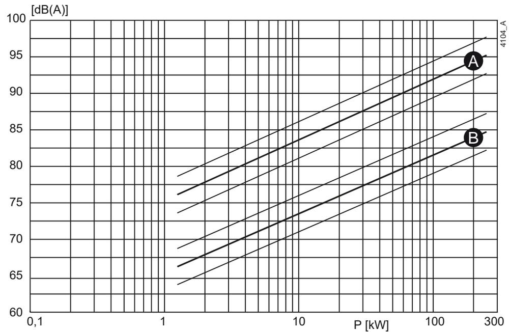
Рисунок 25: Зависимость уровня шума от мощности насоса [кВт]
