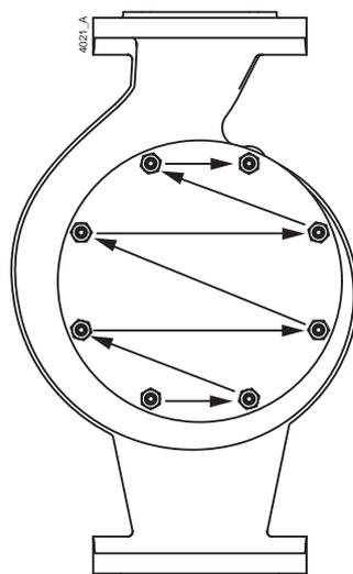
Рисунок 6: Последовательность отвинчивания гаек крепления проставочного кольца.
