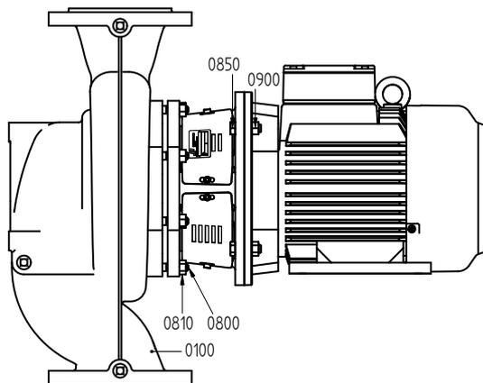
Рисунок 5: Разборка узла обратного извлечения.
