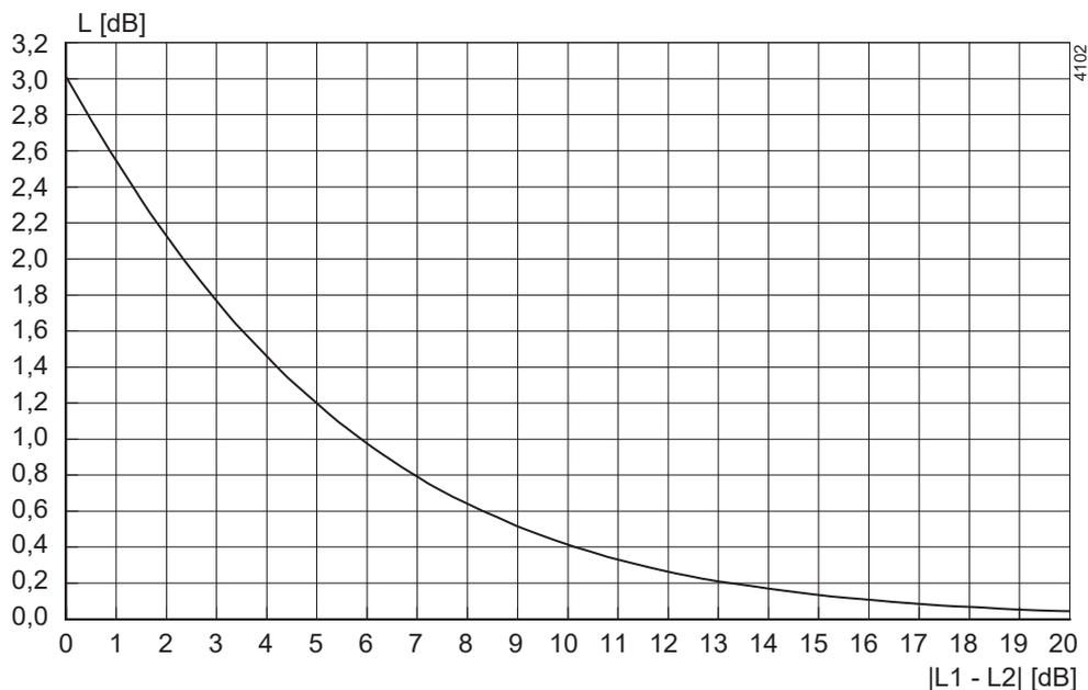
Рисунок 26: Уровень шума насосного агрегата в целом.
