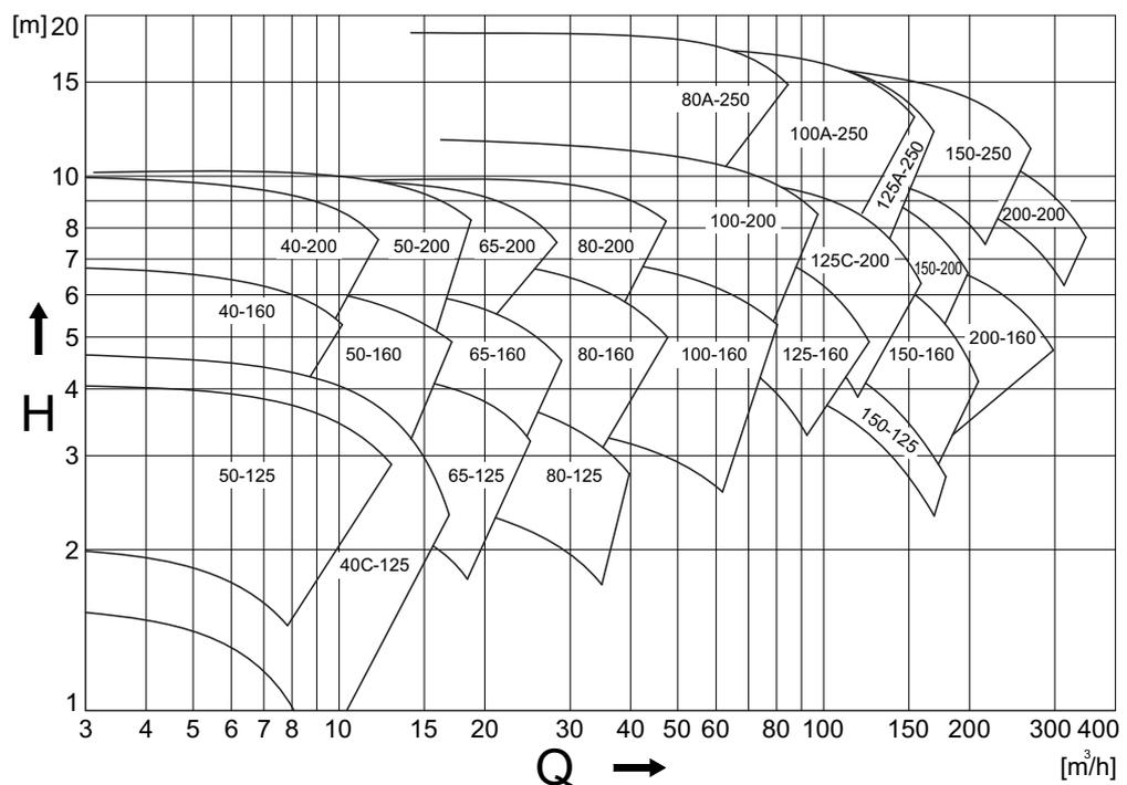
Рисунок 23: Обзор рабочих параметров при 1200 мин<sup>-1</sup>.
