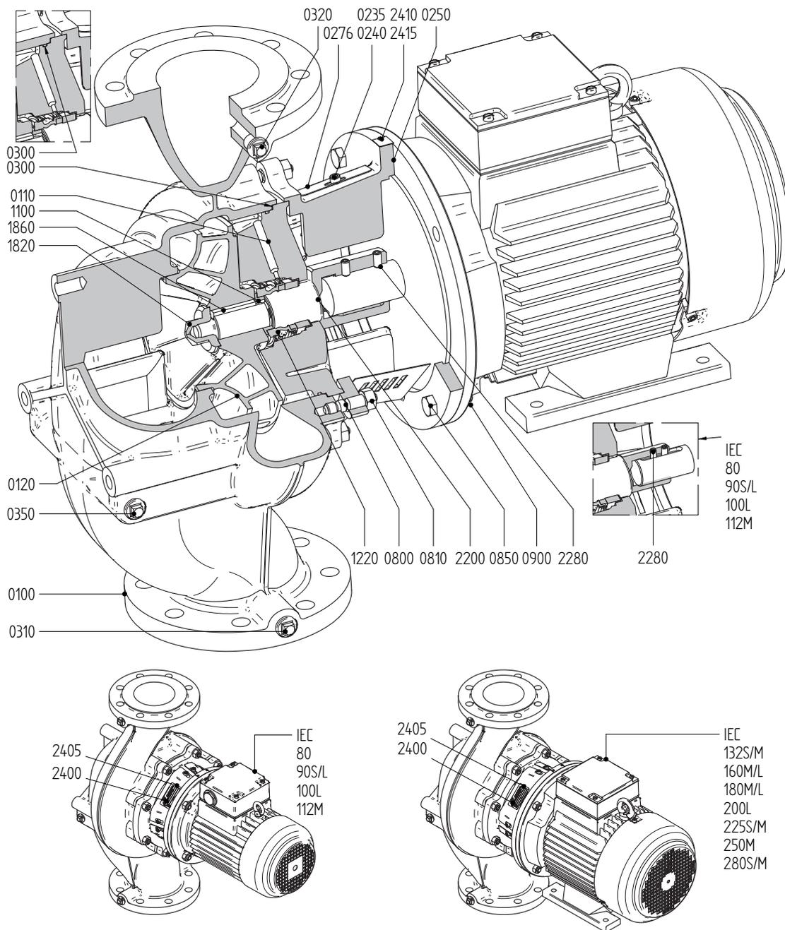
Рисунок 15: Чертеж в разрезе.
