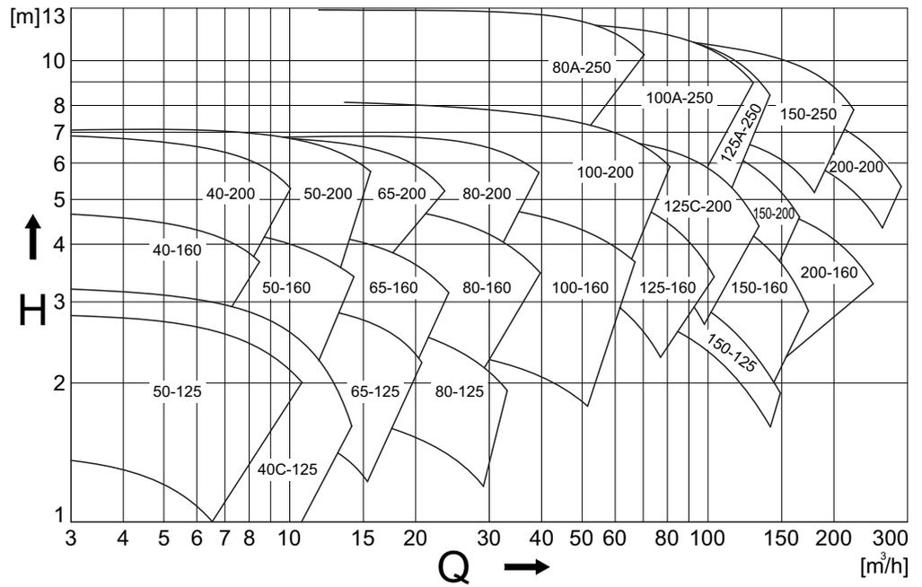
Рисунок 20: Обзор рабочих параметров при 1000 мин<sup>-1</sup>.
