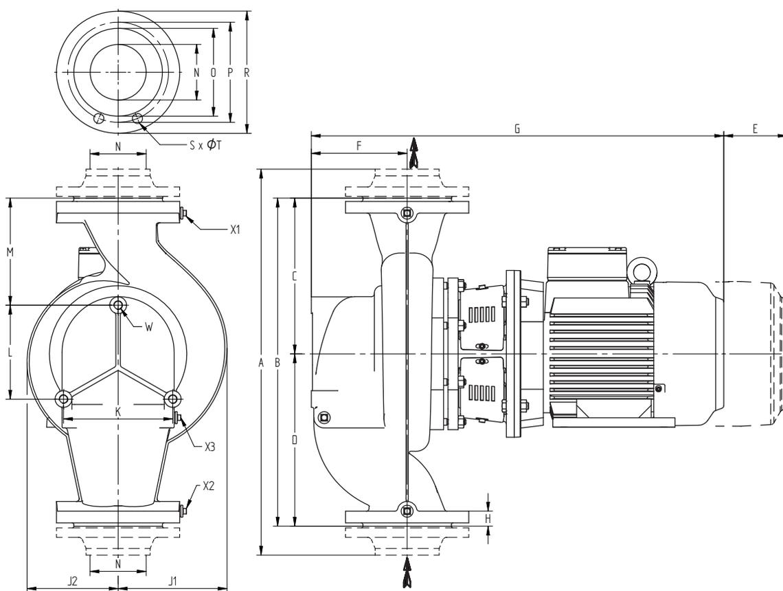
Рисунок 13: Размерный чертеж насоса.
