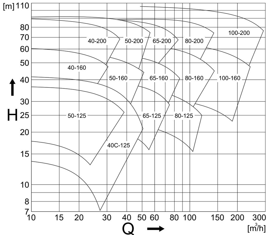
Рисунок 21: Обзор рабочих параметров при 3600 мин<sup>-1</sup>.
