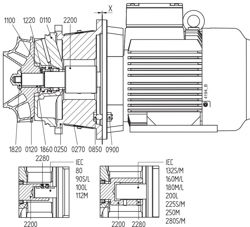
Рисунок 12: Сборка втулочного вала
