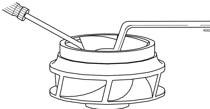
Рисунок 8: Ослабление гайки крыльчатки.
