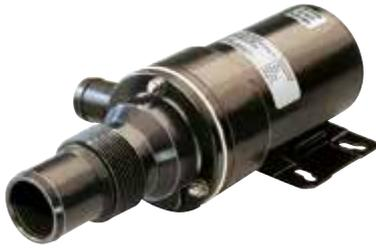
La bomba maceradora TA3P10-19 cuida del agua del inodoro. Un cortador rotativo desmenuza el residuo antes de ser bombeado hacia o fuera del tanque de retención. La bomba debe estar conectada lo más cerca posible de la descarga del tanque o de la descarga de salida del tazón. ¡Observación! Use solo papel higiénico no blanqueado.
