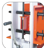
提升螺钉以及锁固销 使单人即可操作压力 机的升降
