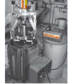
上图所示为SGH153CR拉马加配一个轴承拉拔附件，用以从一个深井泵电机上取出轴承。
