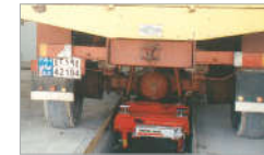
P300手动泵和10吨油缸用于汽车顶升
