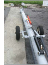
图为一台型号为P55的手动泵应用于航空设备的拖轮。
