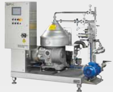
Bebidas alcoólicas – Clarificador de sucos, vinho e espumante
