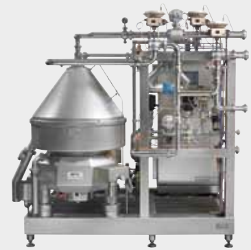
Laticínios - Separadora de leite com sistema de normalização automática de leite e creme
