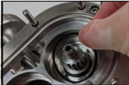
**Abbildung 46 - Montage des Leitring-O-Rings**
