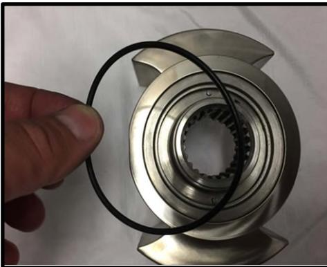
**Abbildung 117 - Abnehmen des Dichtungs-O-Rings**
