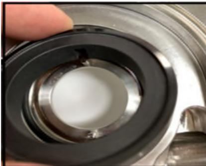
**Abbildung 48 - Montage des Leittrings**
