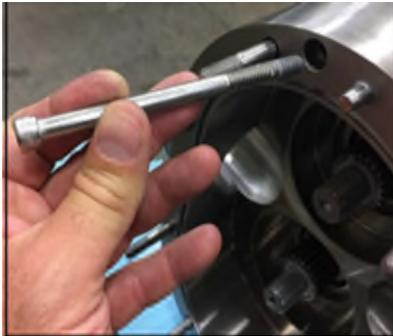
**Abbildung 67 - Montieren Sie die Gehäusebefestigungsschrauben**
