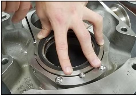
**Abbildung 195 - Montage der Dichtungshalterungsschrauben**
