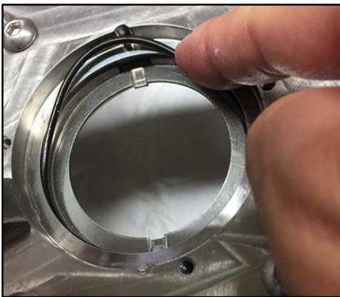
**Abbildung 168 - Montage des Dichtungs-O-
