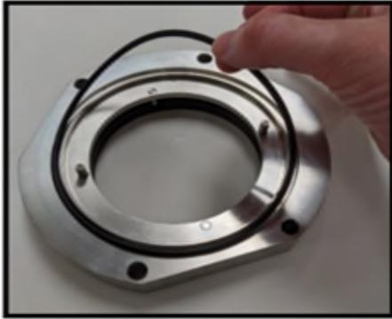
**Abbildung 93 - Montage des Dichtungsgehäuses O-Ring**
