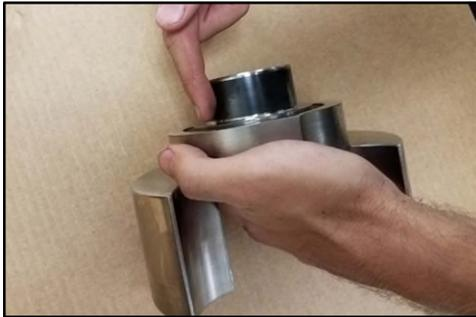
**Abbildung 252 - Schmierung der Dichtungsmanschette**
