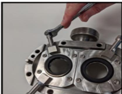
**Abbildung 101 Montage der spülseitigen Anschlussverlängerungen**
