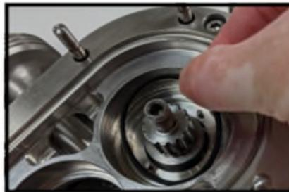
**Abbildung 110 - Montage des Leitring-O-Rings**
