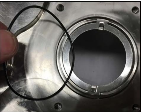
**Abbildung 163 - Montage des Dichtungsgehäuse-O-Rings**
