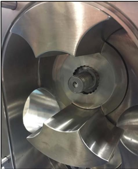
Abbildung 256 - Montierter Rotor
