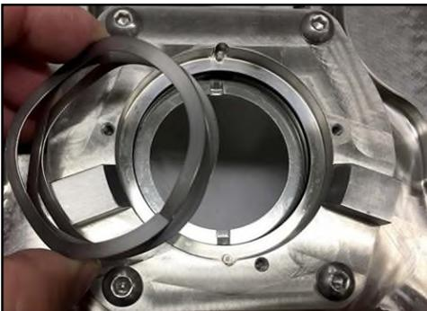
**Abbildung 150 - Entfernen der Wellenfeder**
