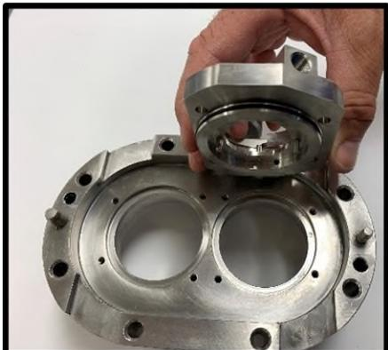
**Abbildung 89 - Ausbauen des Dichtungsgehäuses**
