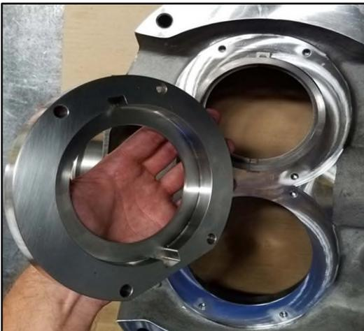
**Abbildung 124 - Ausbauen des Dichtungsgehäuses**
