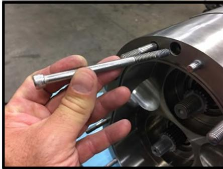
Abbildung 79 Entfernen der Gehäusefestigungsschrauben
