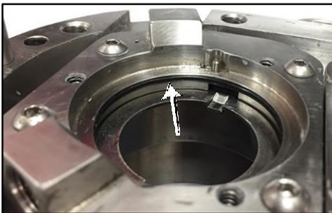
**Abbildung 169 - Lage des Dichtungs-O-Rings**
