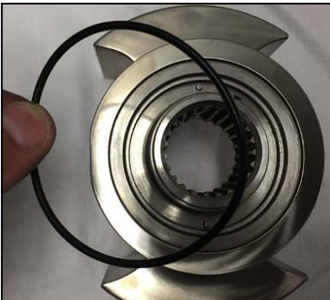
**Abbildung 213 - Montage des Dichtungs-O-Rings**
