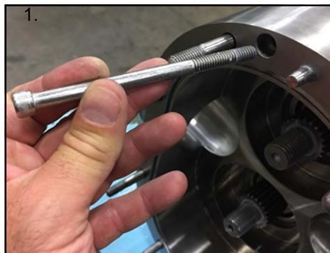
Abbildung 207 - Montieren Sie die Gehäusebefestigungsschrauben
