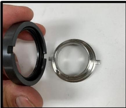
**Abbildung 104 - Montage der spülseitigen Rotationsdichtung**
