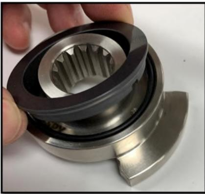
1. Nehmen Sie die Rotationsdichtung vom Rotor.
