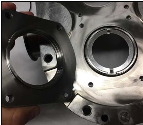
**Abbildung 165 - Montage des Dichtungsgehäuses**
