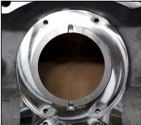
**Abbildung 139 - Montierter Antriebsring**
