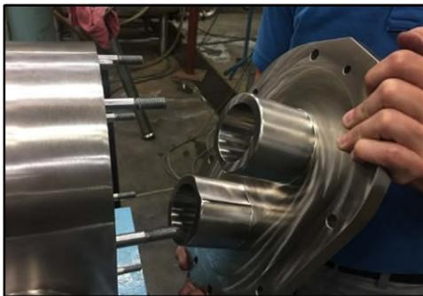
Abbildung 264 - Montage des Deckels
