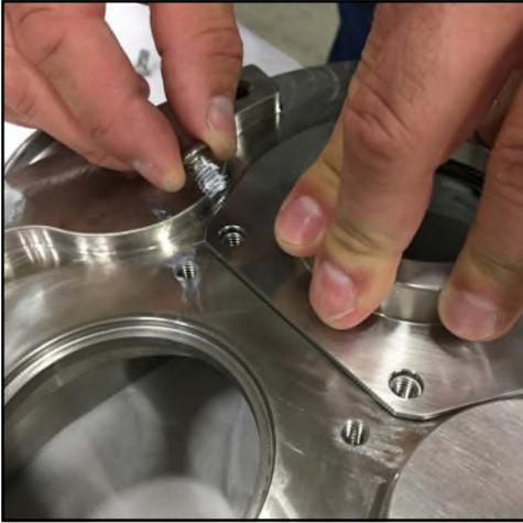
**Abbildung 122 - Herausnehmen der Schrauben des Dichtungsgehäuses**
