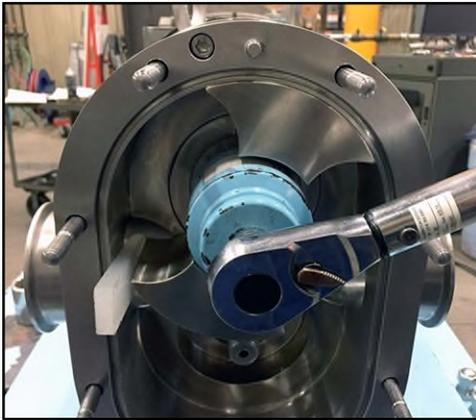
Abbildung 260 - Festziehen der Rotormutter auf Drehmoment
