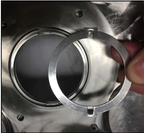
Abbildung 126 - Entfernen des Antriebsrings
