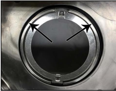
**Abbildung 164 - Montierter Dichtungsgehäuse-O-Ring**
