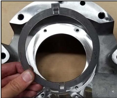
**Abbildung 138 - Montage des Antriebsrings**
