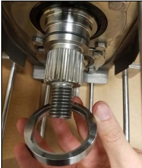
**Abbildung 231 - Ausbau des Dichtungssitzes**
