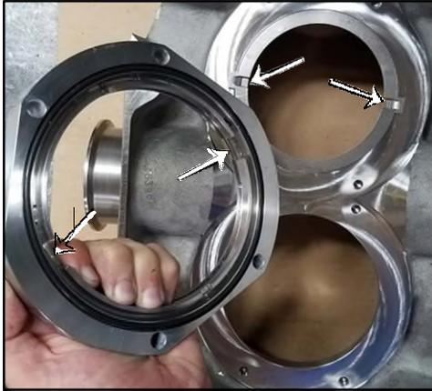
**Abbildung 188 - Montierter Dichtungsgehäuse-O-Ring**
