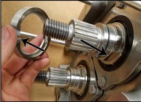
Abbildung 240 - Montage des Dichtungssitzes
