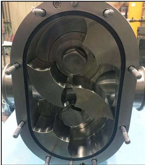
Abbildung 263 - Montierte Deckeldichtung
