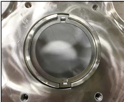
**Abbildung 132 - Montierter Antriebsring
