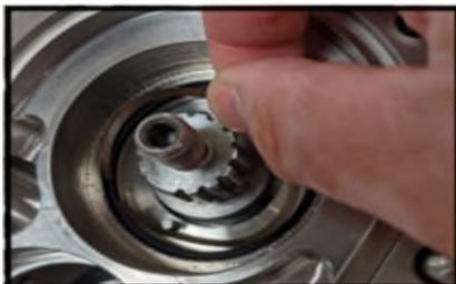
**Abbildung 111 - Montage des Leitring-Wellenrings**
