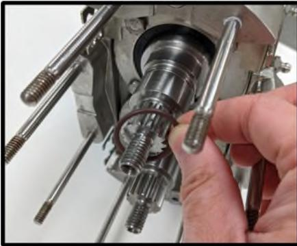
**Abbildung 102 - Montage des O-Rings**
