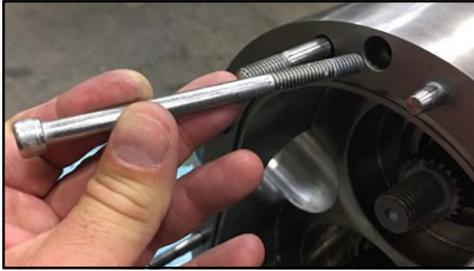
**Abbildung 225 Entfernen der Gehäusebefestigungsschrauben**
