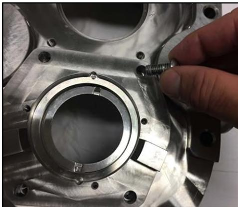
**Abbildung 166 - Dichtungsgehäuseschrauben**
