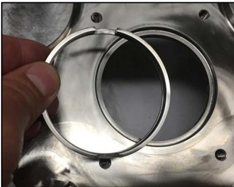
**Abbildung 129 - Montage des Wellenrings**
