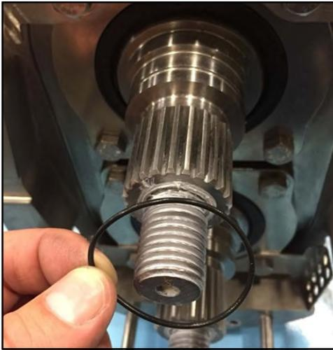
**Abbildung 197 - Montage des O-Rings**
