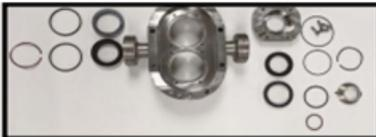
**Abbildung 91 - Doppelt wirkende Gleitringdichtung**
