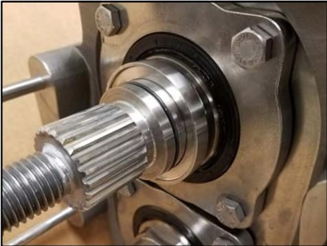
Abbildung 241 - Montierter Dichtungssitz
