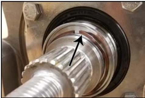
**Abbildung 230 - Entfernen der Wellenfeder**
