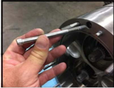
**Abbildung 109 - Montieren Sie die Gehäusebefestigungsschrauben**
