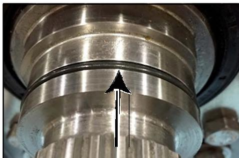
**Abbildung 147 - O-Ring des Einstellrings**
