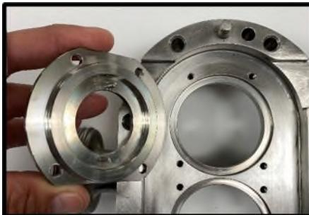
**Abbildung 62 - Montage des Dichtungsgehäuses**
