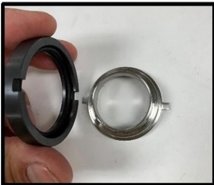
**Abbildung 82 - Ausbau der spülseitigen Rotationsdichtung und des O-Rings**
