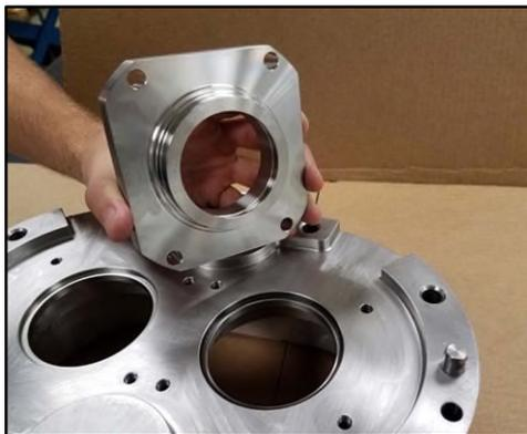
**Abbildung 228 - Ausbauen des Dichtungsgehäuses**
