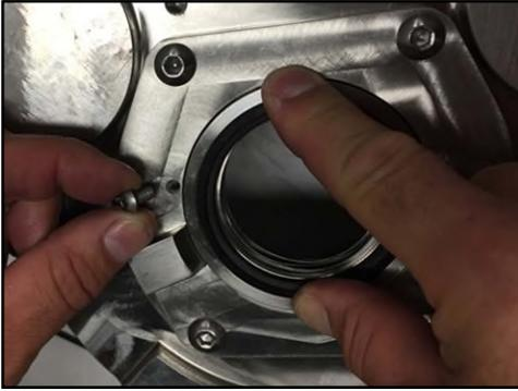
**Abbildung 174 - Montage der Dichtungshalterungsschrauben**
