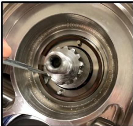
**Abbildung 78 - Abnehmen der Wellenfeder des Leittrings**
