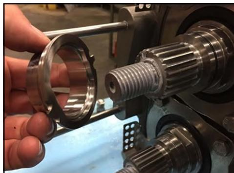
**Abbildung 179 - Montierter Einstellring**
