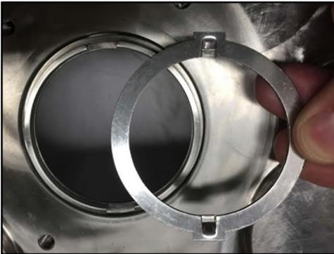
**Abbildung 156 - Entfernen des Antriebsrings**
