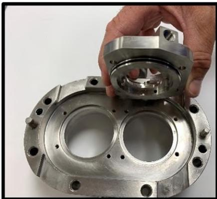
**Abbildung 94 - Montage des Dichtungsgehäuses**
