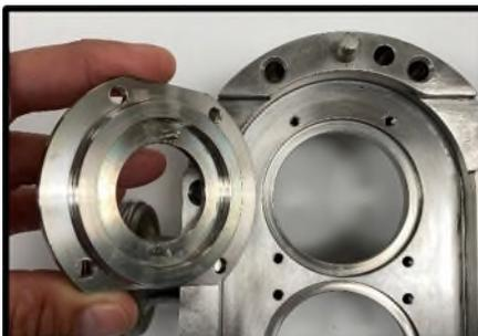
Abbildung 60 - Ausbauen des Dichtungsgehäuses
