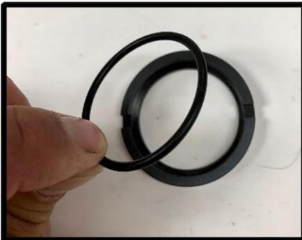
**Abbildung 103 - Montage des spülseitigen Rotations-O-Rings**
