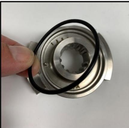
**Abbildung 53 - Abnehmen des Dichtungs-O-Rings**
