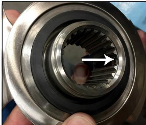
**Abbildung 253 - Synchronisierungszahn auf dem Rotor**
