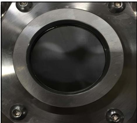
Abbildung 137 - Montiertes Dichtungsgehäuse
