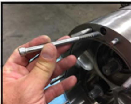
Abbildung 57 Entfernen der Gehäusebefestigungsschrauben
