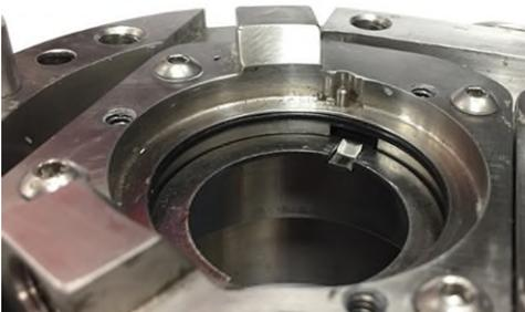
**Abbildung 151 - Lage des Dichtungs-O-Rings**
