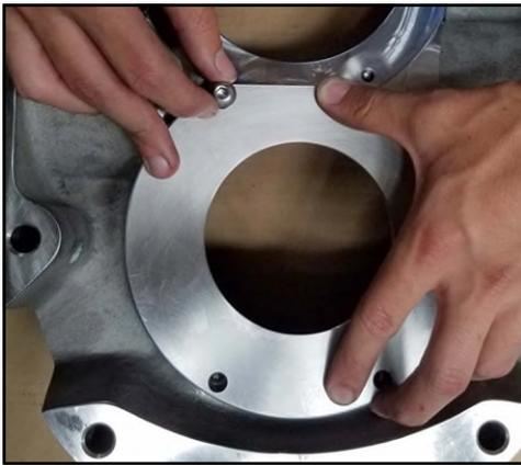
Abbildung 142 - Montage der Dichtungsgehäuseschrauben
