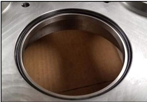
**Abbildung 233 - Montierter Dichtungsgehäuse-O-Ring**
