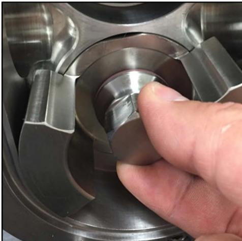
**Abbildung 259 - Montage der Rotormutter**
