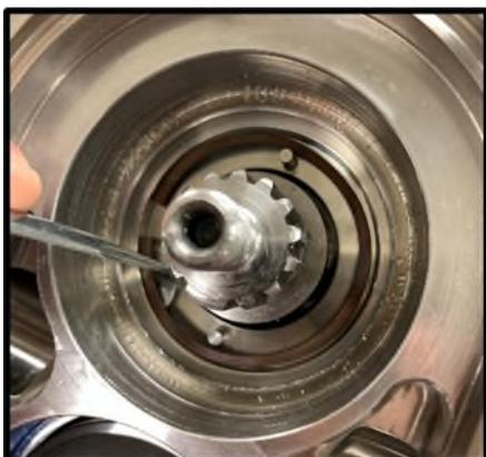
**Abbildung 45 - Abnehmen der Wellenfeder des Leittrings**
