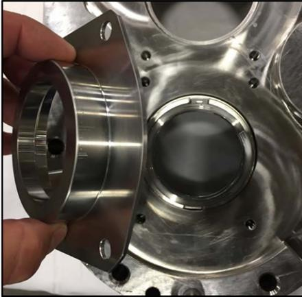
Abbildung 135 - Montage des Dichtungsgehäuses
