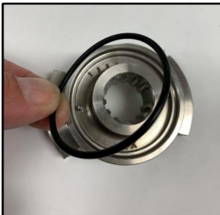
**Abbildung 72 - Montage des Dichtungs-O-Rings**
