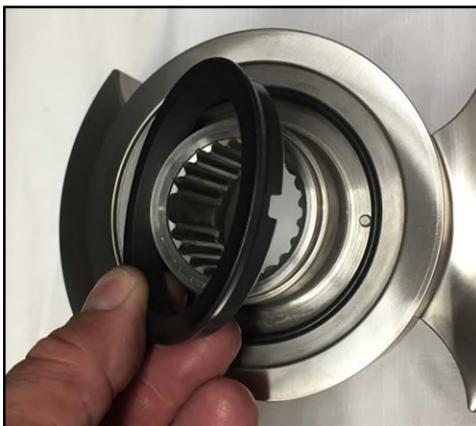
**Abbildung 215 - Montage der Rotationsdichtung**
