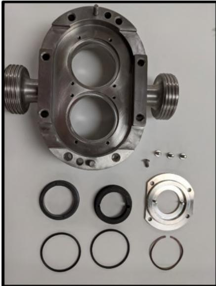
**Abbildung 61 - Einfach wirkende Gleitringdichtung (abgebildet ist 006U3)**
