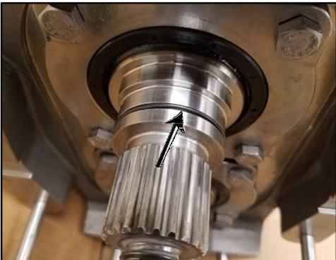
Abbildung 239 - Montierter O-Ring
