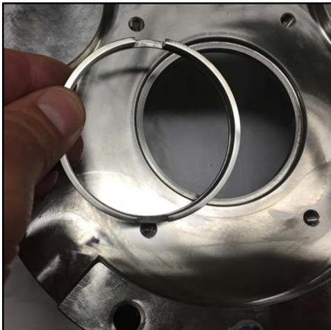
**Abbildung 159 - Montage des Wellenrings**
