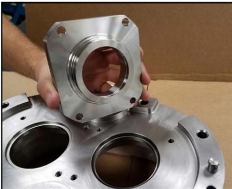
**Abbildung 234 - Fluchten der Schraubenbohrungen**
