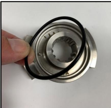
**Abbildung 114 - Montage des Dichtungs-O-Rings**
