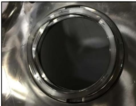
**Abbildung 134 - Montierte Wellenfeder**
