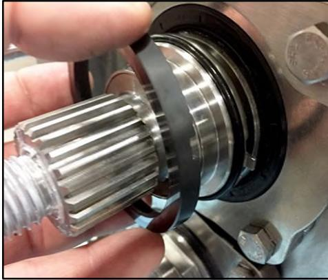
**Abbildung 144 - Ausbau der spülseitigen Rotationsdichtung**
