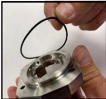
**Abbildung 92 Montieren Sie den Dichtungsgehäuse-O-Ring**
