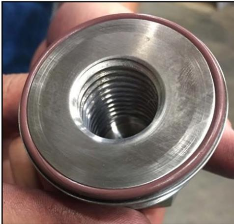
**Abbildung 258 - Montierter O-Ring**
