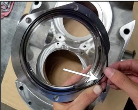
**Abbildung 187 - Montage des Dichtungsgehäuse-O-Rings**
