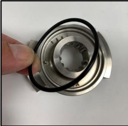
*Abbildung 42 - Abnehmen des Dichtungs-O-Rings*
