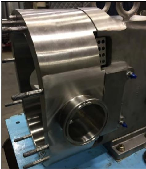
Abbildung 206 - Montiertes Pumpengehäuse
