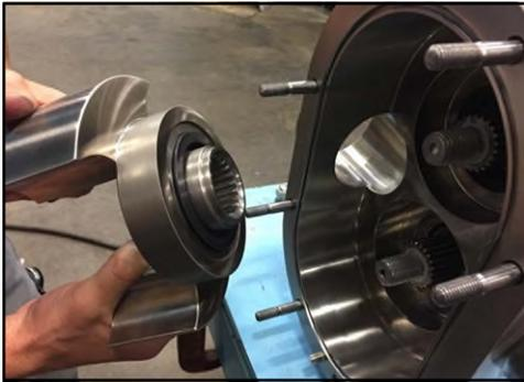
Abbildung 255 - Den Rotor auf die Welle drücken
