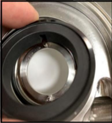
**Abbildung 70 - Montage des Leittrings**
