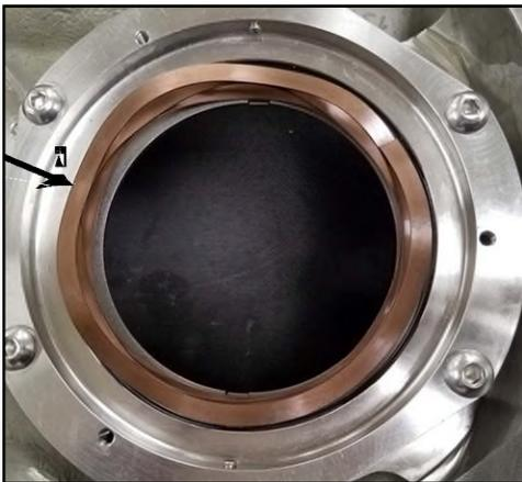
**Abbildung 193 - Montierte Wellenfeder**
