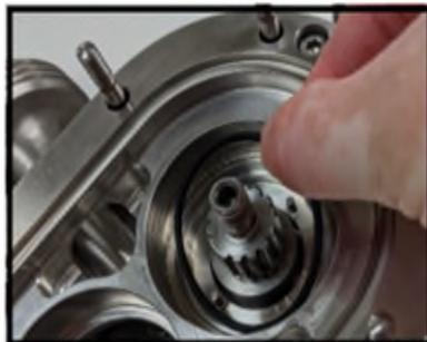
**Abbildung 68 - Montage des Leitring-O-Rings**
