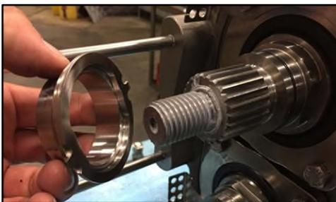
**Abbildung 199 - Montierter Einstellring**
