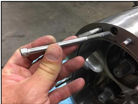
**Abbildung 245 - Montieren Sie die Gehäusebefestigungsschrauben**
