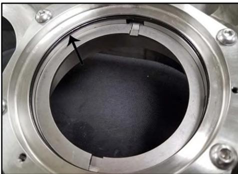
**Abbildung 192 - Lage des Dichtungs-O-Rings**
