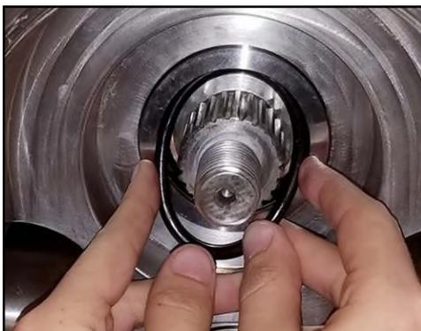
**Abbildung 246 - Montage des Dichtungs-O-Rings**
