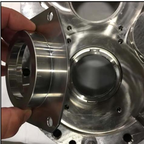
**Abbildung 123 - Ausbauen des Dichtungsgehäuses**
