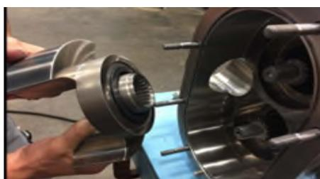
Abbildung 40 - Abnehmen des Rotors
