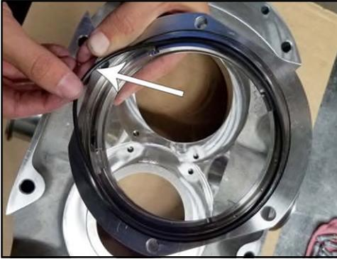
**Abbildung 155 - Abnehmen des Dichtungsgehäuse-O-Rings**
