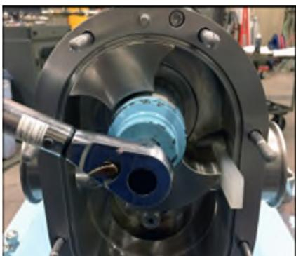
Abbildung 38 - Abnehmen der Rotormutter
