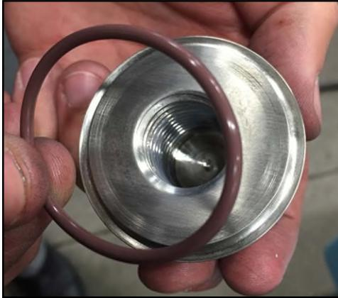
**Abbildung 257 - Montage des O-Rings**
