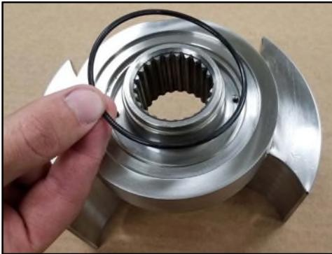
**Abbildung 247 - Montage des O-Rings vor der Manschette**
