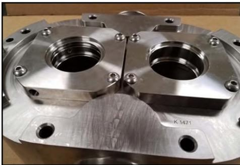
Abbildung 237 - Montiertes Dichtungsgehäuse
