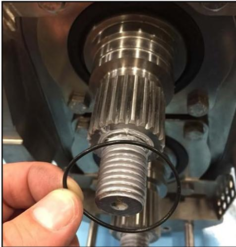
**Abbildung 177 - Montage des O-Rings**
