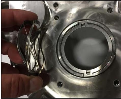
Abbildung 125 - Entfernen der Wellenfeder
