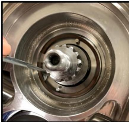
Abbildung 56 - Abnehmen der Wellenfeder des Leittrings
