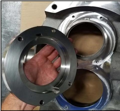
Abbildung 141 - Montage des Dichtungsgehäuses
