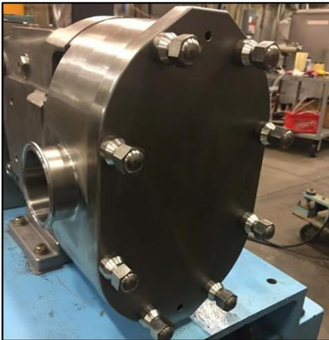
Abbildung 266 - Montiertes Pumpengehäuse
