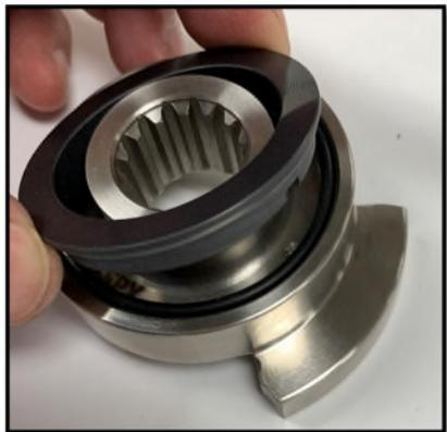
**Abbildung 51 - Montage der Rotationsdichtung**
