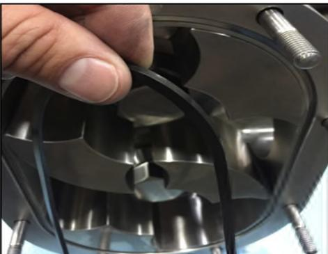
Abbildung 37 - Herausnehmen der Deckeldichtung
