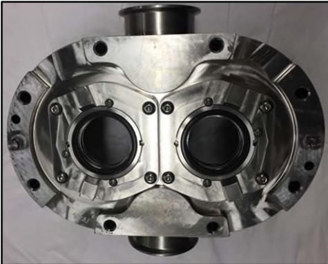
**Abbildung 175 - Montierte Dichtungen**
