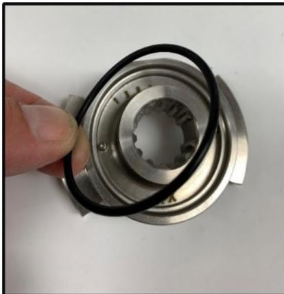
**Abbildung 50 - Montage des Dichtungs-O-Rings**
