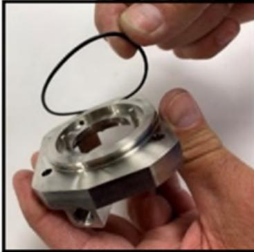
**Abbildung 90 - Abnehmen des Dichtungsgehäuse-O-Rings**
