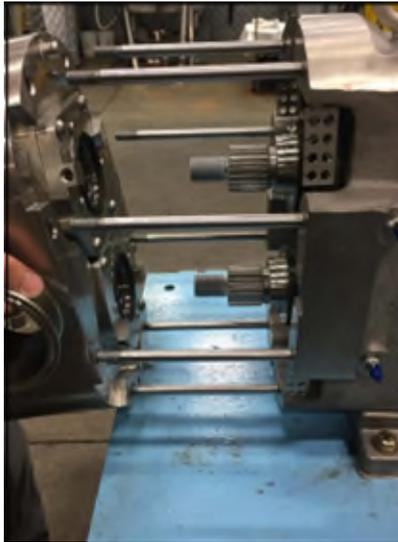
**Abbildung 65 - Montage des Pumpengehäuses**
