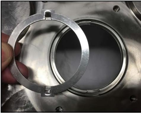
**Abbildung 161 - Montage des Antriebsrings**
