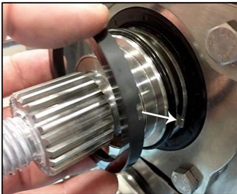
**Abbildung 203 - Montage der spülseitigen Rotationsdichtung**
