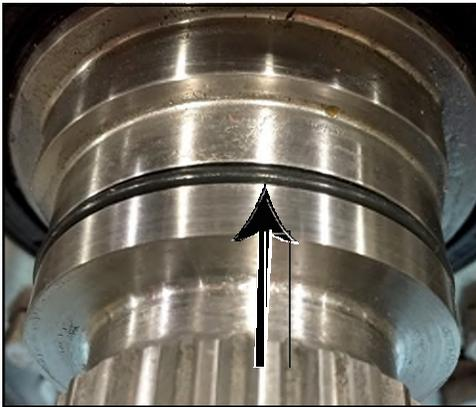
**Abbildung 198 - Montierter O-Ring**
