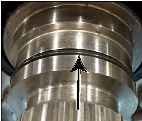
**Abbildung 178 - Montierter O-Ring**
