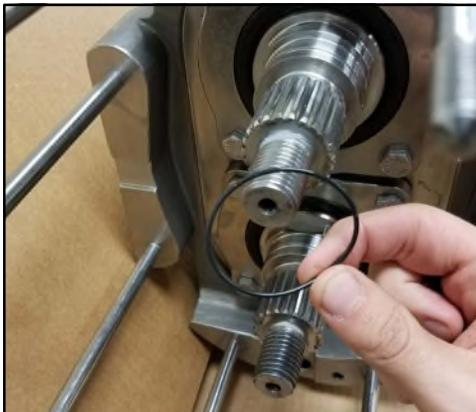
Abbildung 238 - Schmieren und montieren Sie den O-Ring
