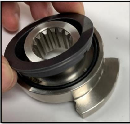
6. Installieren Sie die Rotationsdichtung und achten Sie darauf, dass die Aussparungen ausgerichtet sind.
