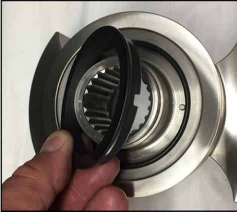
**Abbildung 116 - Ausbau der Rotationsdichtung**
