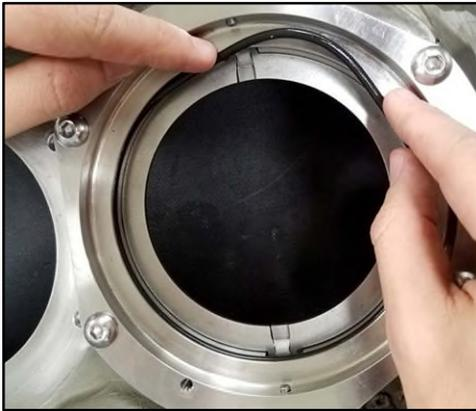
**Abbildung 191 - Montage des Dichtungs-O-Rings**
