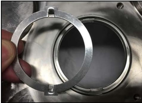
**Abbildung 131 - Montage des Antriebsrings**
