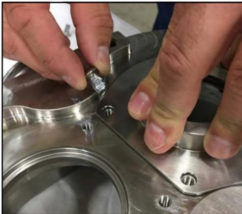
Abbildung 136 - Montage der Dichtungsgehäuseschrauben
