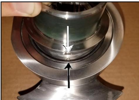
**Abbildung 249 - Aussparung und Zapfen fluchten**
