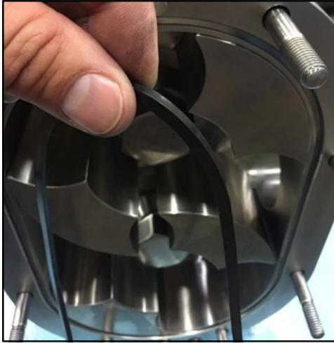
Abbildung 262 - Montage der Deckeldichtung
