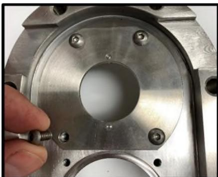
**Abbildung 63 - Montage der Dichtungsgehäuseschrauben**
