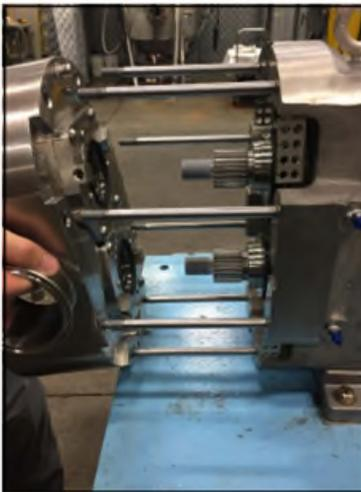
**Abbildung 107 – Montage des Pumpengehäuses**
