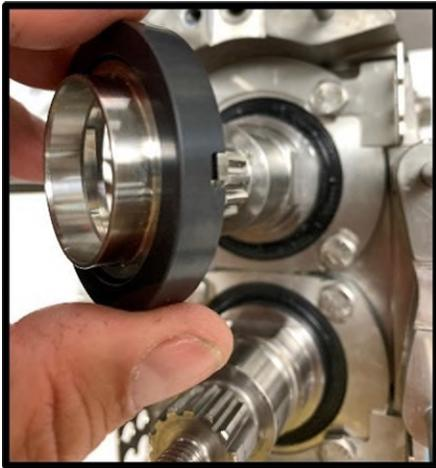
**Abbildung 105 - Montage der spülseitigen Rotationsdichtung auf der Welle**
