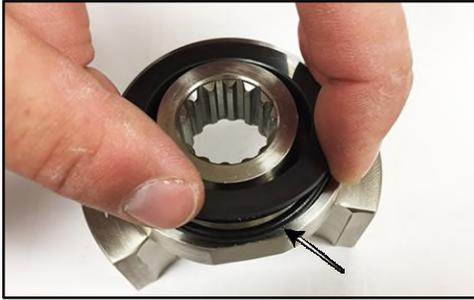
Abbildung 217 - Gequetschter Dichtungs-O-Ring
