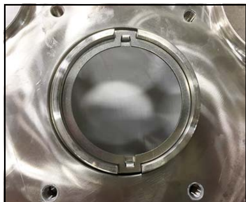
Figur 54 - monteret drivring (130-U3 og mindre)
