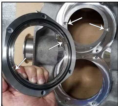
Figur 110 - Tætningshusets O-ring monteret
