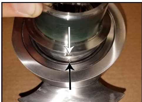
Figur 171 - Placer rille og stift på linje
