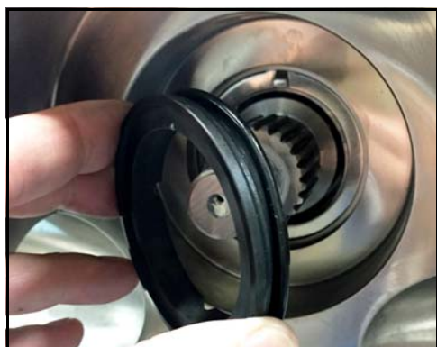
Figur 40 - Fjern stationær tætning
