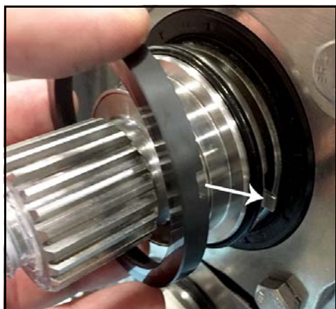
Figur 105 - Monter roterende skyllsidetætning
