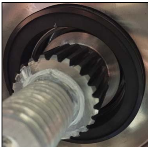
Figur 134 - Monteret stationær tætning
