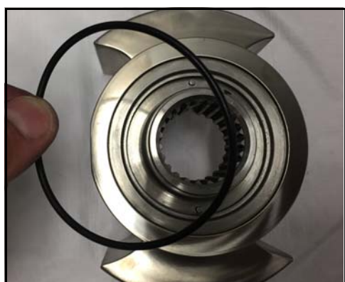
Figur 39 - Fjern tætnings O-ring
