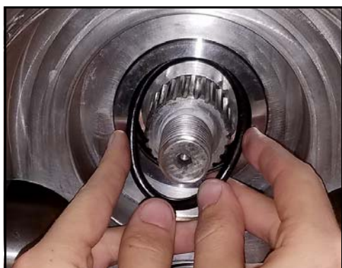
Figur 168 - Montér tætnings O-ring
