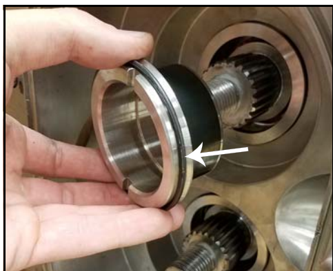
Figur 142 - Fjern muffe, O-ring
