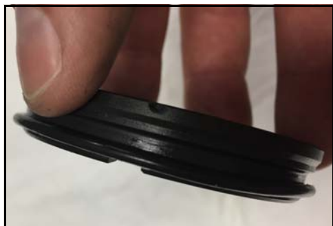
Figur 131 - Tætnings O-ring monteret
