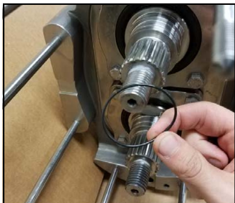
Figur 160 - Smør og monter O-ring
