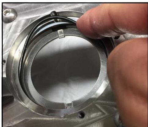
Figur 90 - Montér tætnings O-ring
