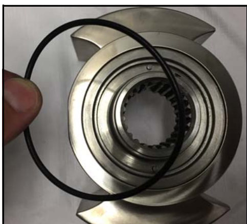
Figur 135 - Montér tætningens O-ring
