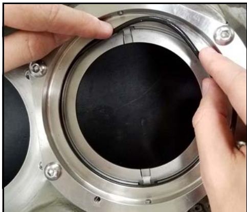
Figur 113 - Montér tætnings O-ring
