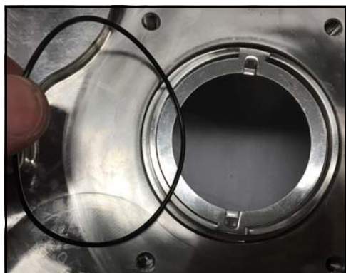
Figur 85 - Monterer tætningshusets O-ring
