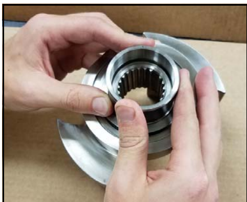
Figur 172 - Tryk muffen på plads
