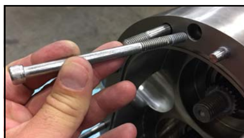
Figur 147 - Fjern pumpehusets fastspændingsskruer
