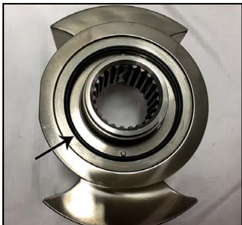
Figur 136 - Tætningens O-ring monteret
