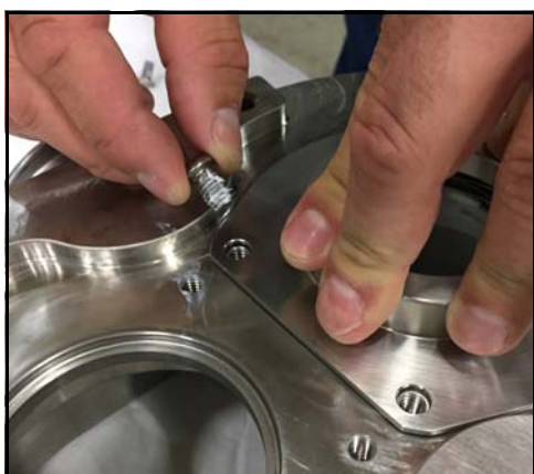
Figur 58 - Monter tætningshusets bolte
