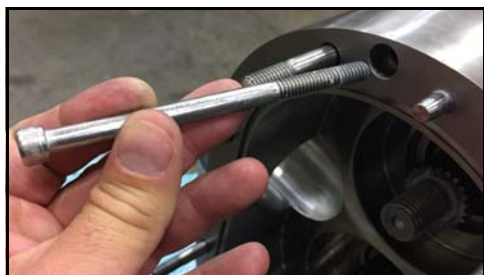
Figur 42 - Fjern pumpehusets fastspændingsskruer
