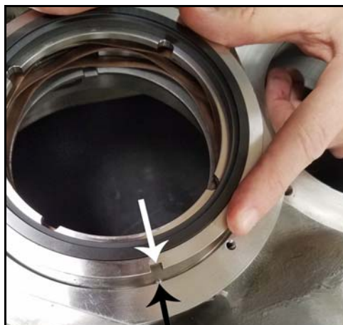
Figur 116 - Montér stationær skyllesidetætning
