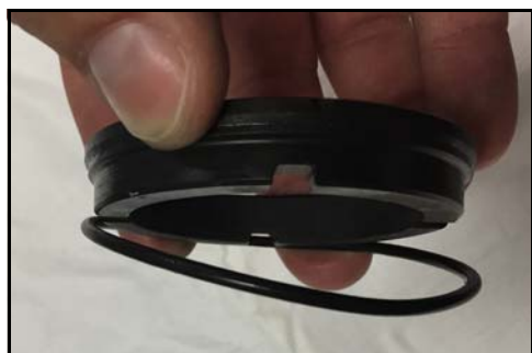
Figur 41 - Stationær tætnings O-ring
