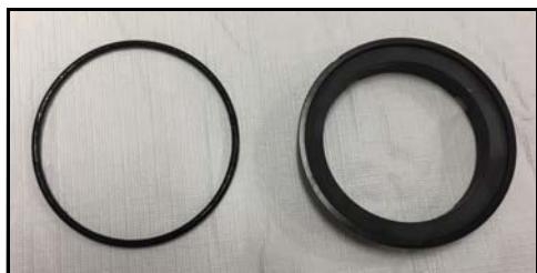
Figur 130 - Montér tætnings O-ring
