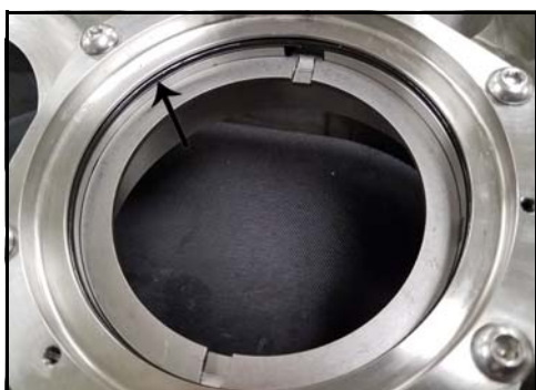
Figur 114 - Placering af tætnings O-ring
