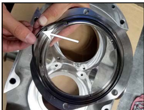
Figur 77 - Fjern tætningshusets O-ring
