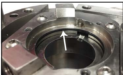
Figur 73 - Placering af tætnings O-ring
