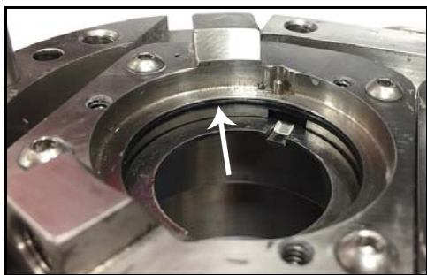
Figur 91 - Placering af tætnings O-ring
