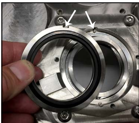
Figur 94 - Montér stationær skyllesidetætning
