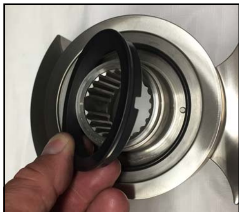
Figur 38 - Fjern roterende tætning
