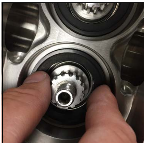
Figur 133 - Tryk på den stationære tætning
