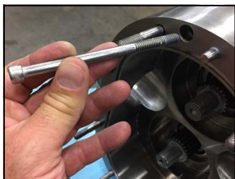
Figur 129 - Montér pumpehusets fastspændingsskruer
