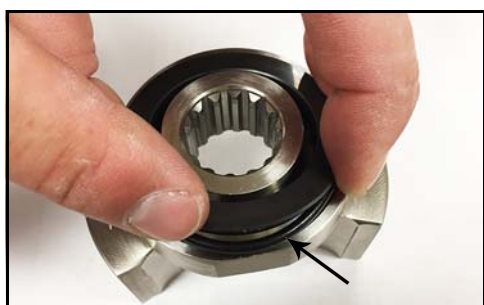
Figur 139 - Tætningens O-ring klemt
