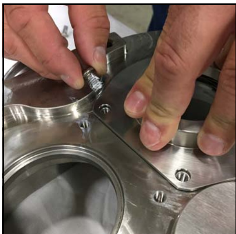
Figur 44 - Fjern tætningshusets bolte
