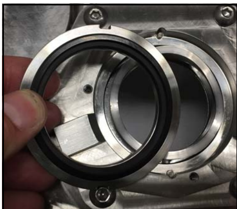
Figur 71 - Fjern stationær tætning
