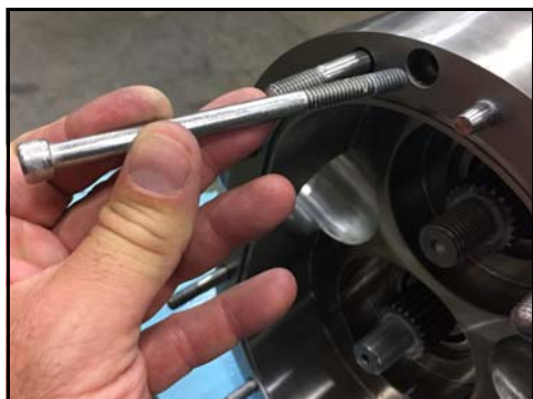
Figur 167 - Montér pumpehusets fastspændingsskruer
