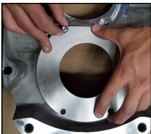
Figur 64 - Montér tætningshusets bolte
