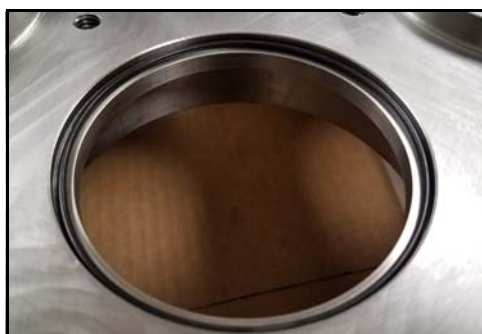
Figur 155 - Tætningshusets O-ring monteret
