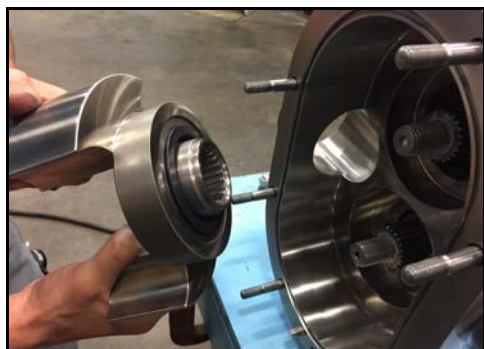
Figur 177 - Skub rotoren på akslen
