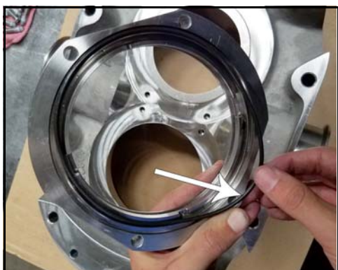
Figur 109 - Montér tætningshusets O-ring
