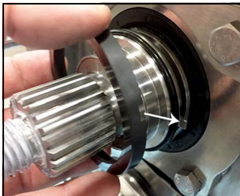
Figur 125 - Monterer roterende skyllsidetætning
