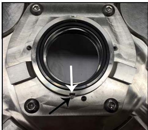
Figur 95 - Monteret stationær skyllesidetætning
