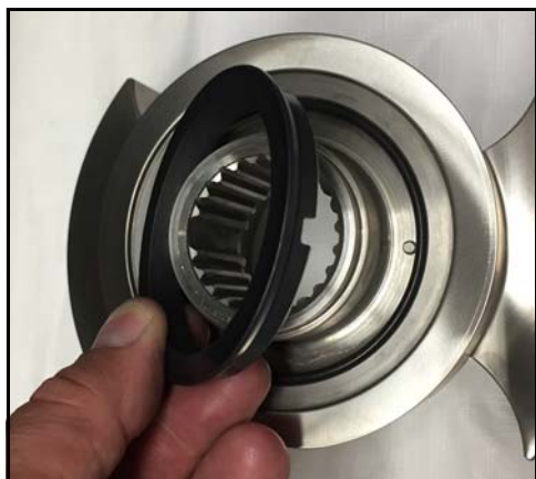
Figur 137 - Montér roterende tætning
