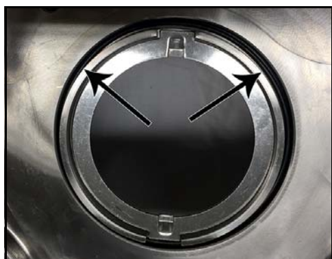
Figur 86 - Tætningshusets O-ring monteret
