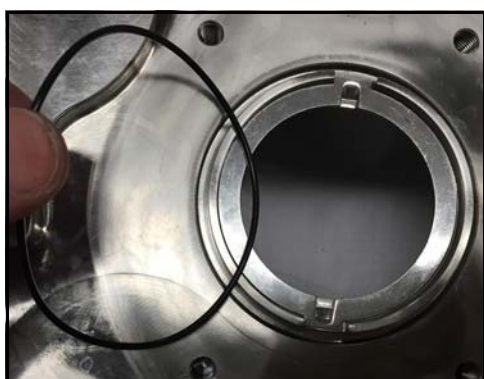
Figur 76 - Fjern tætningshusets O-ring
