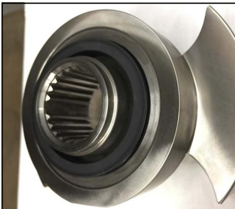
**Figure 216 - Joint rotatif installé**
