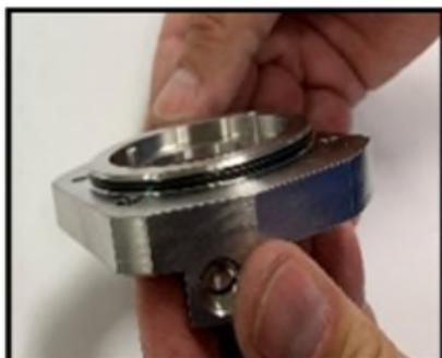
**Figure 92 Installation du joint torique du logement de la garniture**
