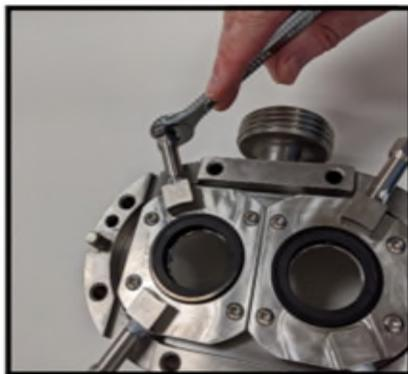
**Figure 101** Installation des extensions de l'orifice de rinçage
