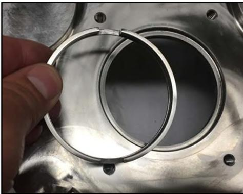
**Figure 129 - Installation de la bague d'arbre**
