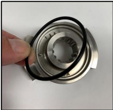
**Figure 50** *Installation du joint torique*
