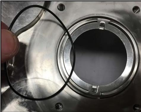
**Figure 163 - Installation du joint torique du logement de garniture**
