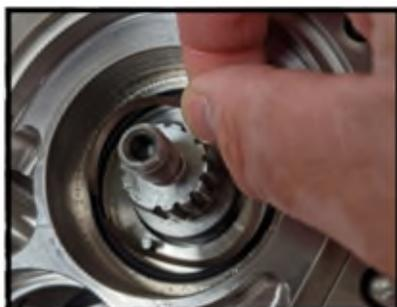
**Figure 69 Installation du ressort ondulé fixe**
