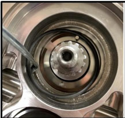
**Figure 77** Retrait du joint torique de la garniture fixe
