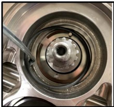
**Figure 55** Retrait du joint torique de la garniture fixe
