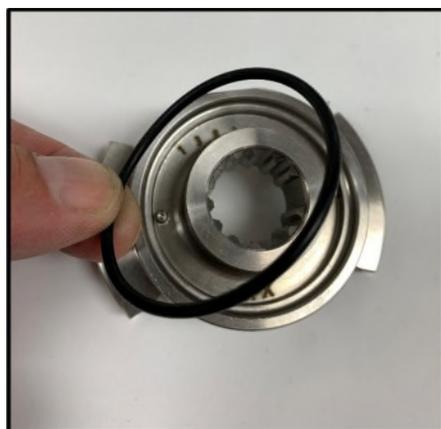
**Figure 114 Installation du joint torique**
