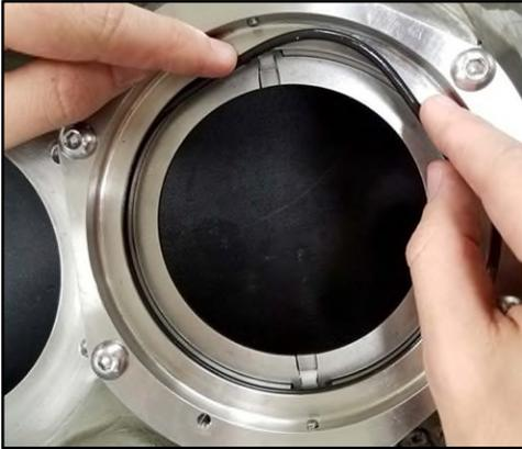
**Figure 191 - Installation du joint torique**
