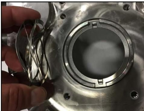
**Figure 133 - Installation du ressort ondulé**
