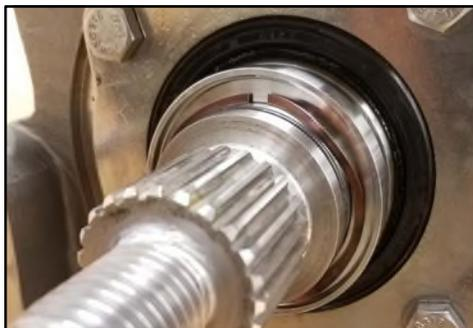
**Figure 242** - Installation du ressort ondulé
