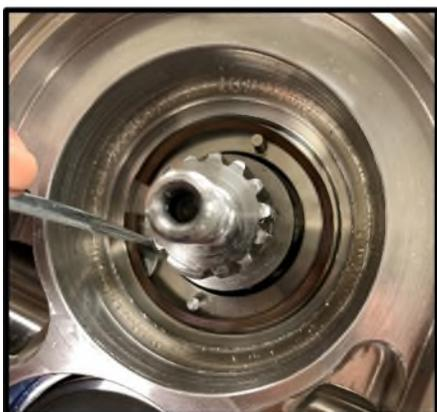
**Figure 45** Retrait du ressort ondulé de la garniture fixe
