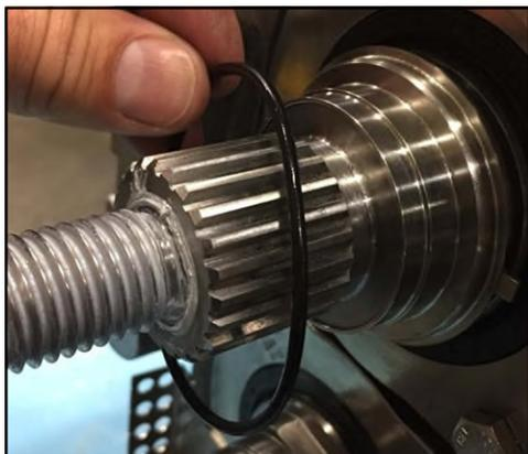
**Figure 181 - Installation du joint torique**
