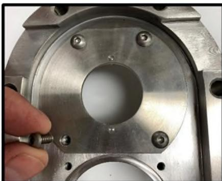
**Figure 63** Installation des boulons du logement de garniture
