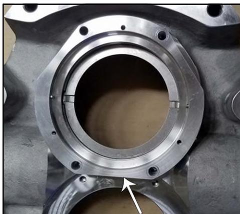
**Figure 189 - Logement de garniture sur place**
