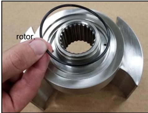
**Figure 247 - Installation du joint torique avant du manchon**
