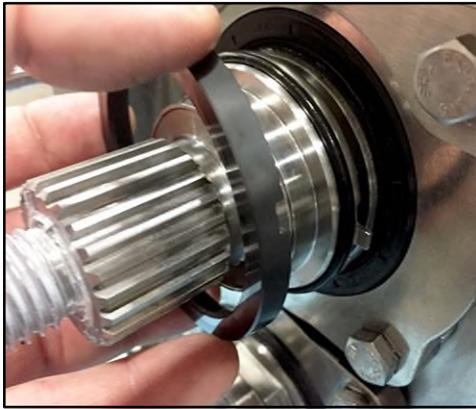
**Figure 144 - Retrait du joint rotatif côté affleurant**
