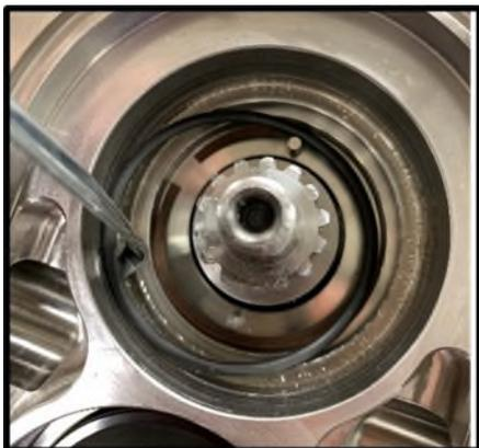
**Figure 44** Retrait du joint torique de la garniture fixe
