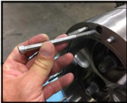
**Figure 109 - Installation des vis de maintien du corps**
