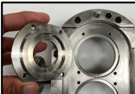
**Figure 62** Installation du logement de garniture
