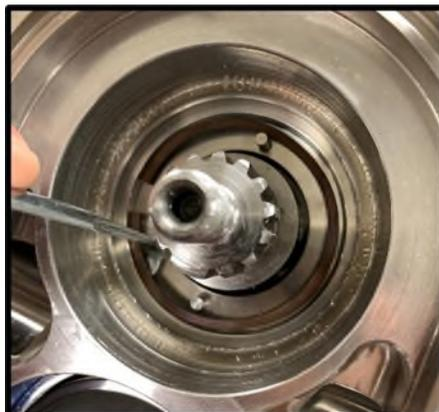
**Figure 56** Retrait du ressort ondulé de la garniture fixe
