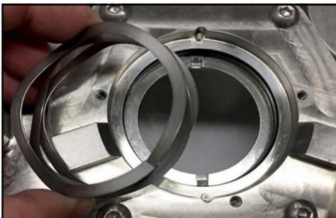
**Figure 170 - Installation du ressort ondulé**
