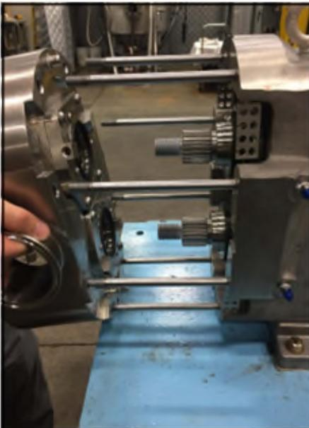
**Figure 107– Installation du corps de la pompe**
