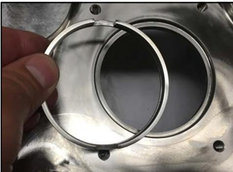
**Figure 157 - Retrait de la bague d'arbre**
