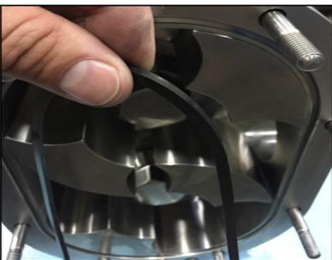
**Figure 37 - Retrait du joint d'étanchéité du couvercle**
