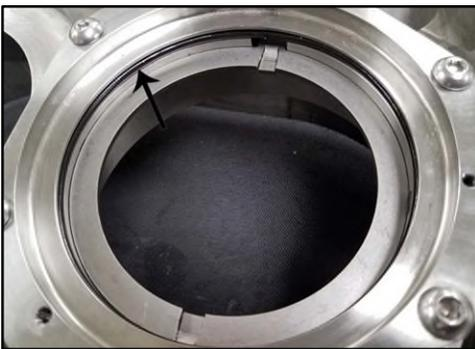
**Figure 192 - Emplacement du joint torique du joint**
