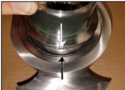
**Figure 249 - Alignement de la rainure et de la goupille**
