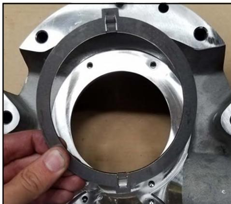
**Figure 138 - Installation de la bague d'entraînement**
