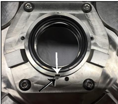
**Figure 173 - Garniture fixe côté affleurant installée**
