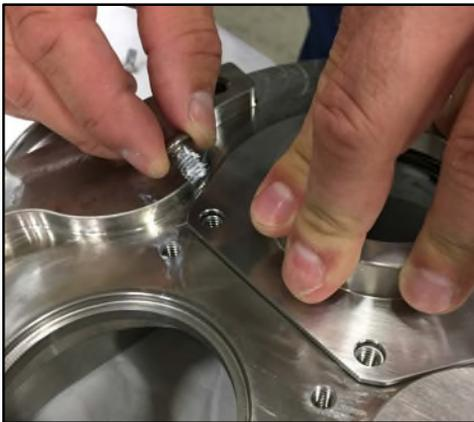
**Figure 136 - Installation des boulons du logement de garniture**
