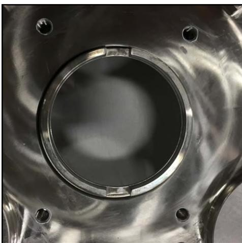
**Figure 160 - Bague d'arbre installée**
