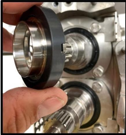
**Figure 105** *Installation du joint rotatif affleurant sur l'arbre*
