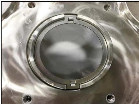
**Figure 132 - Installation de la bague d'entraînement (134- U3 et inférieur)**
