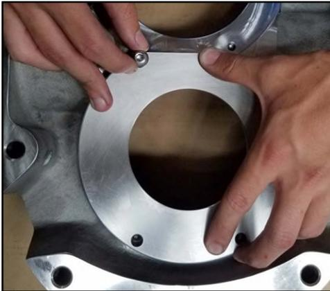
**Figure 142 - Installation des boulons du logement de garniture**
