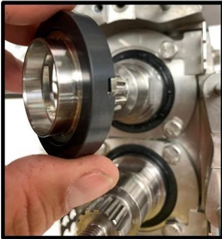
**Figure 81** Retrait du joint rotatif côté affleurant
