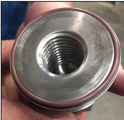
**Figure 258 -- Joint torique installé**
