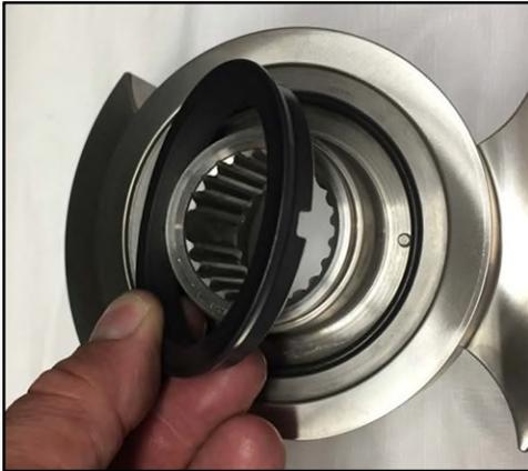
*Figure 116 Retrait du joint rotatif*
