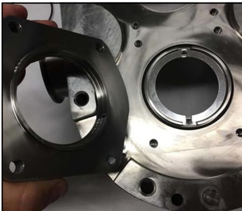
**Figure 165 - Installation du logement de garniture**
