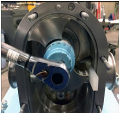
Figure 38 - Retrait des écrous du rotor
