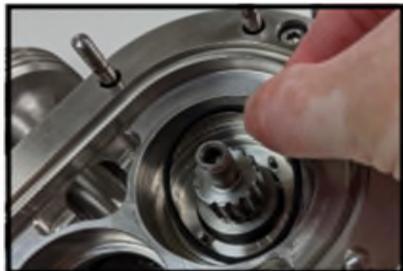
**Figure 110 Installation de la garniture d'étanchéité fixe**
