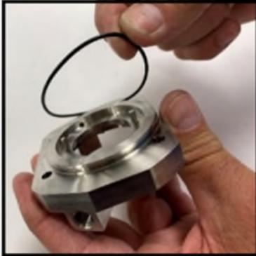
**Figure 90 Retrait du joint torique du logement de la garniture**
