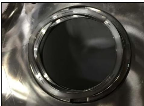
**Figure 134 - Ressort ondulé installé**
