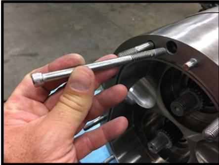
Figure 79 Retrait des vis de retenue du corps
