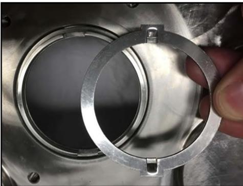
**Figure 156 - Retrait de la bague d'entraînement**
