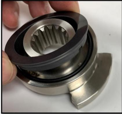
*Figure 52 Retrait du joint rotatif*
