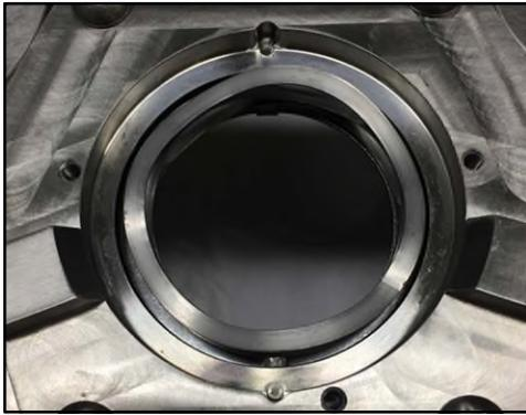
**Figure 171 - Ressort ondulé installé**
