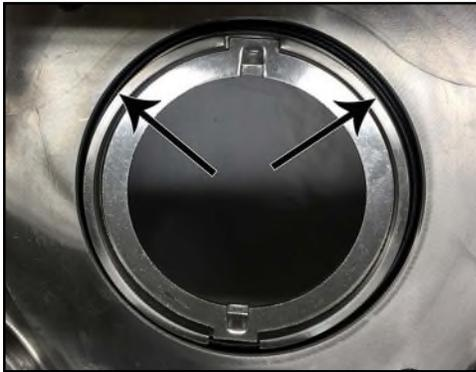
**Figure 164 - Joint torique du logement de garniture installé**
