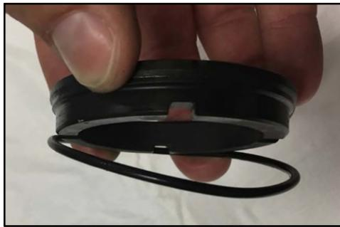
**Figure 119** Retrait du joint torique de la garniture fixe
