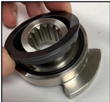
*Figure 41 Retrait du joint rotatif*
