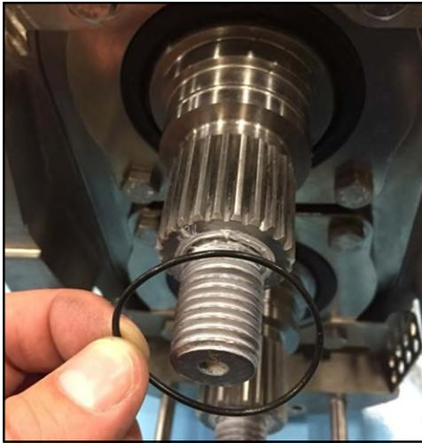
**Figure 177 - Installation du joint torique**
