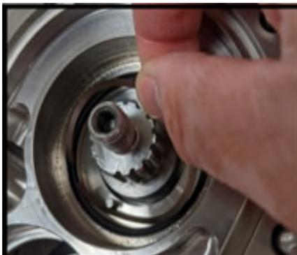
**Figure 47** Installation du ressort ondulé fixe
