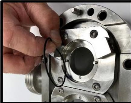
**Figure 97 Retrait du joint torique de la garniture fixe**
