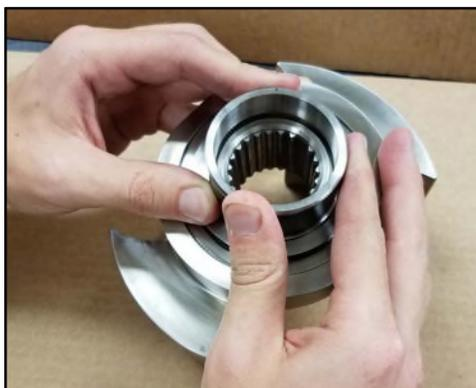
**Figure 250 - Installation du manchon par pression**
