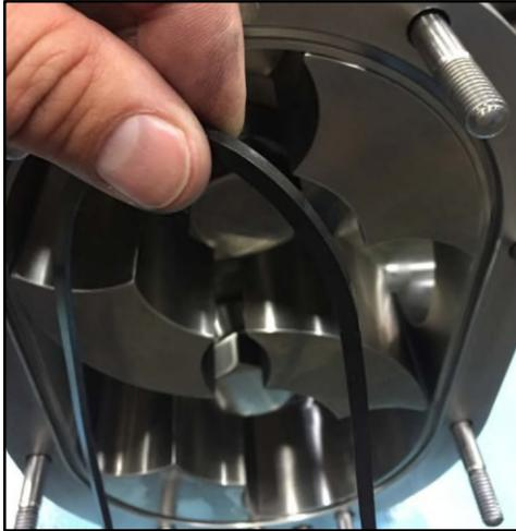
**Figure 263 - Installation de la garniture de couverture**
