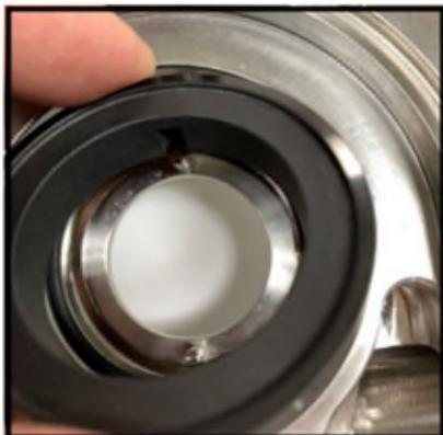
**Figure 112 Installation de la garniture fixe**
