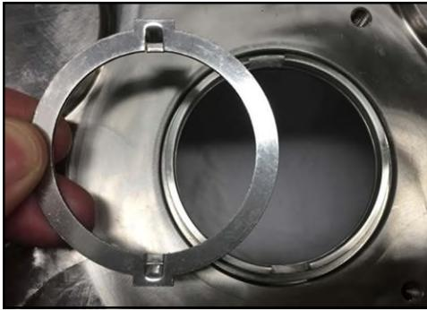
**Figure 131 - Installation de la bague d'entraînement**
