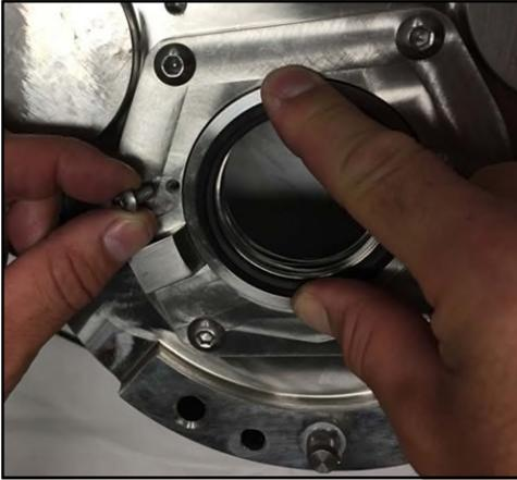
**Figure 148 - Retrait des boulons de maintien du joint**
