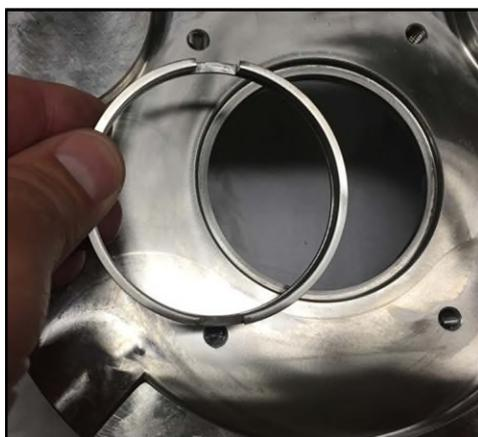
**Figure 127 - Retrait de la bague d'arbre**
