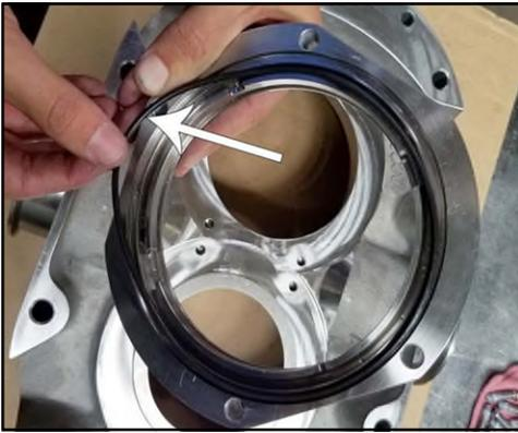
**Figure 155 - Retrait du joint torique du logement de garniture**
