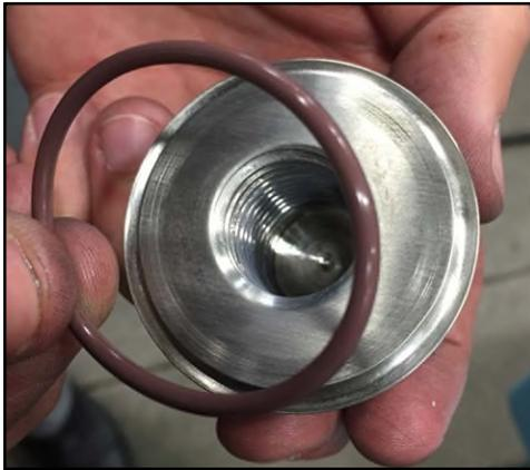
**Figure 257 - Installation du joint torique**
