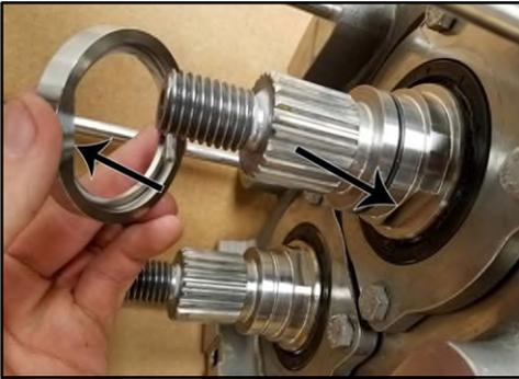
**Figure 240** Installation du siège de garniture
