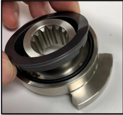
**Figure 115 Installation du joint rotatif**
