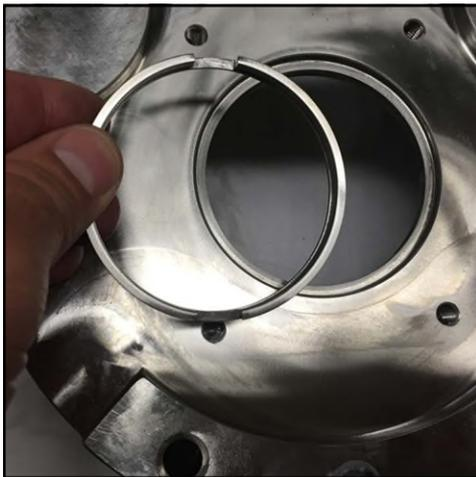
**Figure 159 - Installation de la bague d'arbre**
