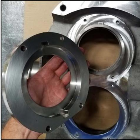
**Figure 141 - Installation du logement de garniture**
