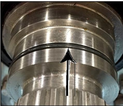
**Figure 198 -- Joint torique installé**
