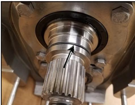
Figure 239 -- Joint torique installé
