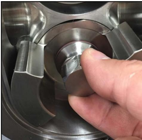
**Figure 259 - Installation de l'écrou du rotor**
