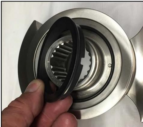
**Figure 215 - Installation du joint rotatif**
