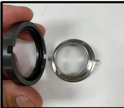
**Figure 104 Installation du joint rotatif côté affleurant**
