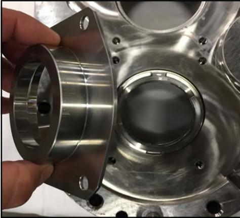
**Figure 135 - Installation du logement de garniture**
