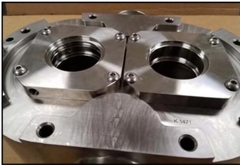
Figure 237 - Logements de garniture installés
