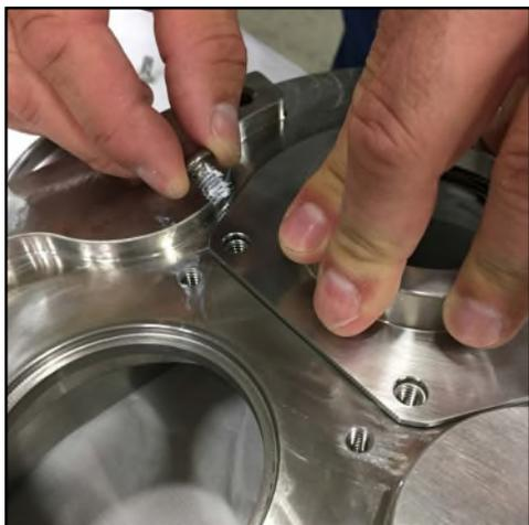
**Figure 122 Retrait des boulons du logement de garniture**
