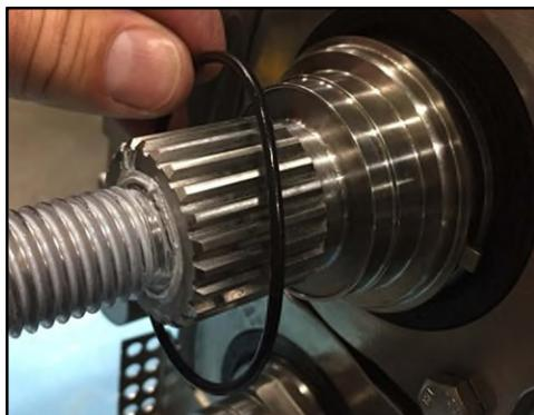
**Figure 201 - Installation du joint torique**
