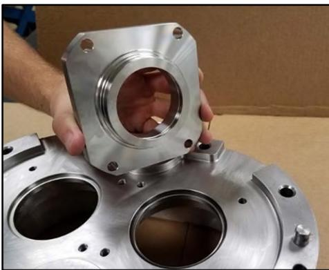
**Figure 234 - Alignement des trous de boulons**
