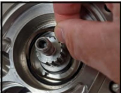
**Figure 111 Installation du ressort ondulé fixe**
