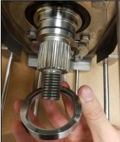
**Figure 231 Retrait du siège du joint**
