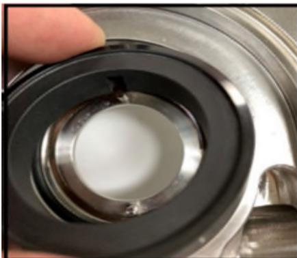
**Figure 48** Installation de la garniture fixe
