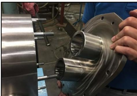
**Figure 264 - Installation du couvercle**
