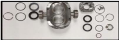
**Figure 91 Garniture mécanique double**
