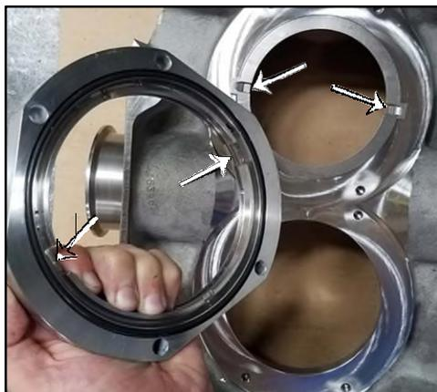
**Figure 188 - Joint torique du logement de garniture installé**
