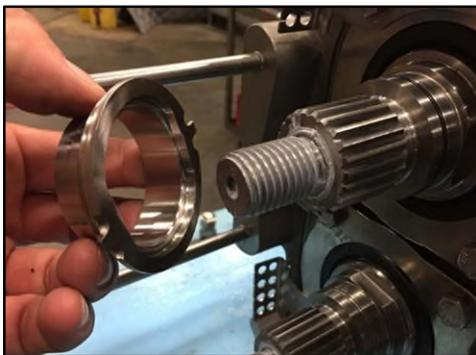
**Figure 146 - Retrait de la bague de réglage**
