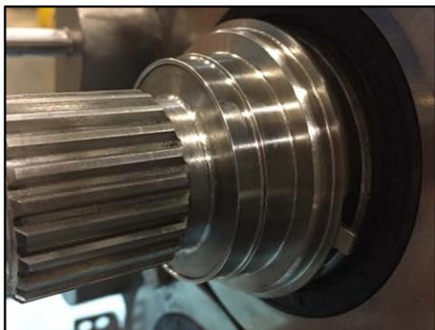
**Figure 180 - Bague de réglage installée**
