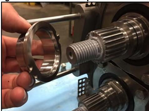
**Figure 179 - Installation de la bague de réglage**
