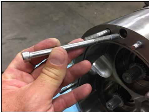
**Figure 245 - Installation des vis de retenue du corps**
