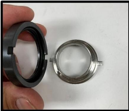
**Figure 82** Retrait du joint rotatif côté affleurant et du joint torique
