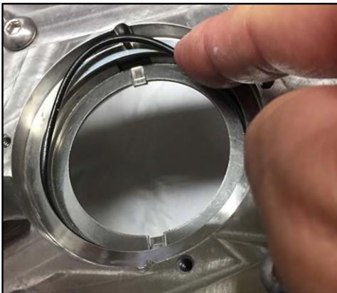
**Figure 168 - Installation du joint torique**
