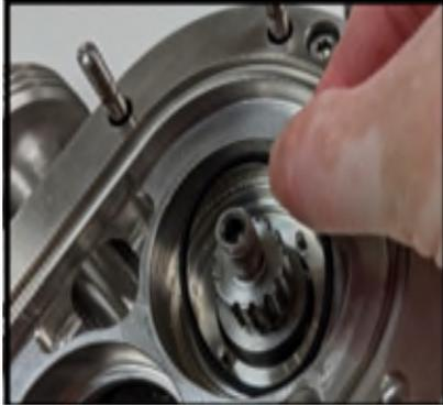
**Figure 46** Installation de la garniture d'étanchéité fixe
