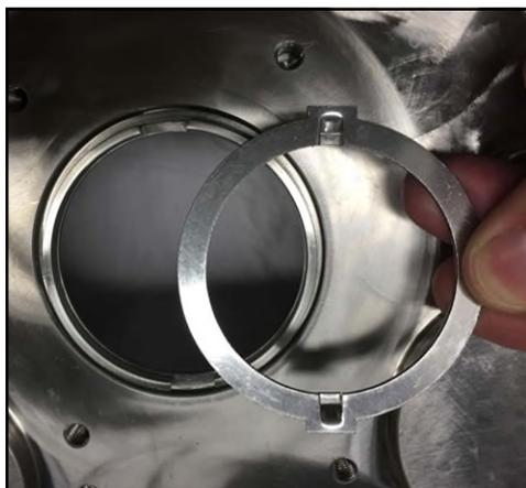
**Figure 126 - Retrait de la bague d'entraînement**
