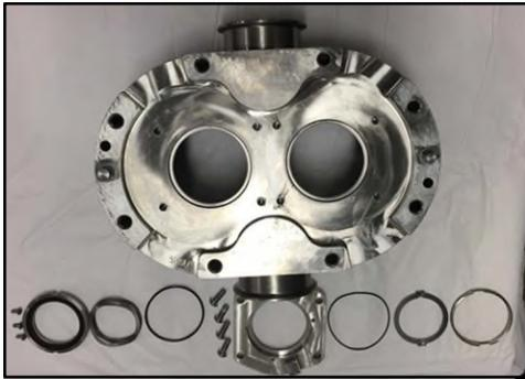
**Figure 158 - Garniture mécanique double (040-U3 représenté)**
