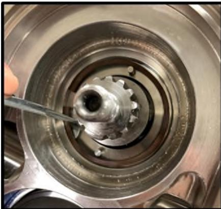
**Figure 78** Retrait du joint fixe ressort ondulé de la garniture fixe
