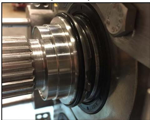
**Figure 182 -- Joint torique installé**
