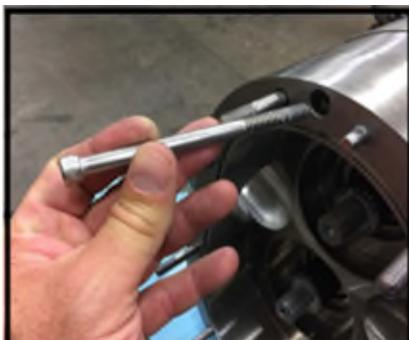
**Figure 57** Retrait des vis de retenue du corps
