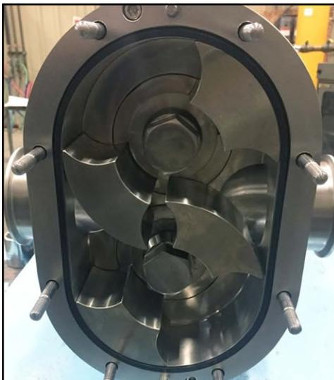
**Figure 263 - Garniture de couverture installée**
