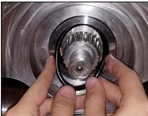
**Figure 246 - Installation du joint torique**
