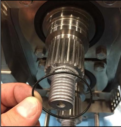
**Figure 197 - Installation du joint torique**
