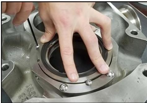
**Figure 195 - Installation des boulons de maintien du joint**
