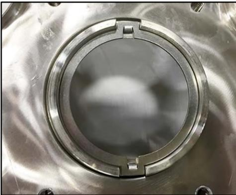
**Figure 162 - Bague d'entraînement installée**
