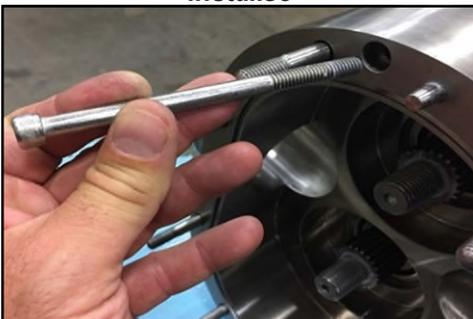
**Figure 207 - Installation des vis de maintien du corps**
