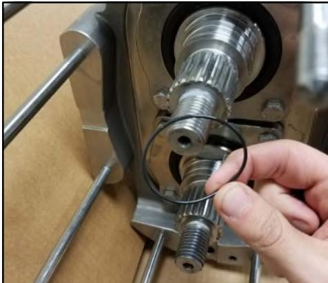
Figure 238 - Lubrification et installation du joint torique
