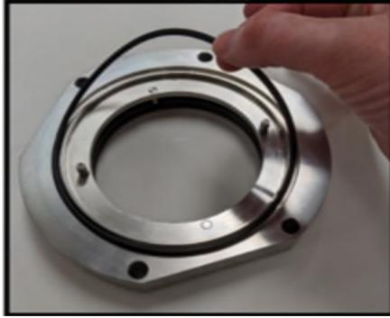
**Figure 93 Installation du joint torique logement de garniture**
