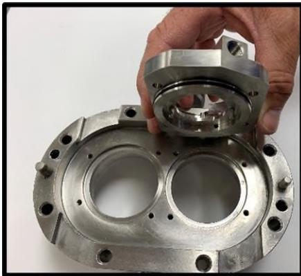
**Figure 94 Installation du logement de garniture**
