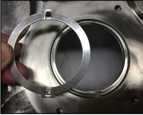
**Figure 161 - Installation de la bague d'entraînement**
