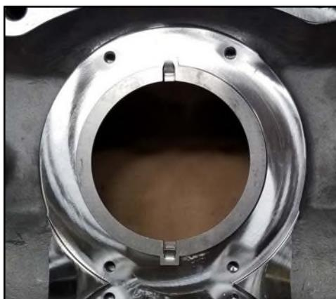
**Figure 139 - Bague d'entraînement installée**
