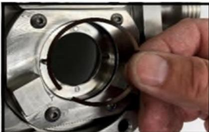
**Figure 98 Installation du ressort fixe de l'onde sela**
