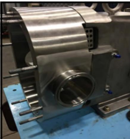
**Figure 108 - Corps de la pompe installée**
