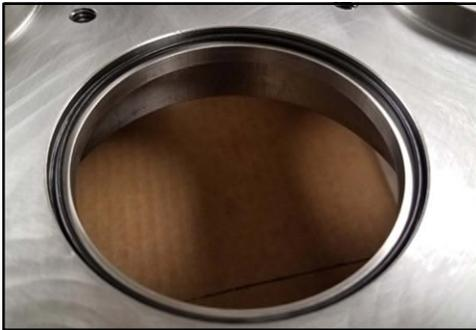
**Figure 233 - Joint torique du logement de garniture installé**
