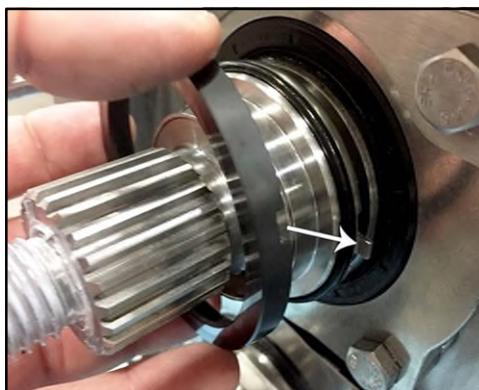
**Figure 203 - Installation du joint rotatif côté affleurant**
