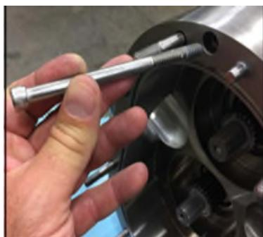
**Figure 67 - Installation des vis de retenue du corps**
