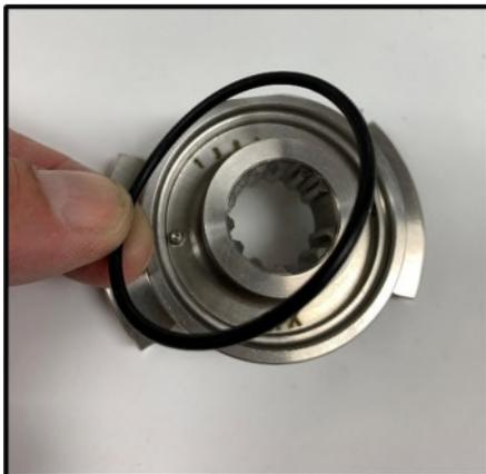
**Figure 72** Installation du joint torique
