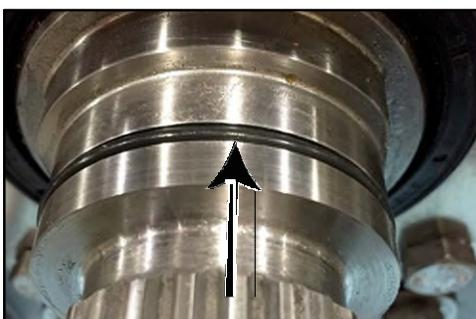
**Figure 147 - Joint torique de la bague de réglage**
