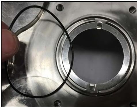
**Figure 154 - Retrait du joint torique du logement de garniture**
