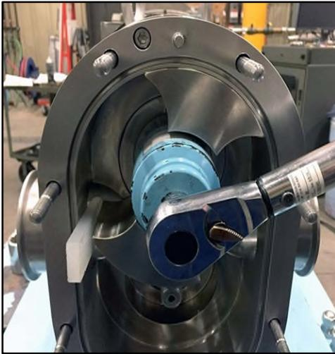
Figure 260 - Serrage de l'écrou du rotor
