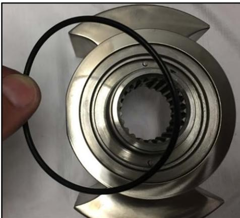
**Figure 213 - Installation du joint torique**
