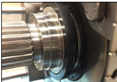
**Figure 204 - Joint rotatif installé**
