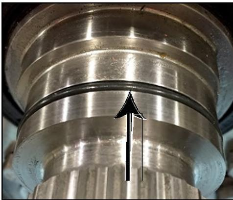
**Figure 178 -- Joint torique installé**
