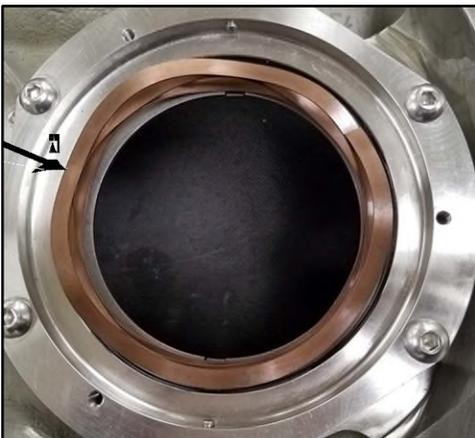
**Figure 193 - Ressort ondulé installé**
