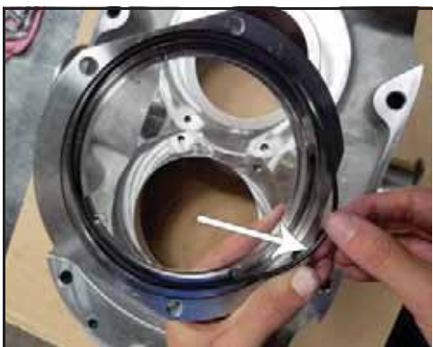
109. ábra – A tömítésház O-gyűrűjének behelyezése
