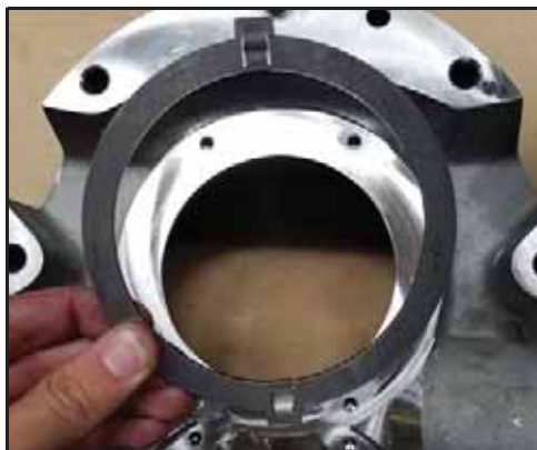
60. ábra – A hajtógyűrű felszerelése
