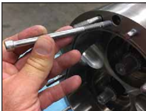
129. ábra – A házrögzítő csavarok beszerelése
