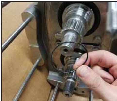
160. ábra – Az O-gyűrű megzsírozása és behelyezése
