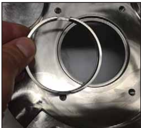
49. ábra – A tengelygyűrű eltávolítása
