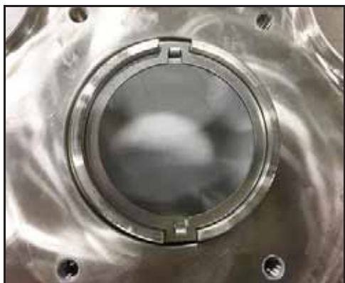
54. ábra – A hajtógyűrű a helyén van (130-U3 és kisebb modellek esetén)
