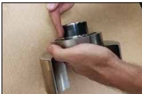
174. ábra – A tömítőhüvely megzsírozása
