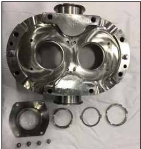
50. ábra – Egyszeres mechanikai tömítés (a képen a 040-U3 látható)
