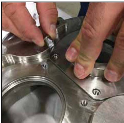
44. ábra – A tömítésházcsavarok eltávolítása
