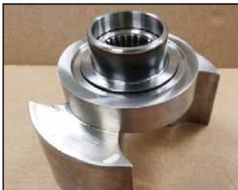
173. ábra – A tömítőhüvely a helyén van
