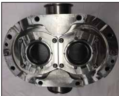
97. ábra – A tömítések a helyükön vannak
