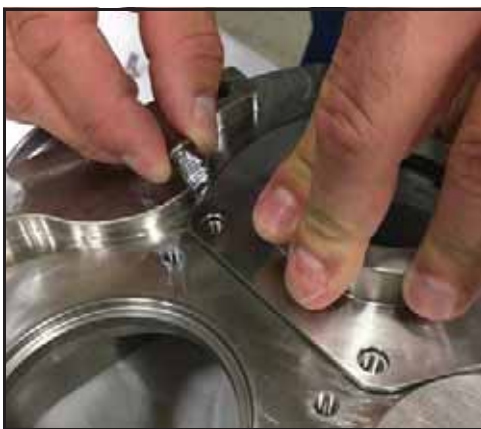
58. ábra – A tömítésházcsavarok beszerelése
