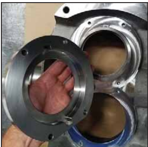
63. ábra – A tömítésház felszerelése
