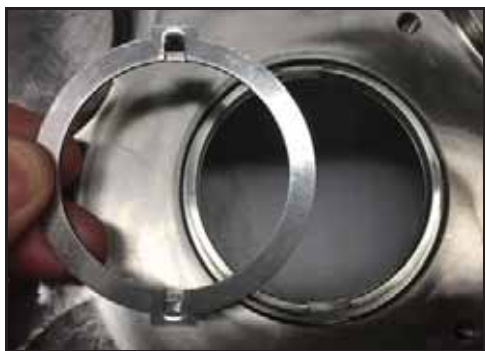
53. ábra – A hajtógyűrű felszerelése
