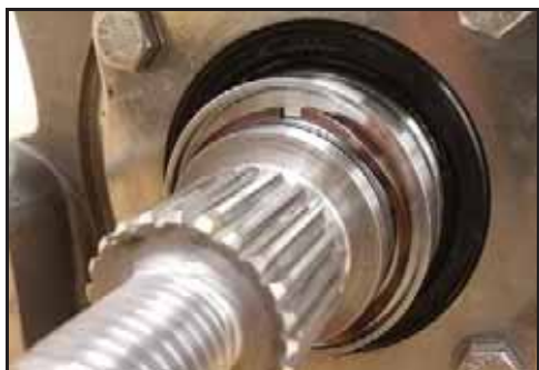
164. ábra – A hullámos rugó beszerelése
