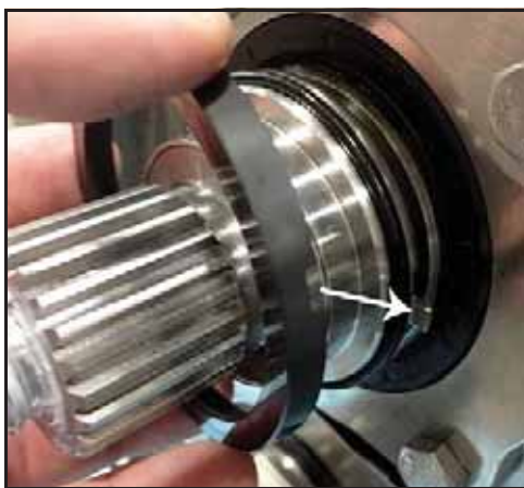
105. ábra – Az átmosás felőli oldal forgórésztömítésének behelyezése
