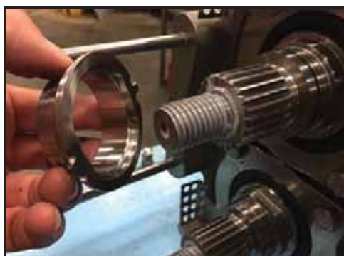
101. ábra – Az állítógyűrű felszerelése
