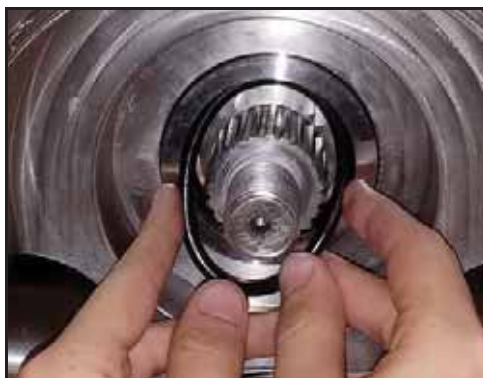
168. ábra – A tömítő O-gyűrű behelyezése
