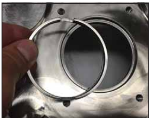
51. ábra – A tengelygyűrű behelyezése
