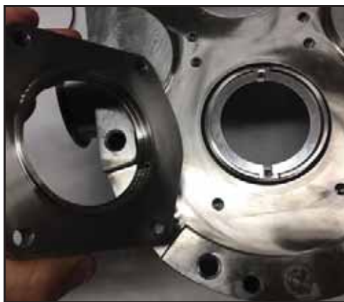
87. ábra – A tömítésház felszerelése
