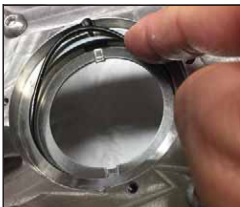
90. ábra – A tömítő O-gyűrű behelyezése
