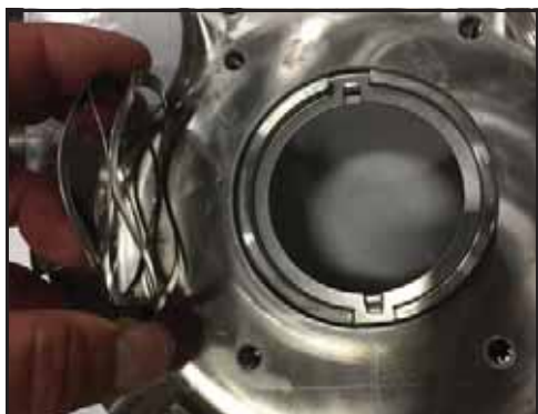
55. ábra – A hullámos rugó beszerelése
