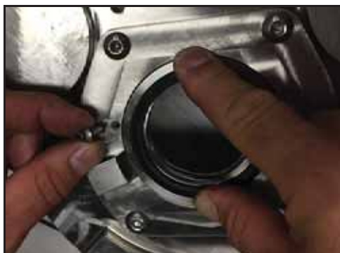
96. ábra – A tömítéstartó csavarok beszerelése
