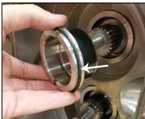
142. ábra – A hüvely és az O-gyűrű eltávolítása
