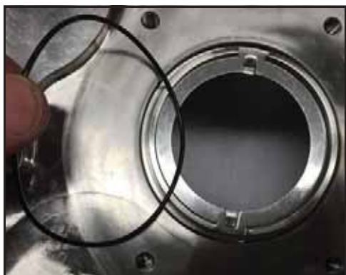
85. ábra – A tömítésház O-gyűrűjének behelyezése
