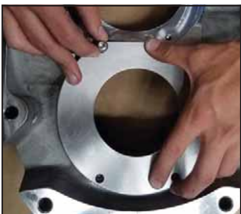
64. ábra – A tömítésházcsavarok beszerelése
