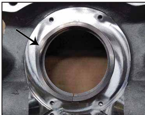
62. ábra – A hullámos rugó a helyén van
