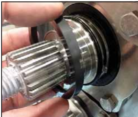
66. ábra – Az átmosás felőli oldal forgórész-tömítésének eltávolítása
