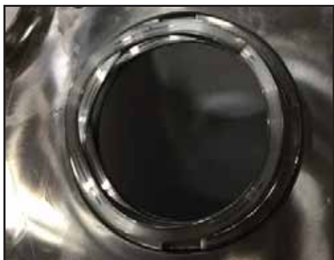
56. ábra – A hullámos rugó a helyén van
