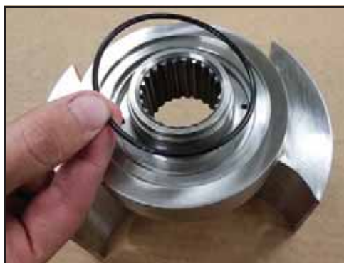
169. ábra – A hüvely elülső O-gyűrűjének behelyezése
