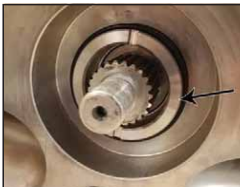
141. ábra – A rotor eltávolítása után a hüvely a helyén marad
