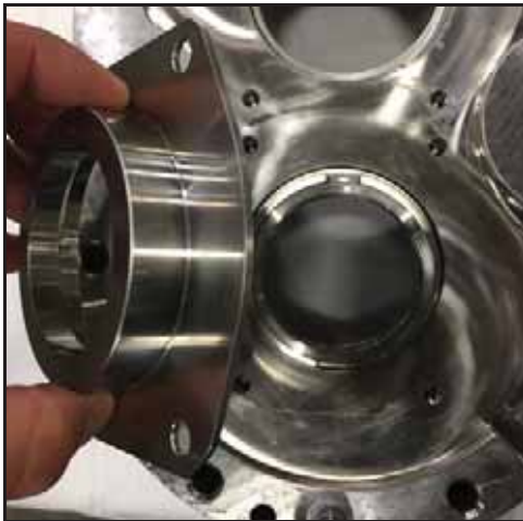
57. ábra – A tömítésház felszerelése
