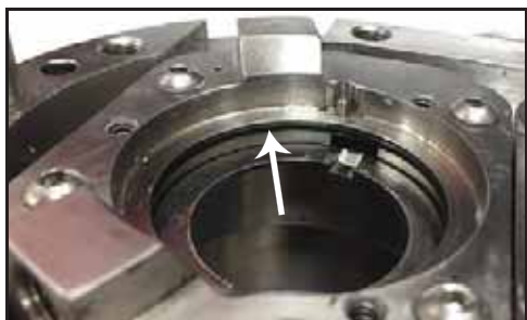
73. ábra – A tömítő O-gyűrű helye
