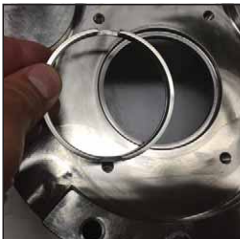
81. ábra – A tengelygyűrű behelyezése
