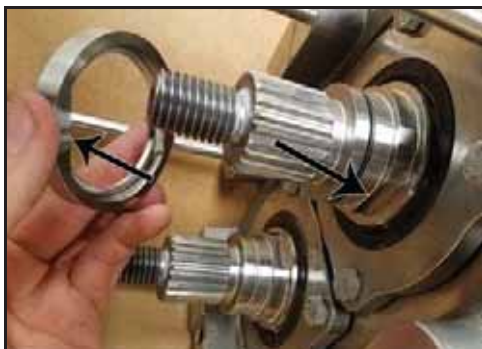
162. ábra – A tömítésfészek felhelyezése
