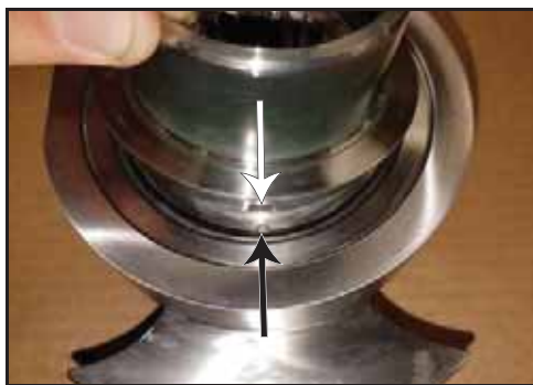
171. ábra – A bemetszés és a csap egymáshoz igazítása
