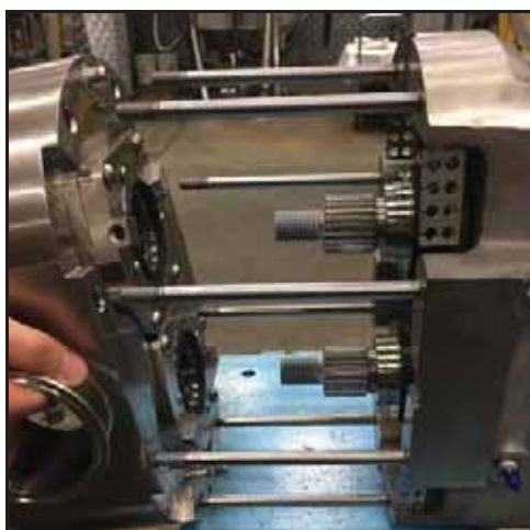
148. ábra – A szivattyúház leszerelése
