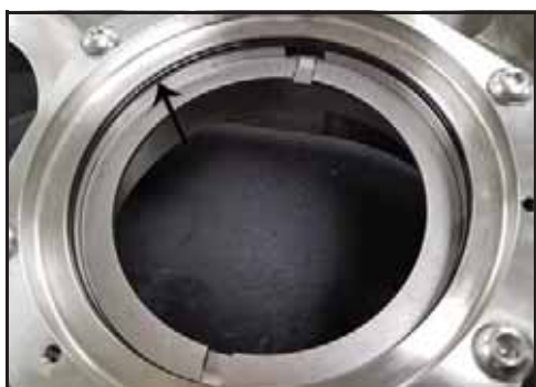
114. ábra – A tömítő O-gyűrű helye
