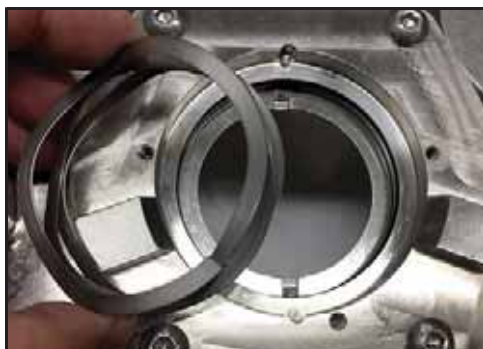
92. ábra – A hullámos rugó beszerelése
