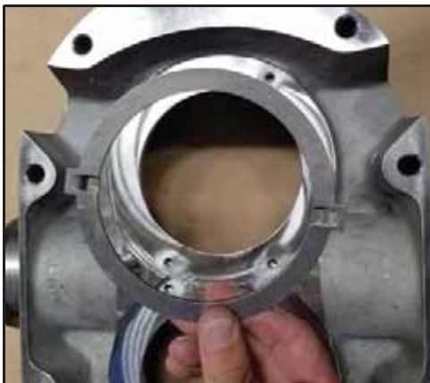
107. ábra – A hajtógyűrű felszerelése
