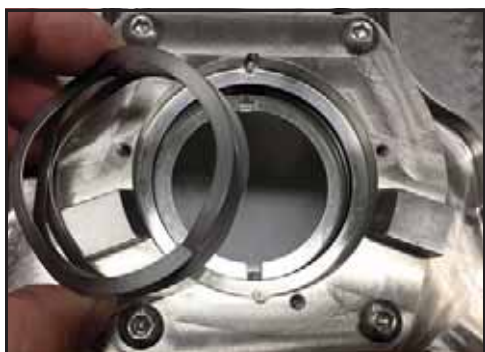
72. ábra – A hullámos rugó eltávolítása
