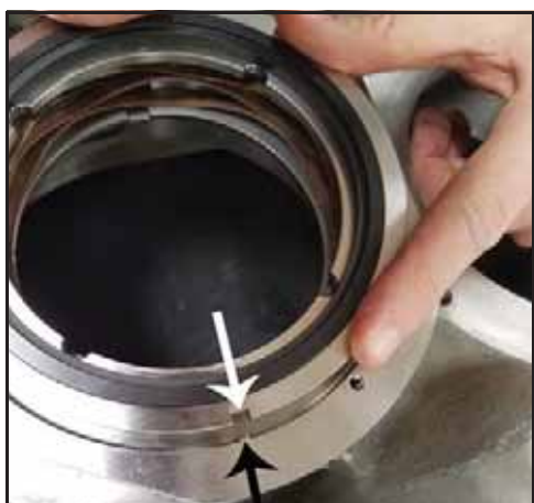
116. ábra – Az átmosás felőli oldal állórésztömítésének behelyezése
