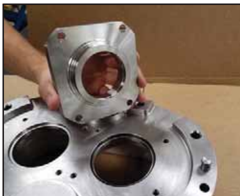
150. ábra – A tömítésház eltávolítása
