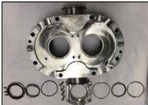
80. ábra – Kettős mechanikai tömítés (a képen a 040-U3 látható)
