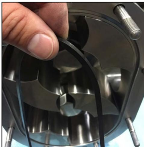
**Figura 262 - Installazione della guarnizione del coperchio**
