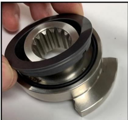
*Figura 41 Rimuovere la guarnizione rotante*
