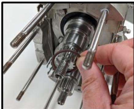
**Figura 102** *Installazione dell'O-ring*
