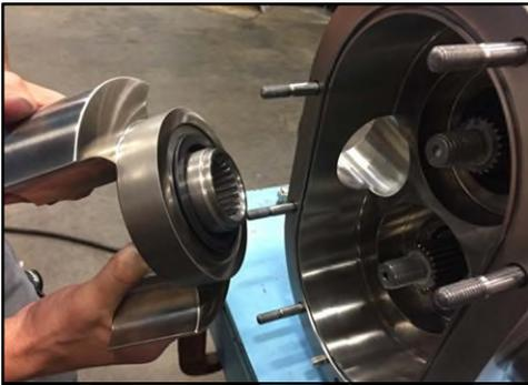
**Figura 255 - Spingere il rotore sull'albero**
