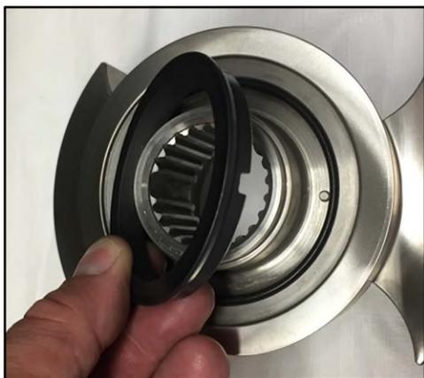
*Figura 116 - Rimuovere la guarnizione rotante*
