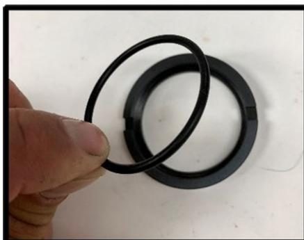
**Figura 103** *Installazione dell'O-ring rotante del lato a filo*
