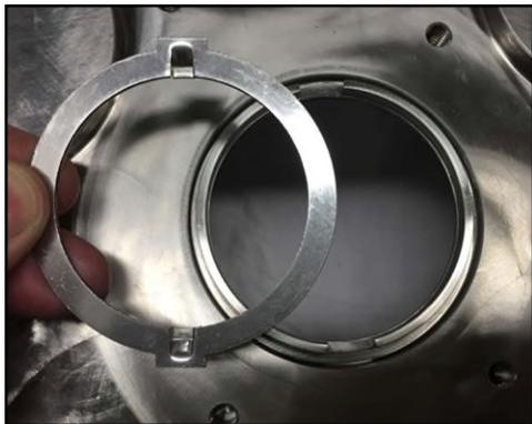
**Figura 161 - Installazione dell'anello di trasmissione**
