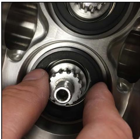
**Figura 211 - Guarnizione stazionaria a pressione**
