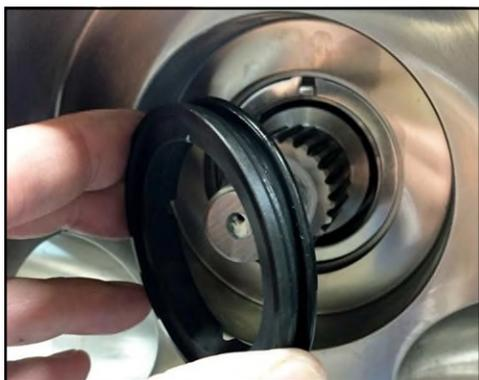
*Figura 118 - Rimozione della guarnizione stazionaria*
