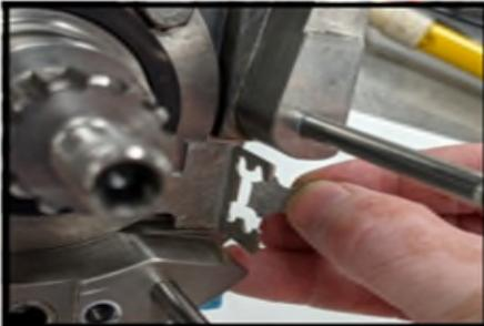
**Figura 106** *Rottura della linguetta della protezione delle dita*
