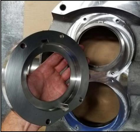
**Figura 141 - Installazione dell'alloggiamento della guarnizione**
