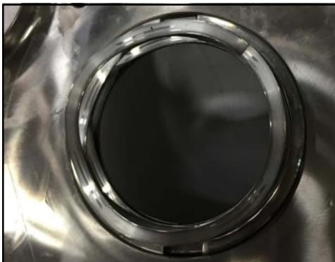
**Figura 134 - Molla a onda installata**
