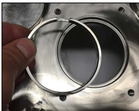
**Figura 129 - Installazione dell'anello dell'albero**
