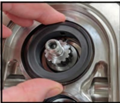
**Figura 71** *Spingere la guarnizione stazionaria*
