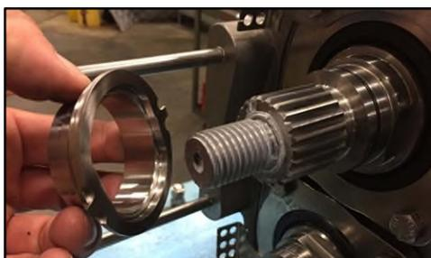
**Figura 199 - Installazione dell'anello di regolazione**
