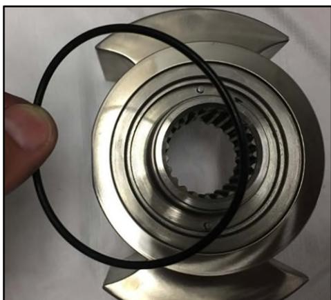
**Figura 213 - Installazione dell'O-ring di guarnizione**
