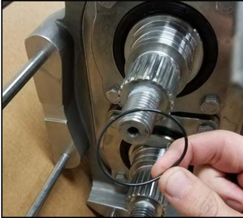
**Figura 232 - Rimozione dell'O-ring**
