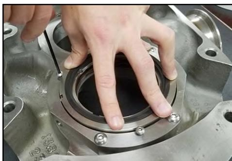
**Figura 195 - Installazione dei bulloni di fissaggio della guarnizione**
