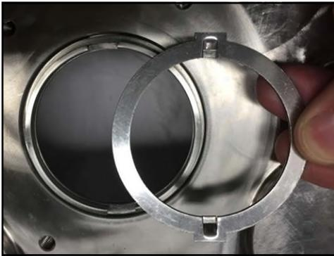
**Figura 156 - Rimozione dell'anello di trasmissione**
