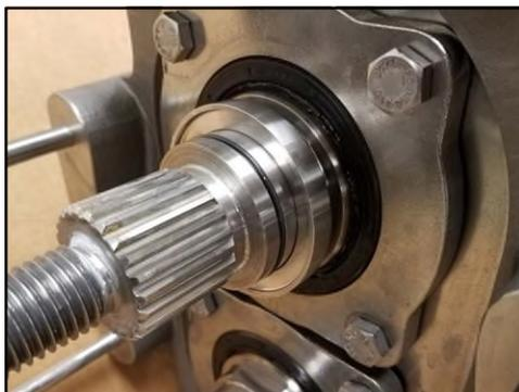
**Figura 241 - Sede della guarnizione installata**
