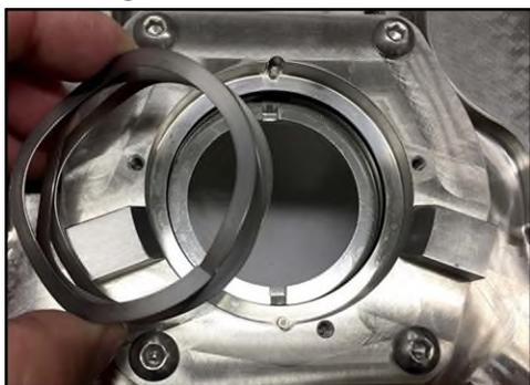
**Figura 150 - Rimozione della molla a onda**
