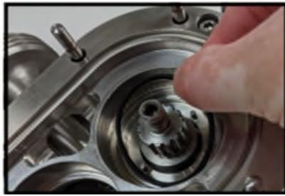
**Figura 110 Installazione dell'O-ring fisso**
