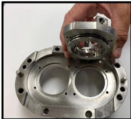
**Figura 94** Installazione dell'alloggiamento della guarnizione
