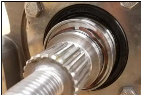
**Figura 242 - Installazione della molla a onda**
