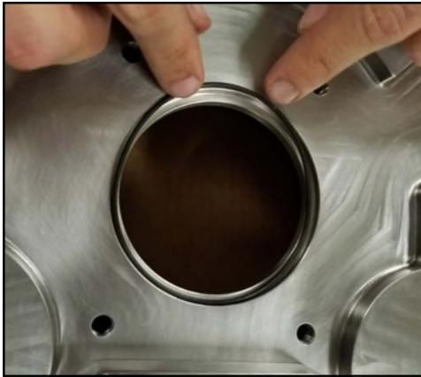
**Figura 229 - Rimozione dell'O-ring**
