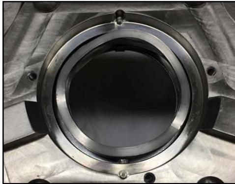
**Figura 171 - Molla ad onda installata**
