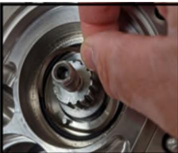
**Figura 47** Installazione della molla a onda fissa
