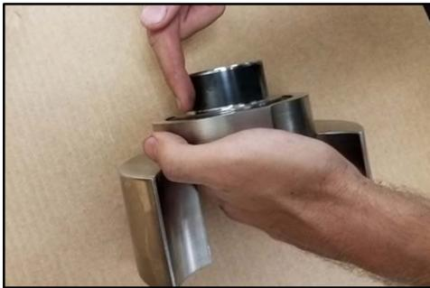
**Figura 252 - Lubrificazione del manicotto di guarnizione**
