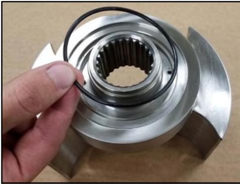
**Figura 247 - Installazione dell'O-ring anteriore del manicotto**
