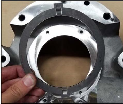
**Figura 138 - Installazione dell'anello di trasmissione**
