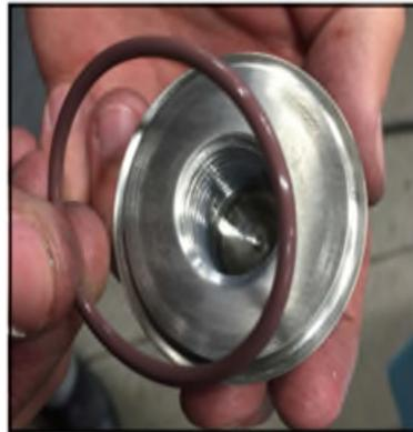
**Figura 39 - Rimozione dell'O-ring**
