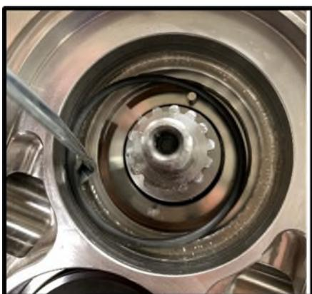
**Figura 44** Rimuovere l'O-ring della guarnizione stazionaria
