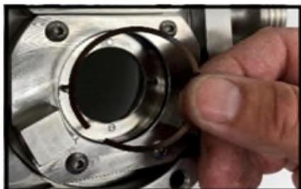
**Figura 98 Installazione della molla a onda sella fissa**
