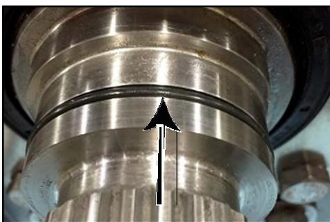
**Figura 147 - Anello di regolazione O-ring**
