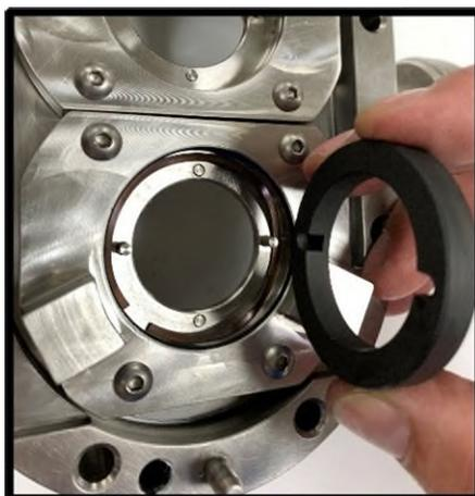
**Figura 85 Rimuovere la guarnizione stazionaria**
