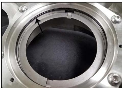
**Figura 192 - Posizione dell'O-ring di guarnizione**
