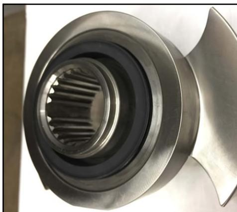
**Figura 216 - Guarnizione rotante installata**
