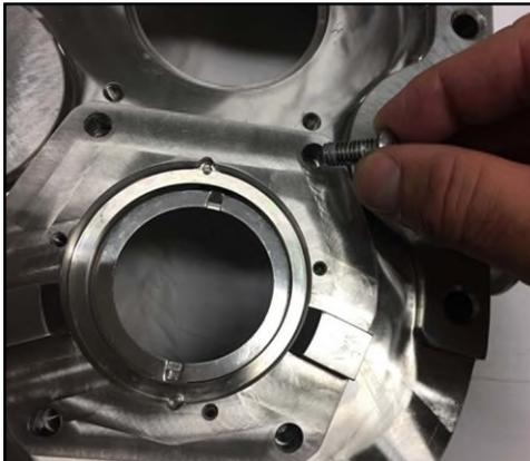
**Figura 166 - Bulloni dell'alloggiamento della guarnizione**
