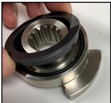
**Figura 51 Installazione della guarnizione rotante**
