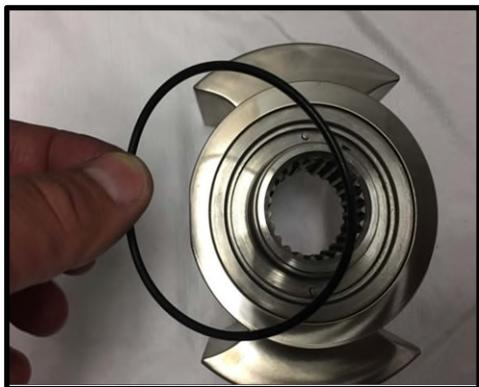
*Figura 117 - Rimuovere l'O-ring di guarnizione*
