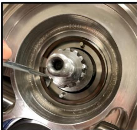
**Figura 56** Rimuovere la molla a onda della guarnizione stazionaria
