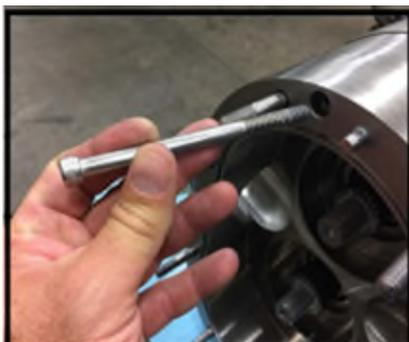
**Figura 57** Rimuovere le viti di fissaggio del corpo
