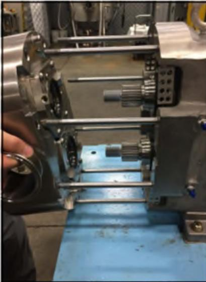
**Figura 107 - Installazione del corpo pompa**
