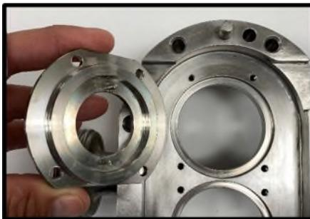
**Figura 62** Installazione dell'alloggiamento della guarnizione
