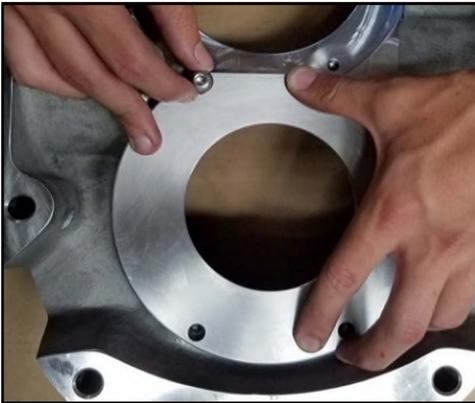
**Figura 142 - Installazione dei bulloni dell'alloggiamento della guarnizione**
