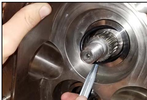
**Figura 221 - Rimozione dell'O-ring**
