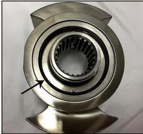
**Figura 214 - O-ring di guarnizione installato**
