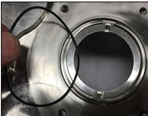
**Figura 154 - Rimuovere l'O-ring dell'alloggiamento della guarnizione**
