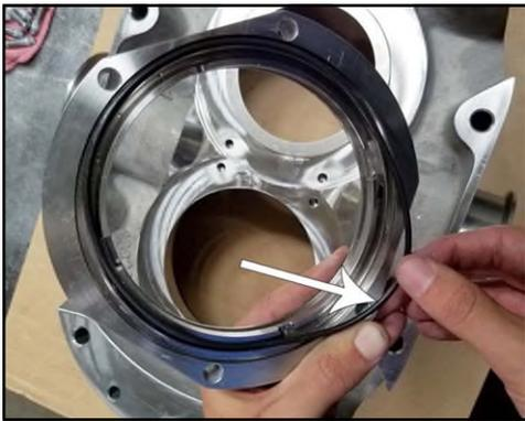
**Figura 187 - Installazione dell'O-ring dell'alloggiamento della guarnizione**
