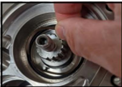
**Figura 111 Installazione della molla a onda fissa**
