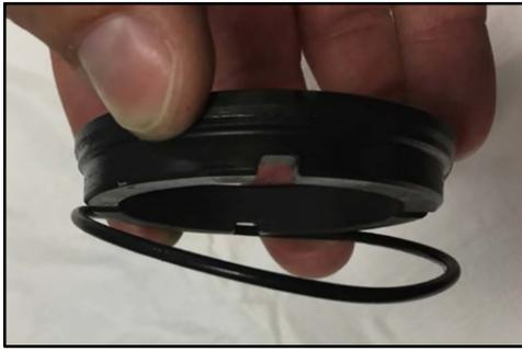
**Figura 119 - Rimozione dell'O-ring della guarnizione stazionaria**
