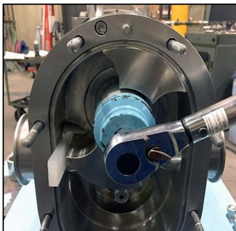
Figura 260 - Dado del rotore da avvitare
