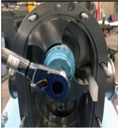
**Figura 38 - Rimozione del dado del rotore**
