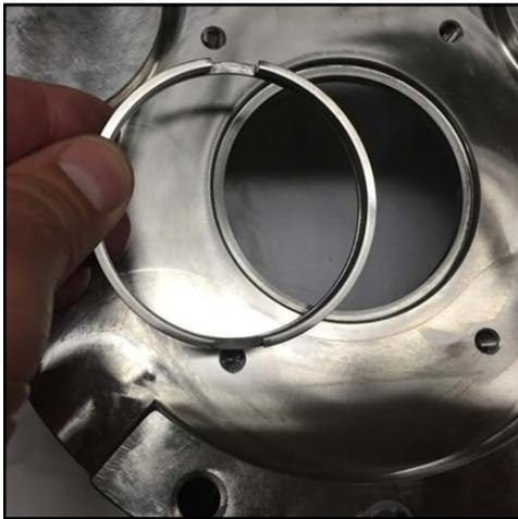
**Figura 159 - Installazione dell'anello dell'albero**
