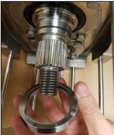
**Figura 231 - Rimuovere la sede della guarnizione**
