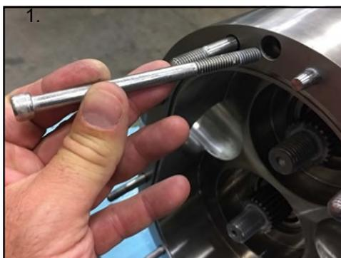
Figura 207 - Installazione delle viti di fissaggio del corpo
