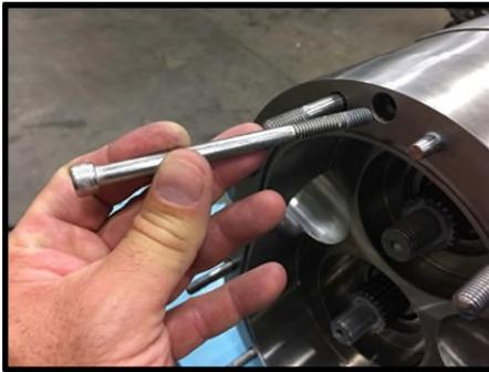
**Figura 79** Rimuovere le viti di fissaggio del corpo
