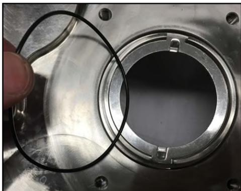
**Figura 163 - Installazione dell'O-ring dell'alloggiamento della guarnizione**
