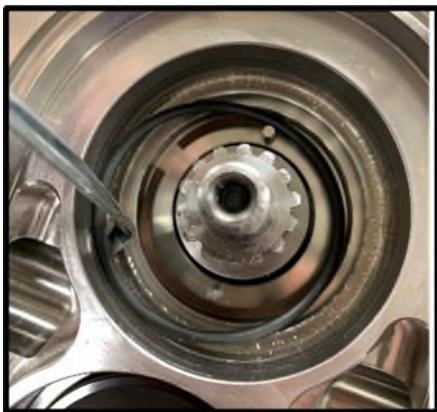
**Figura 55** Rimuovere l'O-ring della guarnizione stazionaria
