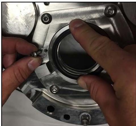
**Figura 148 - Rimuovere i bulloni di fissaggio della guarnizione**
