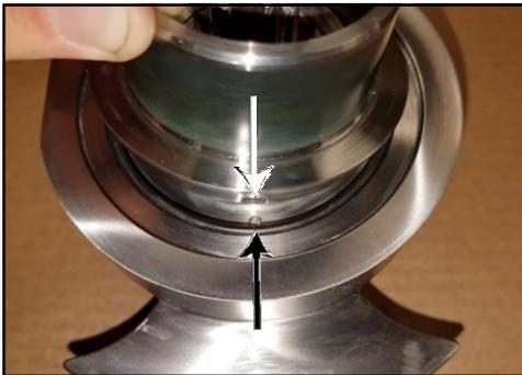
**Figura 249 - Allineamento della tacca e del perno**
