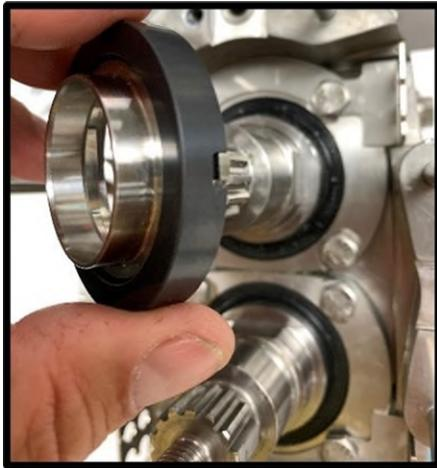
**Figura 81** Rimuovere la guarnizione rotante a filo
