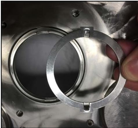
**Figura 126 - Rimozione dell'anello di trasmissione**
