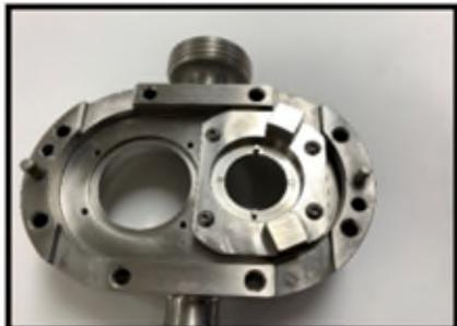
**Figura 96 Alloggiamento della guarnizione installato**
