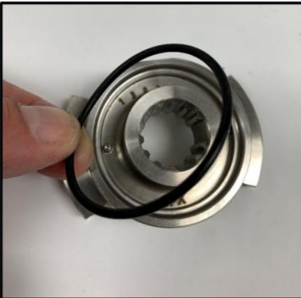
*Figura 53 Rimuovere l'O-ring di guarnizione*
