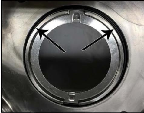
**Figura 164 - O-ring dell'alloggiamento della guarnizione installato**
