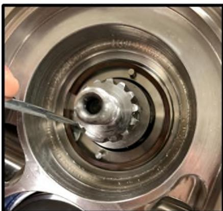
**Figura 45** Rimozione della molla a onda della guarnizione stazionaria
