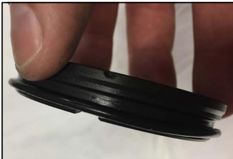
**Figura 209 - O-ring di guarnizione installato**
