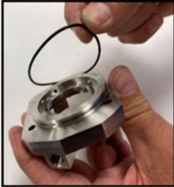
**Figura 90 Rimuovere l'O-ring dell'alloggiamento della guarnizione**
