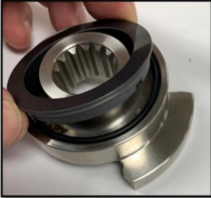
*Figura 52 Rimuovere la guarnizione rotante*
