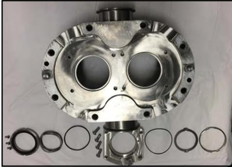
**Figura 158 - Guarnizione meccanica doppia (figura 040-U3)**
