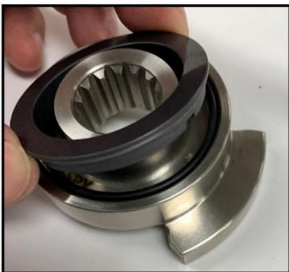
**Figura 74** *Rimuovere la guarnizione rotante*
