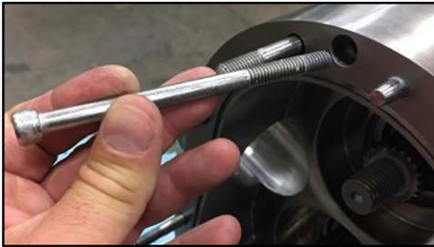
**Figura 225 - Rimuovere le viti di fissaggio del corpo**
