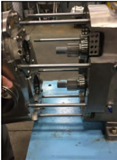
**Figura 65 - Installazione del corpo pompa**
