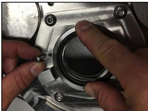
**Figura 174 - Installazione dei bulloni di fissaggio della guarnizione**
