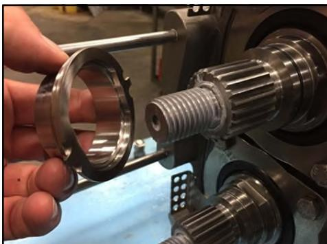
**Figura 179 - Installazione dell'anello di regolazione**
