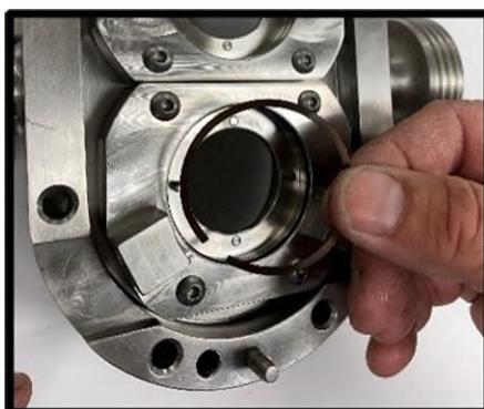
**Figura 86 Rimozione della molla a onda della guarnizione stazionaria**
