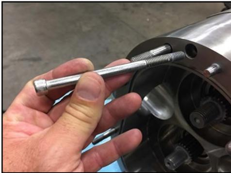
**Figura 245 - Installazione delle viti di fissaggio del corpo**
