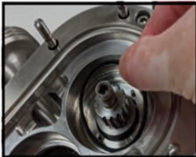
**Figura 68 Installazione dell'O-ring fisso**
