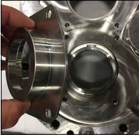
**Figura 135 - Installazione dell'alloggiamento della guarnizione**
