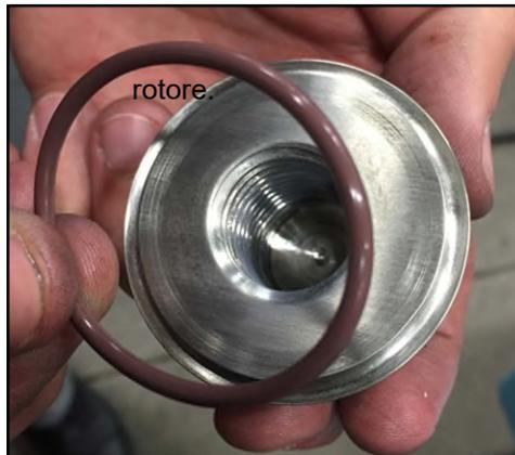
**Figura 257 - Installazione dell'O-ring**
