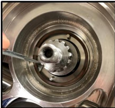
**Figura 78 Rimuovere la molla a onda della guarnizione stazionaria**
