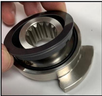
**Figura 73** *Installazione della guarnizione rotante*
