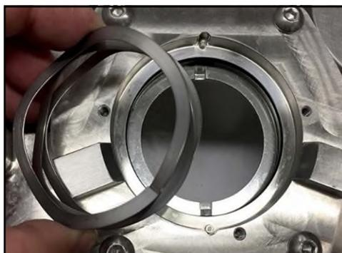
**Figura 170 - Installazione della molla a onda**
