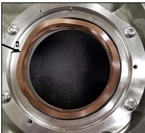
**Figura 193 - Molla ad onda installata**
