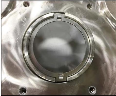
**Figura 132 - anello di trasmissione installato (134- U3 e più piccolo)**
