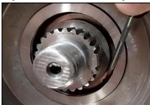
**Figura 223 - Rimozione dell'O-ring**
