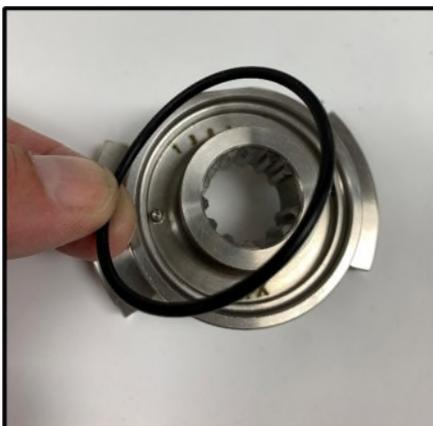
*Figura 42 Rimuovere l'O-ring di guarnizione*
