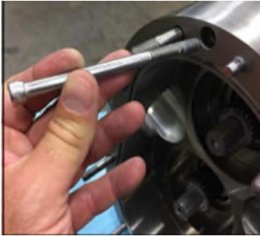
**Figura 67 - Installazione delle viti di fissaggio del corpo**
