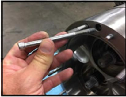
**Figura 109 - Installazione delle viti di fissaggio del corpo**
