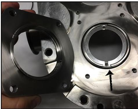
**Figura 153 - Rimuovere l'alloggiamento della guarnizione**
