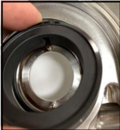
**Figura 70** *Installare la guarnizione stazionaria*
