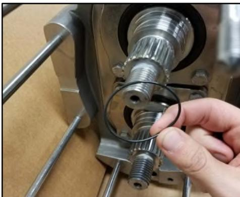
**Figura 238 - Lubrificazione e installazione dell'O-ring**
