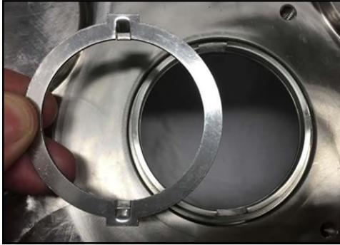
**Figura 131 - Installazione dell'anello di trasmissione**
