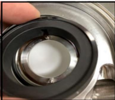
**Figura 48** Installazione della guarnizione stazionaria
