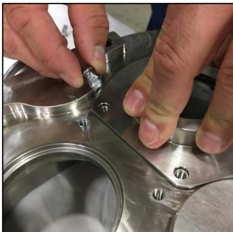
**Figura 122 - Rimuovere i bulloni dell'alloggiamento della guarnizione**
