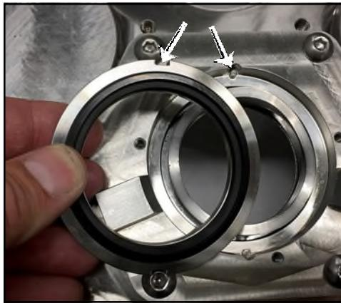
**Figura 172 - Installazione della guarnizione stazionaria a filo**
