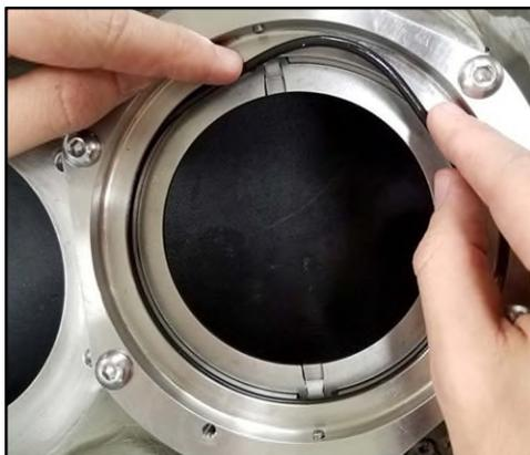
**Figura 191 - Installazione dell'O-ring di guarnizione**
