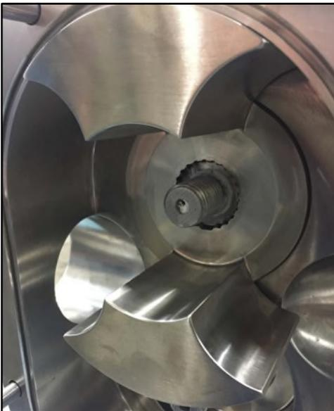
**Figura 256 - Rotore installato**
