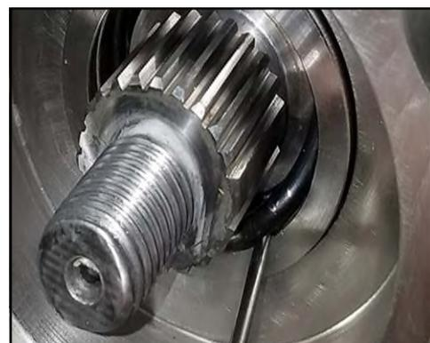
**Figura 224 - Rimozione dell'O-ring**
