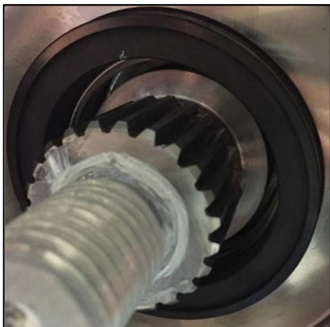
**Figura 212 - Guarnizione stazionaria installata**
