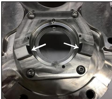
**Figura 167 - Alloggiamento della guarnizione installato**
