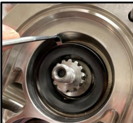
*Figura 54 Rimuovere la guarnizione stazionaria*
