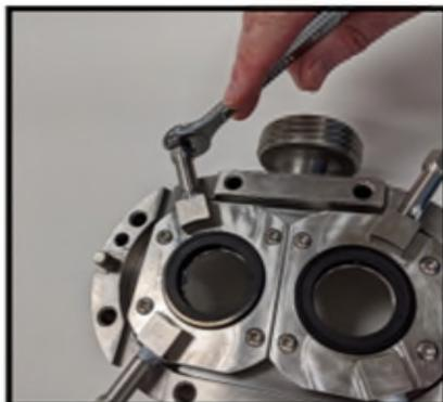
**Figura 101** *Installazione delle estensioni delle porte a filo*
