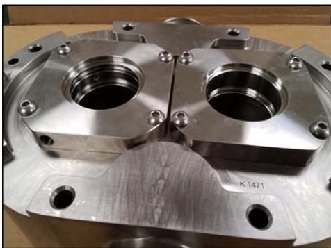
**Figura 237 - Alloggiamenti delle guarnizioni installati**
