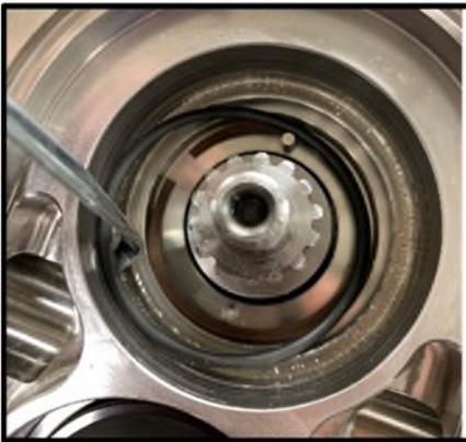
**Figura 77 Rimuovere l'O-ring della guarnizione stazionaria**
