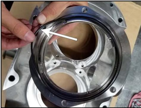
**Figura 155 - Rimuovere l'O-ring dell'alloggiamento della guarnizione**
