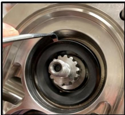
**Figura 43** Rimuovere la guarnizione stazionaria
