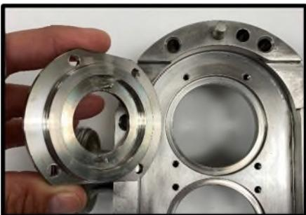
**Figura 60 Rimuovere l'alloggiamento della guarnizione**
