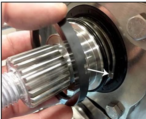
**Figura 203 - Installazione della guarnizione rotante a filo**
