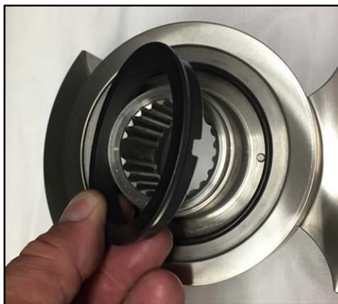
**Figura 215 - Installazione della guarnizione rotante**
