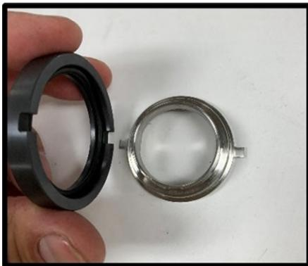
**Figura 82** Rimozione della guarnizione rotante del lato a filo e dell'O-ring
