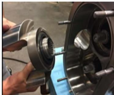
**Figura 40 - Rimozione del rotore**
