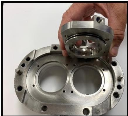
**Figura 89** Rimuovere l'alloggiamento della guarnizione
