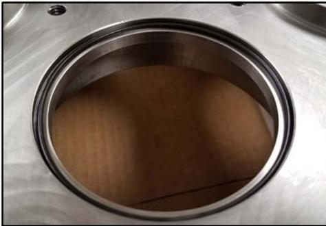
**Figura 233 - O-ring dell'alloggiamento della guarnizione installato**
