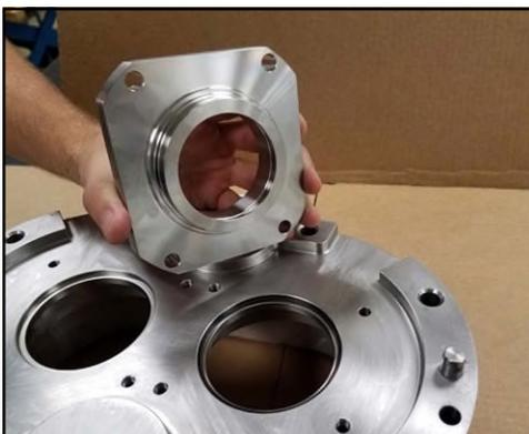
**Figura 228 - Rimuovere l'alloggiamento della guarnizione**
