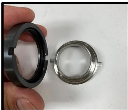
**Figura 104** *Installazione della guarnizione rotante laterale a filo*
