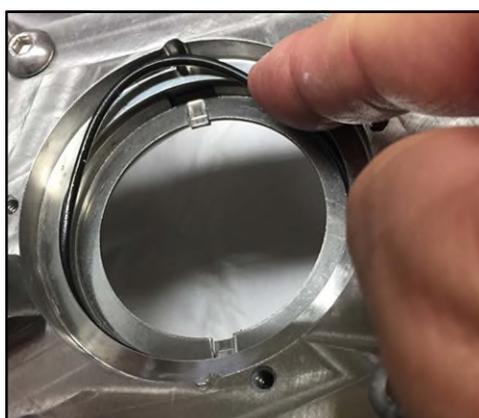
**Figura 168 - Installazione dell'O-ring di guarnizione**
