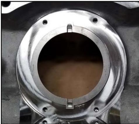
**Figura 139 - Anello di trasmissione installato**
