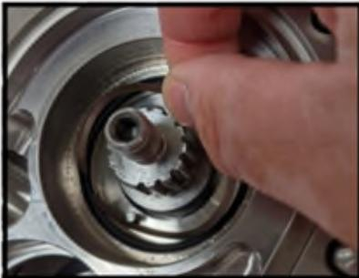
**Figura 69 Installazione della molla a onda fissa**
