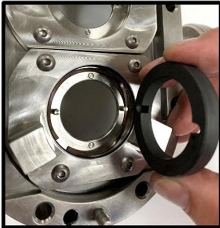
**Figura 99** *Installazione della guarnizione stazionaria*
