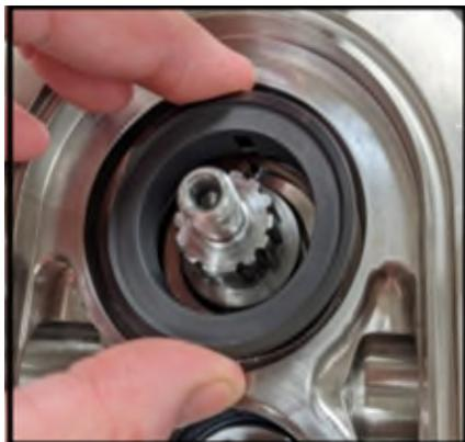
**Figura 49 Spingere la guarnizione stazionaria**
