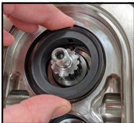
**Figura 113** Guarnizione stazionaria a spinta
