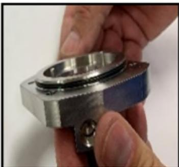
**Figura 92 Installare l'O-ring dell'alloggiamento della guarnizione**
