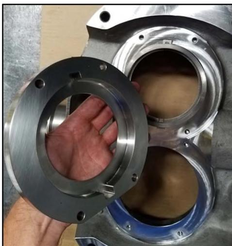
**Figura 124 - Rimuovere l'alloggiamento della guarnizione**
