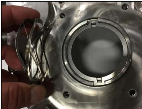
**Figura 133 - Installazione della molla a onda**
