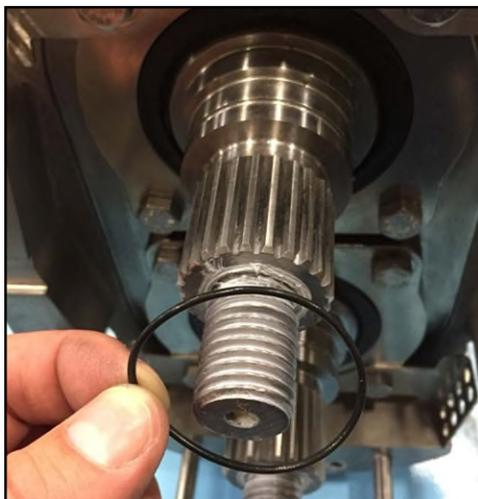
**Figura 197 - Installazione dell'O-ring**
