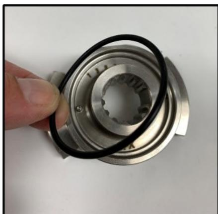
**Figura 50 Installare l'O-ring di guarnizione**
