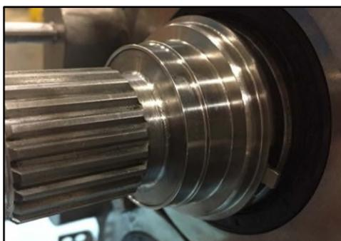
**Figura 200 - Anello di regolazione installato**
