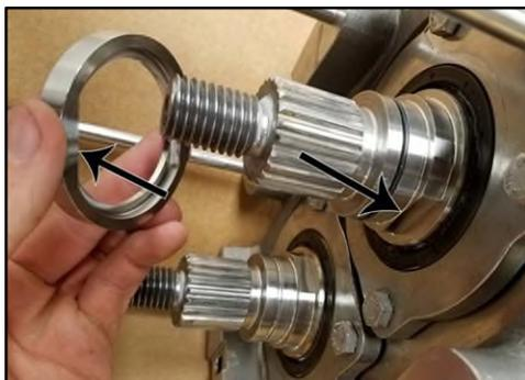
**Figura 240 - Installazione della sede della guarnizione**
