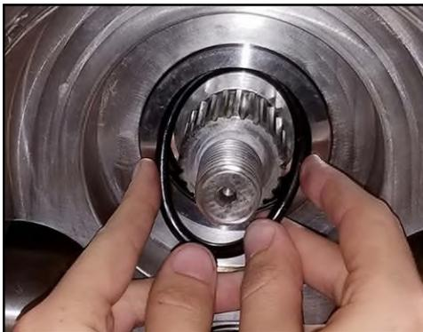
**Figura 246 - Installazione dell'O-ring di guarnizione**
