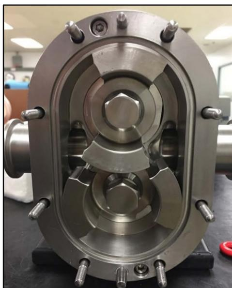
Figura 261 - Rotori installati
