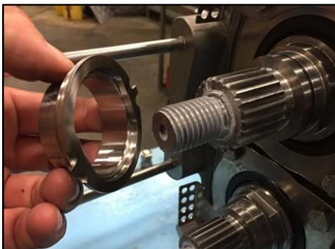
**Figura 146 - Rimozione dell'anello di regolazione**
