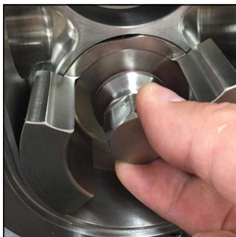
**Figura 259 - Installazione del dado del rotore**
