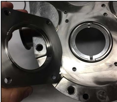
**Figura 165 - Installazione dell'alloggiamento della guarnizione**
