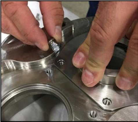
**Figura 136 - Installazione dei bulloni dell'alloggiamento della guarnizione**
