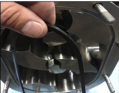
Figura 37 - Rimuovere la guarnizione del coperchio
