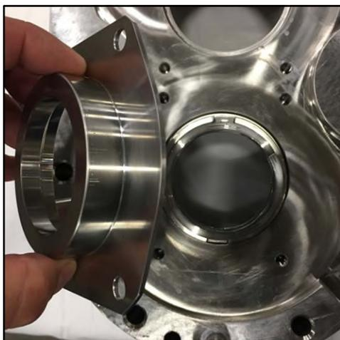
**Figura 123 - Rimuovere l'alloggiamento della guarnizione**
