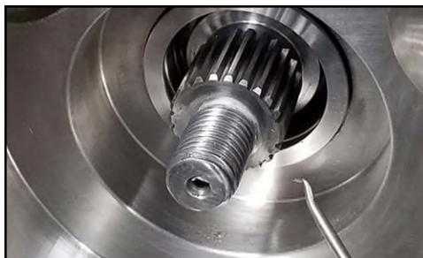
**Figura 222 - Rimozione dell'O-ring**
