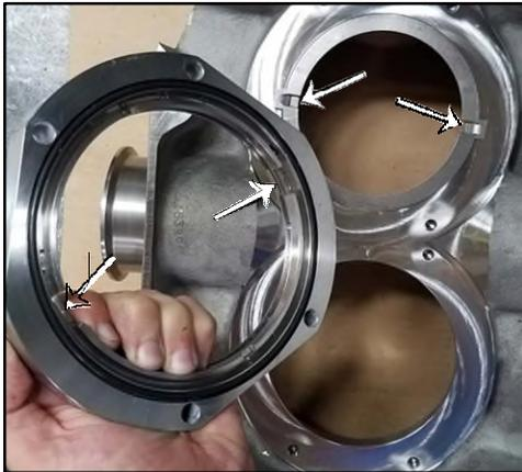
**Figura 188 - O-ring dell'alloggiamento della guarnizione installato**
