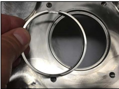
**Figura 157 - Rimozione dell'anello dell'albero**
