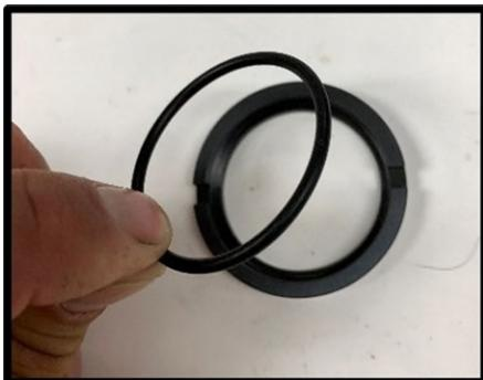
**Figura 83** Rimozione dell'O-ring
