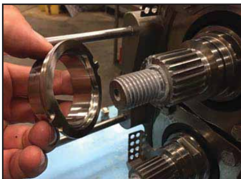
Afbeelding 68 - De afstelring verwijderen
