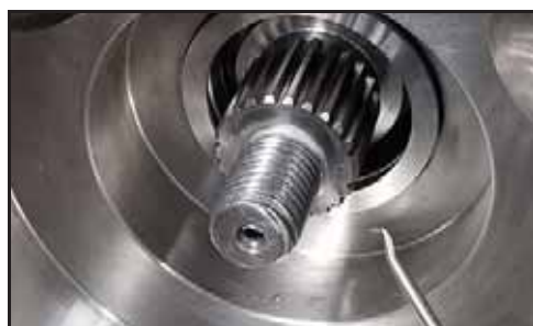
Afbeelding 144 - De O-ring verwijderen
