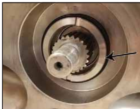
Afbeelding 141 - Mof die blijft zitten na verwijdering van de rotor
