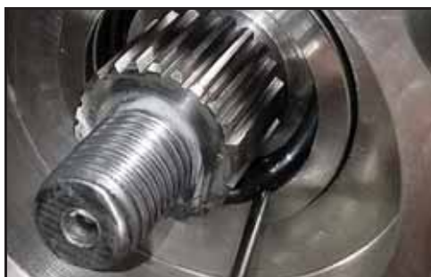
Afbeelding 146 - De O-ring verwijderen
