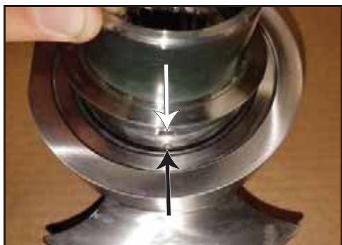
Afbeelding 171 - Zorgen dat inkeping en pen aansluiten
