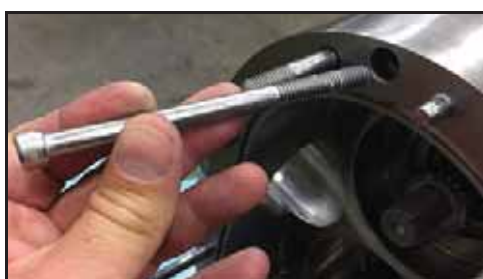
Afbeelding 147 - De borgschroeven van het huis verwijderen
