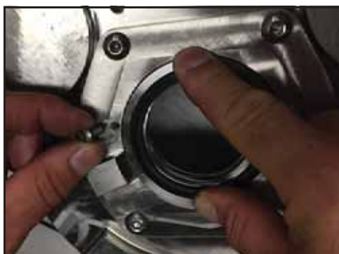
Afbeelding 96 - De borgbouten van de afdichting monteren
