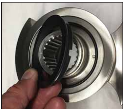
Afbeelding 38 - De glijdringafsluiting verwijderen
