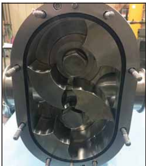
Afbeelding 185 - Geplaatste pakking van de afscherming
