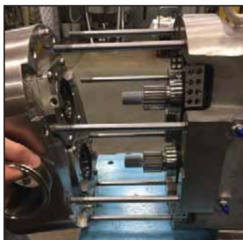
Afbeelding 127 - Het pomphuis installeren
