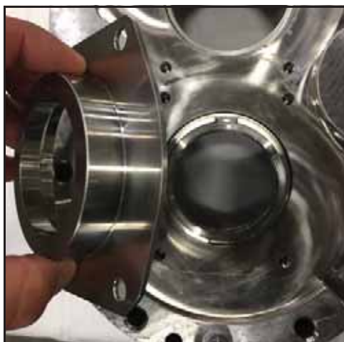
Afbeelding 45 - De afdichtingsbehuizing verwijderen
