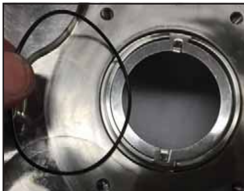
Afbeelding 76 - De O-ring van de afdichtingsbehuizing verwijderen
