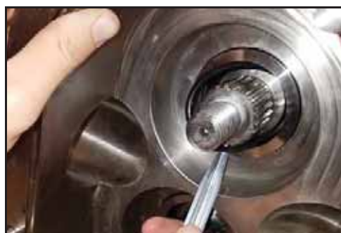
Afbeelding 143 - De O-ring verwijderen
