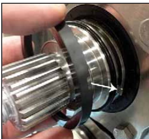
Afbeelding 105 - De glijdringafdichting aan de spoelzijde plaatsen
