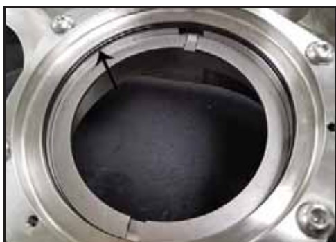
Afbeelding 114 - Locatie van de O-ring van de afdichting
