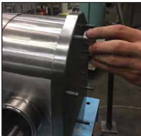
Afbeelding 187 - Moeren van de afscherming monteren
