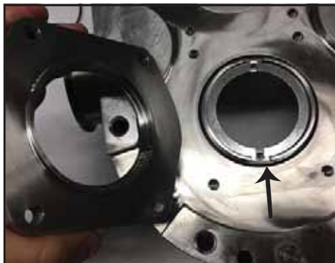
Afbeelding 75 - De afdichtingsbehuizing verwijderen
