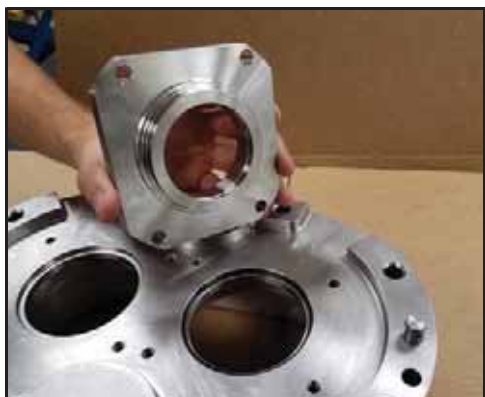
Afbeelding 150 - De afdichtingsbehuizing verwijderen
