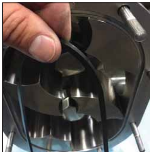
Afbeelding 34 - Pakking afscherming verwijderen
