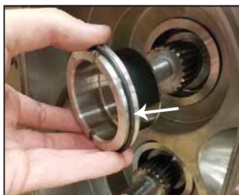
Afbeelding 142 - De mof en O-ring verwijderen
