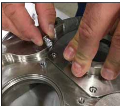
Afbeelding 58 - De bouten van de afdichtingsbehuizing monteren
