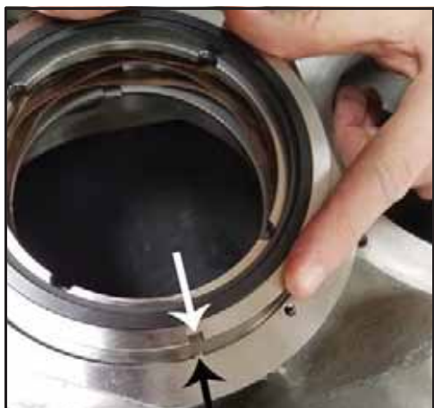
Afbeelding 116 - De vaste afdichting aan de spoelzijde plaatsen
