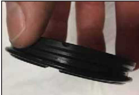
Afbeelding 131 - O-ring van de afdichting geplaatst
