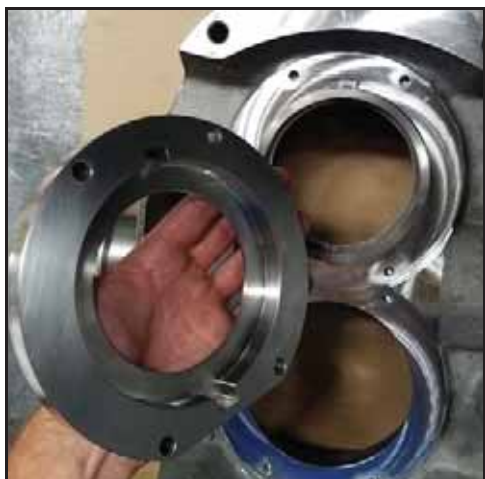
Afbeelding 63 - De afdichtingsbehuizing plaatsen
