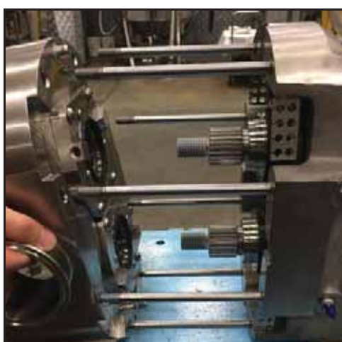
Afbeelding 148 - Het pomphuis verwijderen
