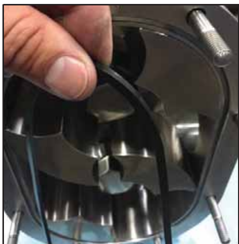
Afbeelding 184 - Pakking afscherming plaatsen
