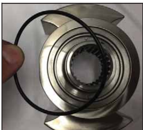
Afbeelding 135 - De O-ring van de afdichting plaatsen
