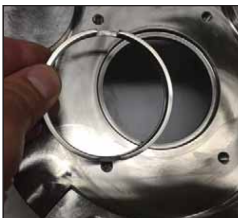
Afbeelding 49 - De asring verwijderen
