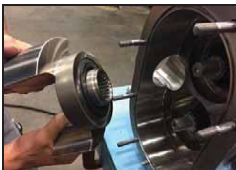
Afbeelding 177 - De rotor op de as drukken
