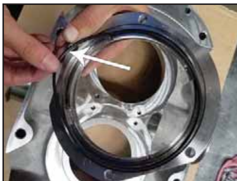
Afbeelding 77 - De O-ring van de afdichtingsbehuizing verwijderen
