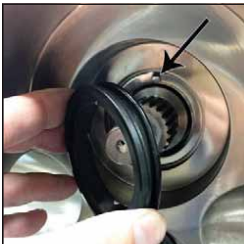
Afbeelding 132 - Vaste afdichting plaatsen
