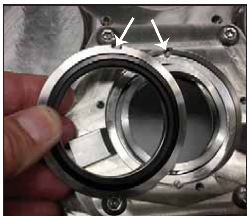
Afbeelding 94 - De vaste afdichting aan de spoelzijde plaatsen
