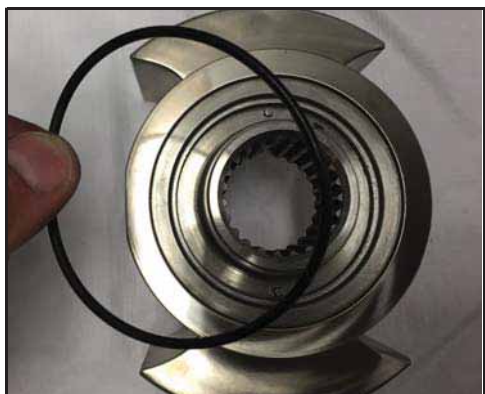
Afbeelding 39 - De O-ring van de afsluiting verwijderen
