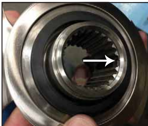
Afbeelding 175 - Timingpen van de rotor
