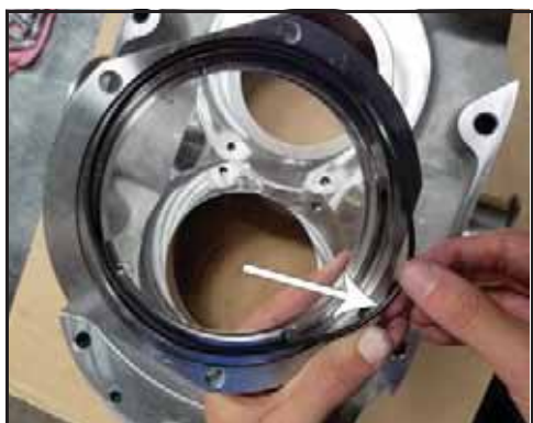
Afbeelding 109 - De O-ring van de afdichtingsbehuizing plaatsen
