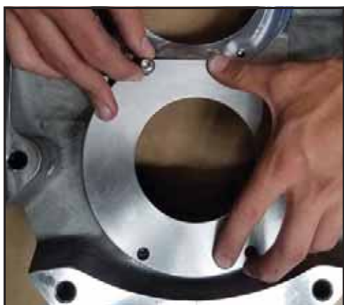
Afbeelding 64 - De bouten van de afdichtingsbehuizing monteren
