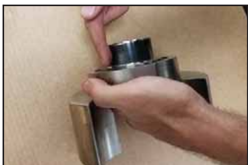
Afbeelding 174 - De afdichtingsmof smeren
