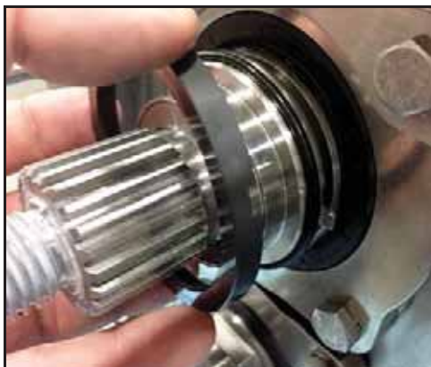
Afbeelding 66 - De glijdringafsluiting aan de spoelzijde verwijderen
