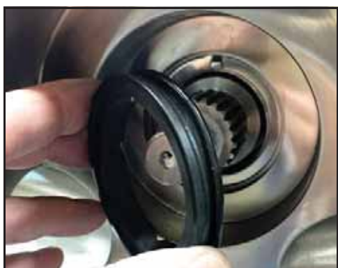
Afbeelding 40 - De vaste afdichting verwijderen
