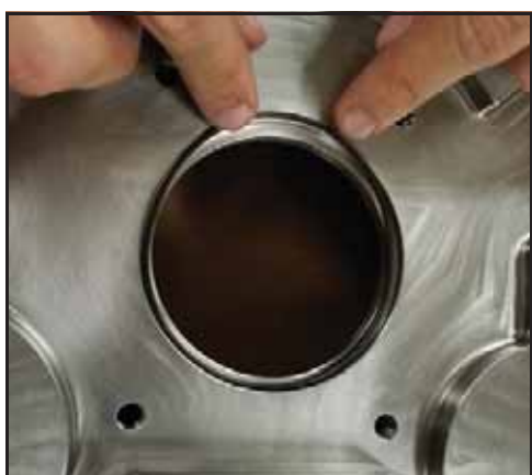
Afbeelding 151 - De O-ring verwijderen
