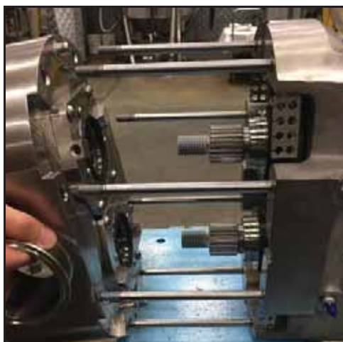
Afbeelding 43 - Het pomphuis verwijderen
