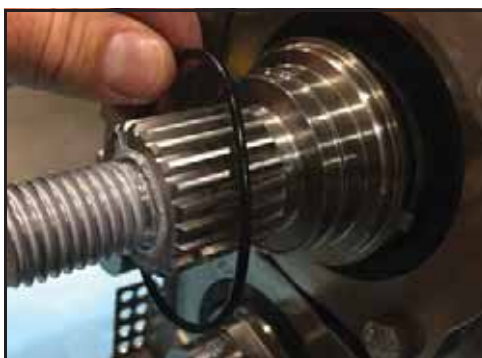
Afbeelding 67 - De O-ring verwijderen
