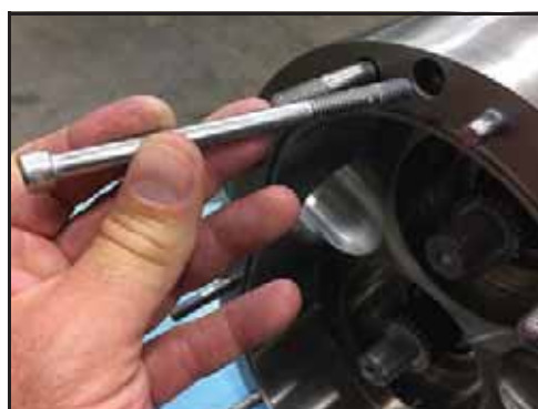
Afbeelding 129 - De borgschroeven van het huis monteren
