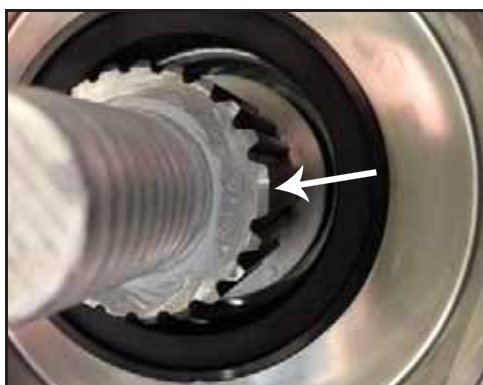
Afbeelding 176 - Timingpen van de as
