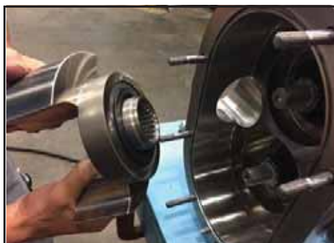
Afbeelding 37 - De rotor verwijderen
