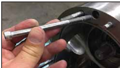
Afbeelding 42 - De borgschroeven van het huis verwijderen
