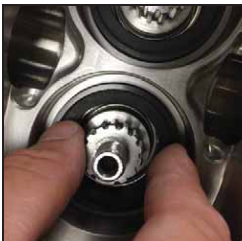
Afbeelding 133 - Op de vaste afdichting drukken
