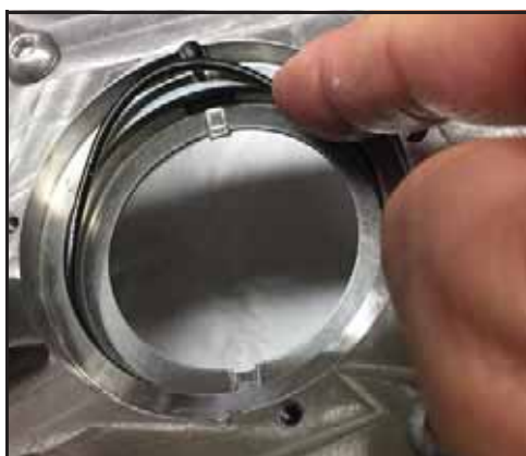
Afbeelding 90 - De O-ring van de afdichting plaatsen
