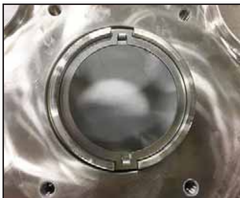
Afbeelding 54 - meenemerring geplaatst (de 130-U3 en kleiner
