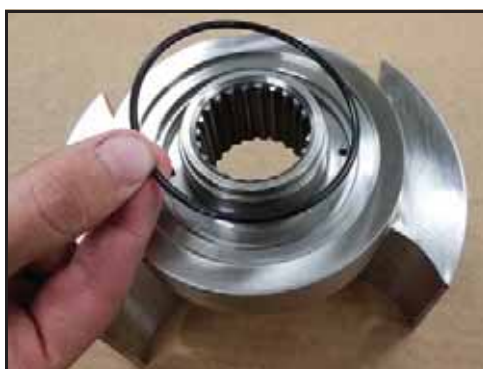
Afbeelding 169 - De voorste O-ring van de mof plaatsen
