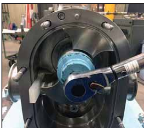
Rysunek 182 — Dokręcenie nakrętki wirnika
