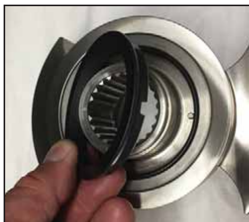
Rysunek 38 — Wyjęcie uszczelki obrotowej
