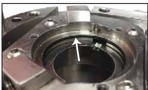
Rysunek 73 — Położenie uszczelniającego pierścienia o-ring
