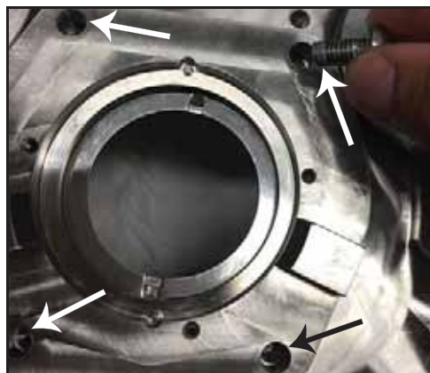
Rysunek 74 — Śruby obudowy uszczelnienia
