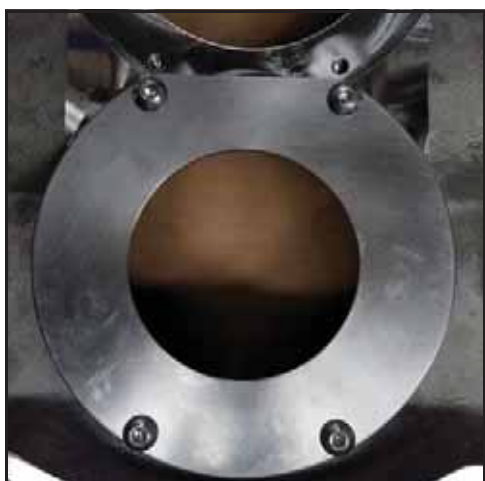
Rysunek 65 — Założona obudowa uszczelnienia
