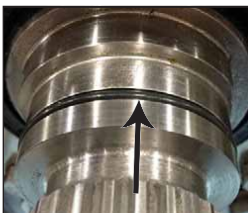
Rysunek 100 — Założony pierścień o-ring
