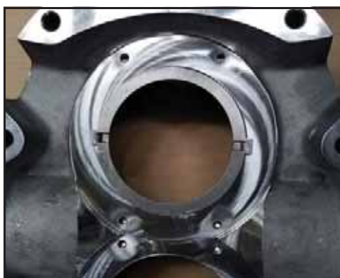
Rysunek 108 — Założony pierścień napędu
