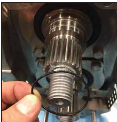
Rysunek 119 — Założenie pierścienia o-ring
