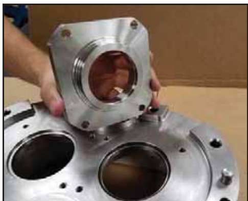
Rysunek 156 — Wyrównanie otworów na śruby
