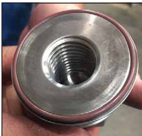
Rysunek 180 — Założony pierścień o-ring
