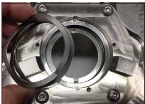
Rysunek 72 — Usunięcie podkładki sprężystej
