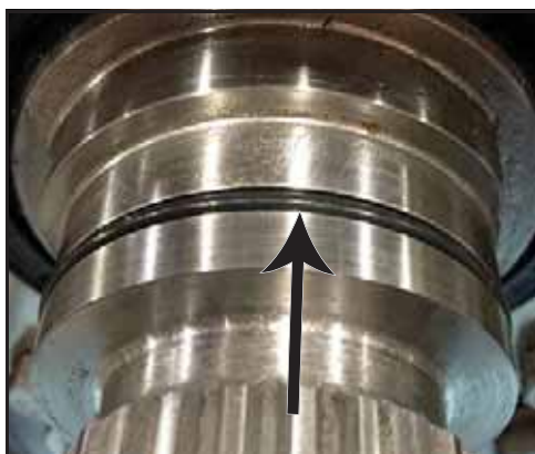
Rysunek 120 — Założony pierścień o-ring
