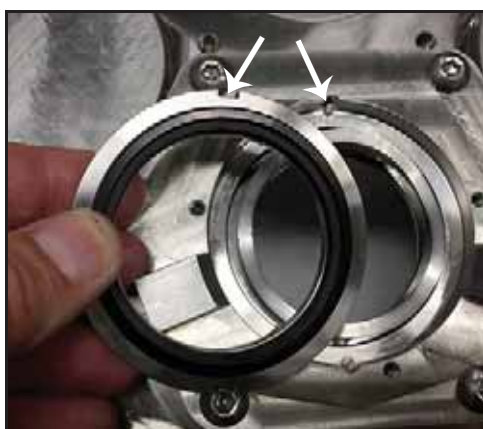
Rysunek 94 — Założenie uszczelnienia nieruchomego od strony płukania
