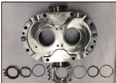
Rysunek 80 — Podwójne uszczelnienie mechaniczne (pokazano 040-U3)
