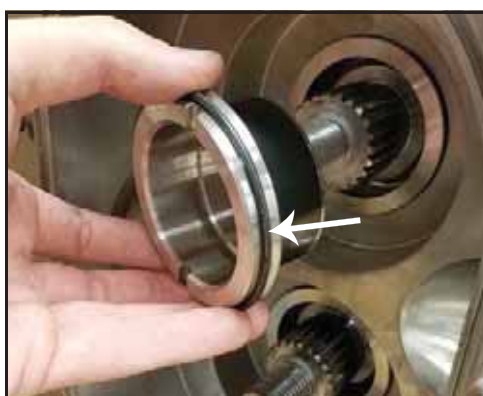
Rysunek 142 — Wyjęcie tulei i pierścienia o-ring
