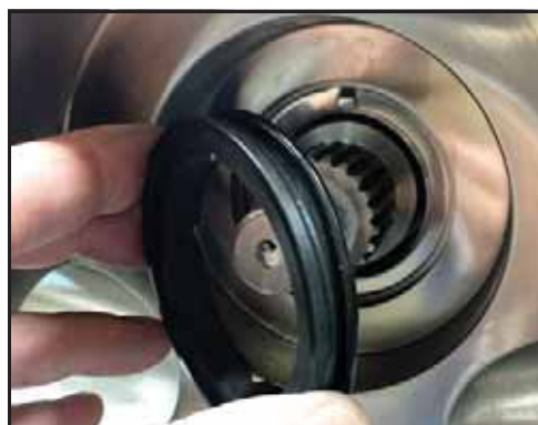
Rysunek 40 — Wyjęcie uszczelnienia nieruchomego
