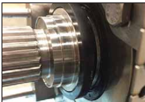
Rysunek 126 - Zainstalowana uszczelka obrotowa
