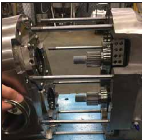
Rysunek 43 — Demontaż korpusu pompy
