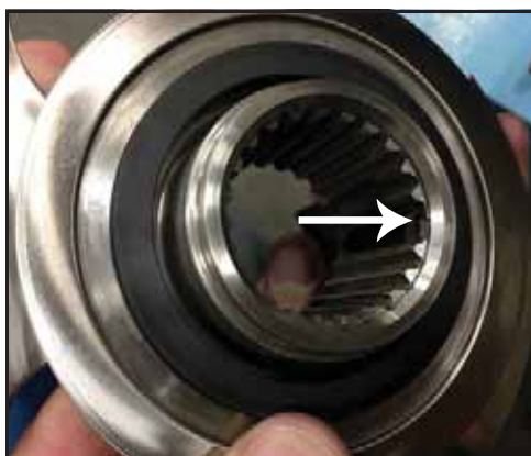
Rysunek 175 — Wypust regulacji wirnika
