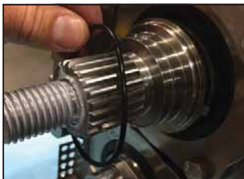
Rysunek 67 — Wyjęcie pierścienia o-ring
