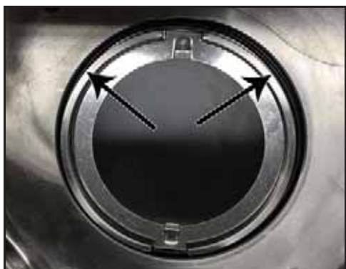
Rysunek 86 — Założony pierścień o-ring obudowy uszczelnienia
