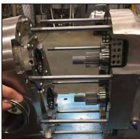
Rysunek 148 — Demontaż korpusu pompy
