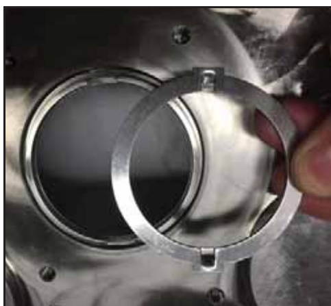
Rysunek 48 — Wyjęcie pierścienia napędu
