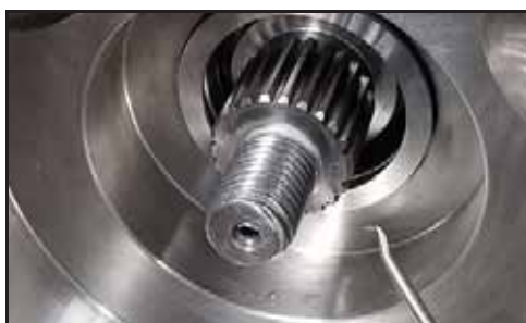
Rysunek 144 — Wyjęcie pierścienia o-ring
