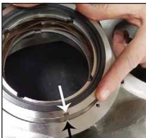
Rysunek 116 — Założenie uszczelnienia nieruchomego od strony płukania
