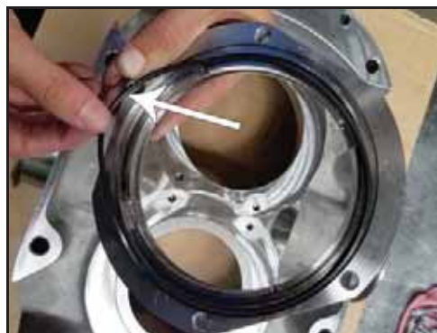
Rysunek 77 — Wyjęcie pierścienia o-ring z obudowy uszczelnienia
