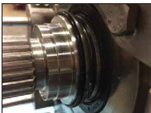
Rysunek 124 — Założony pierścień o-ring
