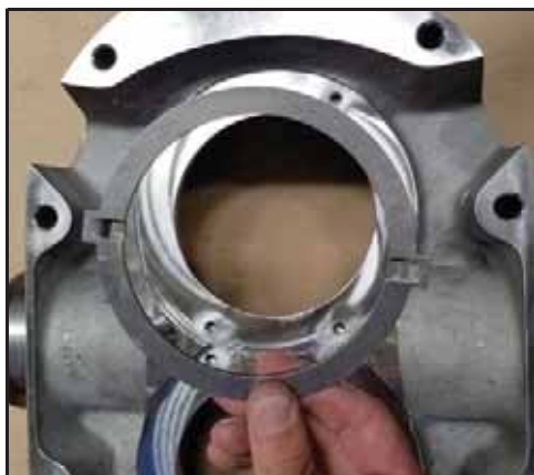
Rysunek 107 — Założenie pierścienia napędu
