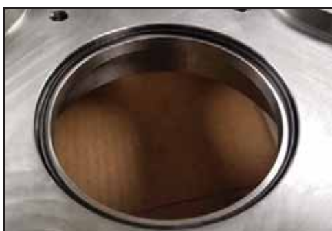
Rysunek 155 — Założony pierścień o-ring obudowy uszczelnienia
