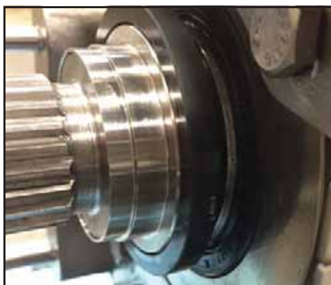
Rysunek 106 - Zainstalowana uszczelka obrotowa
