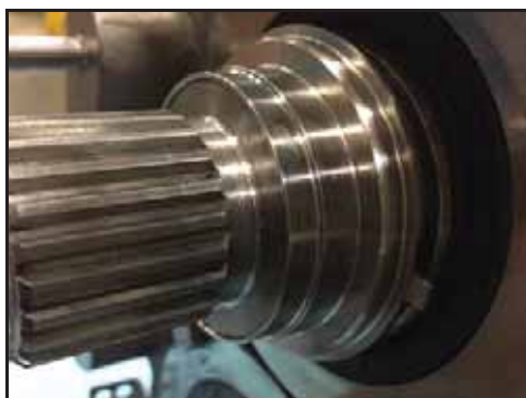
Rysunek 102 — Regulacja założonego pierścienia
