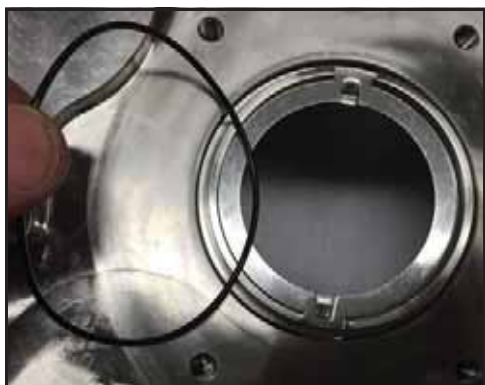
Rysunek 85 — Założenie pierścienia o-ring w obudowie uszczelnienia
