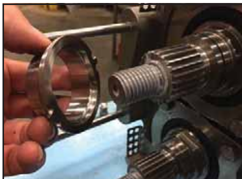
Rysunek 101 — Założenie pierścienia regulacyjnego
