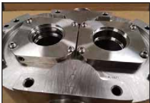
Rysunek 159 — Założone obudowy uszczelnienia
