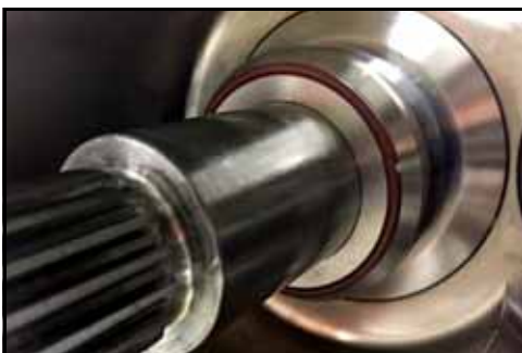
Figura 104 - Tapa del sello instalada en el eje
