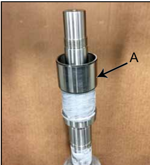
Figura 154 - Coloque la pista interna en el eje
