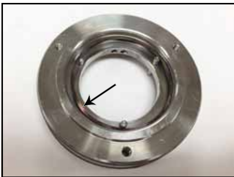
Figura 71 - Resorte de ondas del sello instalado
