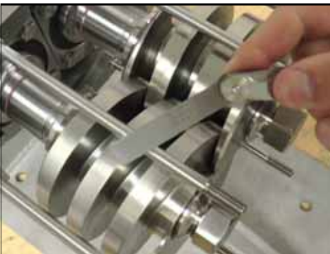
Figura 223 - Elija un calibrador de espesores
