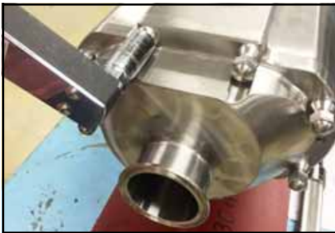
Figura 27 - Retire las tuercas de la cubierta
