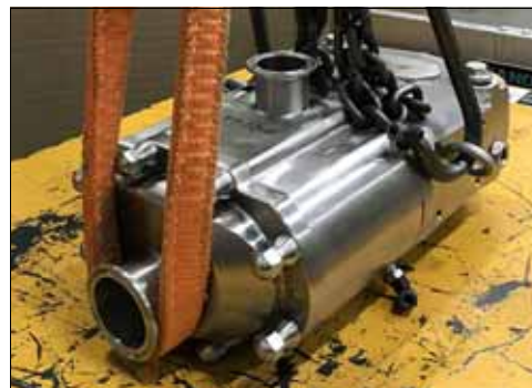
Figura 2 - Detalle de ubicación para la elevación - 015, 030-UTS
