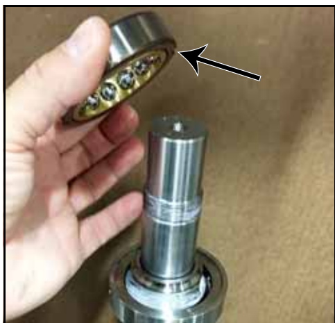
Figura 165 - Coloque el rodamiento en la pista
