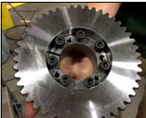
Figura 212 - Coloque el conjunto de bloqueo en el engranaje
