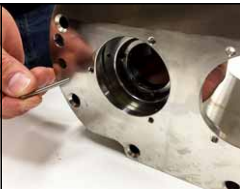
Figura 77 - Utilice un botador de pasadores para alinear los orificios
