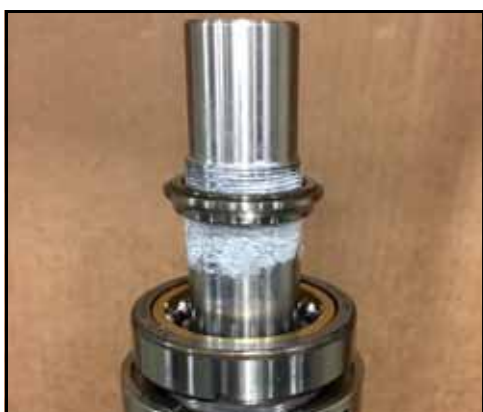
Figura 171 - Coloque la pista en el eje
