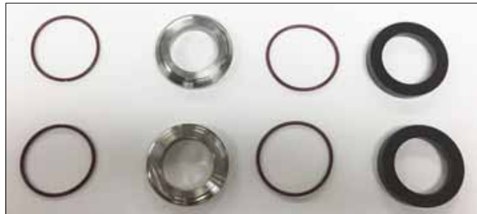
Figura 96 - Componentes del conjunto de la tapa del sello
