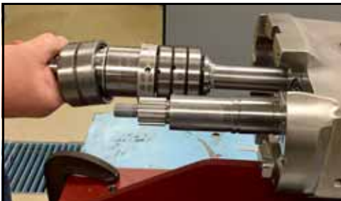
Figura 146 - Extraiga el eje de transmisión de la caja de engranajes
