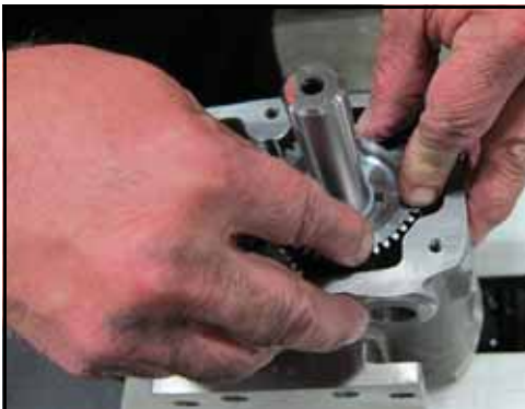
Figura 203 - Instale el engranaje
