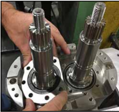
Figura 144 - Retire el retén del rodamiento
