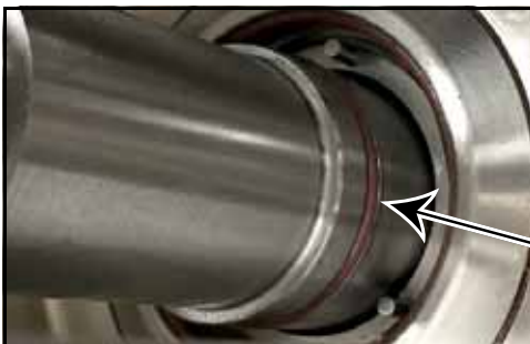
Figura 94 - Instale la junta tórica del eje
