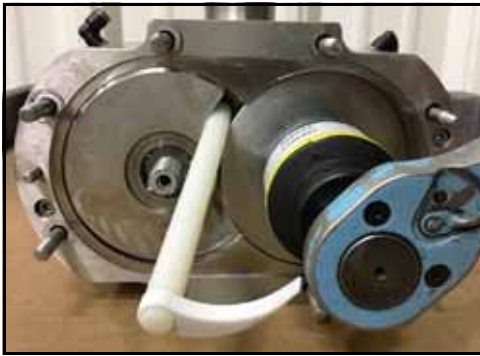
Figura 34 - Inserte la clavija
