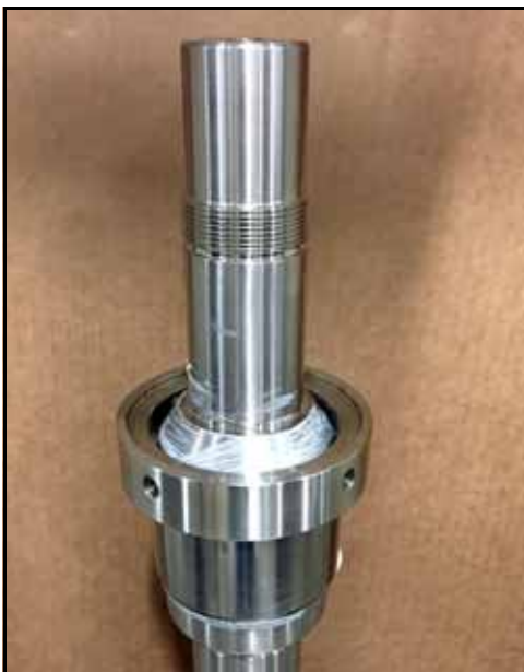
Figura 158 - Espaciador de rodamientos instalado
