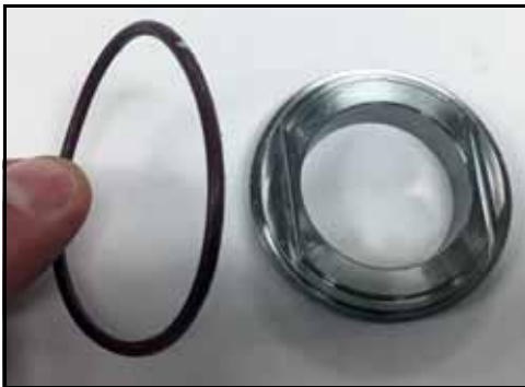
Figura 97 - Instale la junta tórica de la tapa para el asiento
