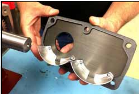
Figura 234 - Coloque la junta en la cubierta
