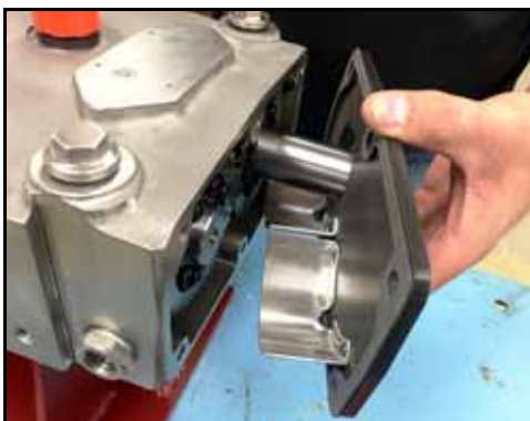
Figura 135 - Retire la cubierta de la caja de engranajes
