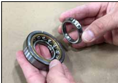
Figura 160 - Retire la pista inferior
