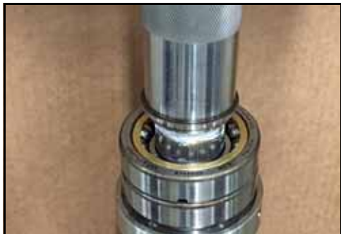
Figura 172 - Presione la pista en el rodamiento
