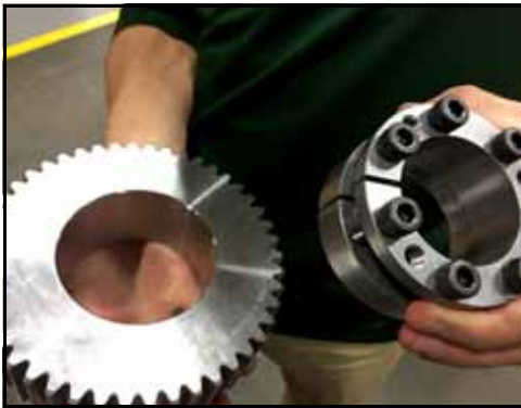
Figura 211 - Monte el conjunto de bloqueo en el engranaje
