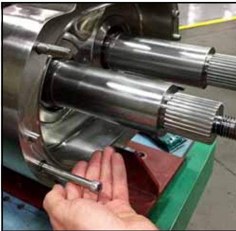
Figura 90 - Instale los tornillos de sujeción del cuerpo
