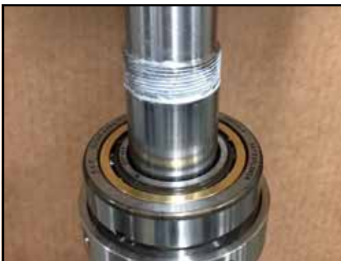
Figura 167 - Pista instalada en el eje
