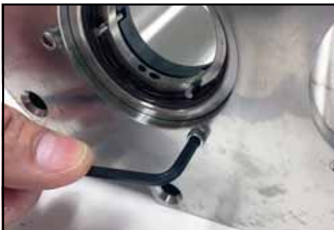
Figura 80 - Instale con tornillos de cabeza hueca
