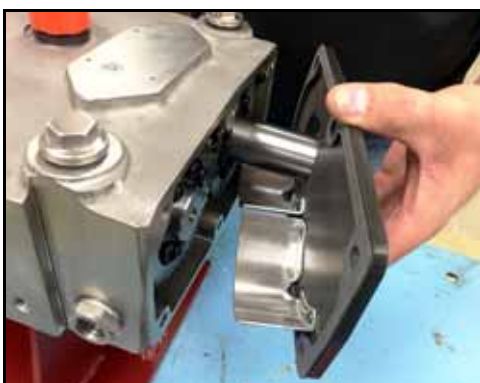
Figura 235 - Instale la cubierta de la caja de engranajes
