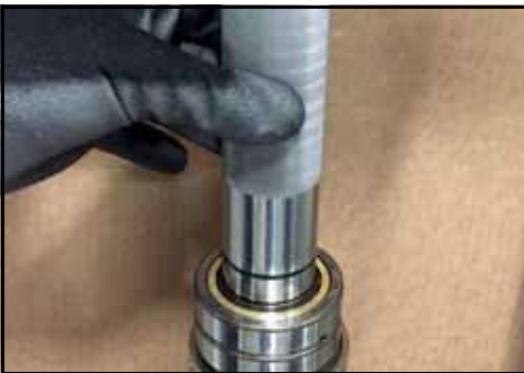
Figura 176 - Presione la pista en el eje
