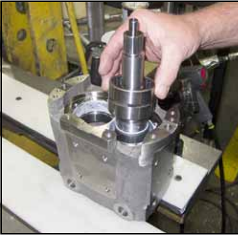
Figura 188 - Coloque la pista exterior del rodamiento de agujas en el eje
