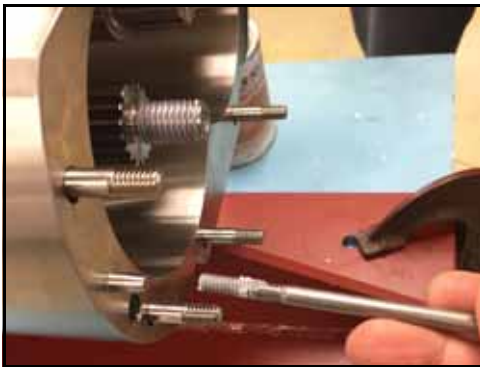
Figura 51 - Retire los tornillos de sujeción del cuerpo
