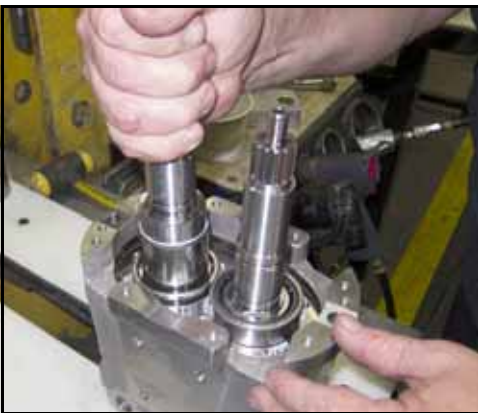
Figura 189 - Coloque el eje de transmisión en el orificio
