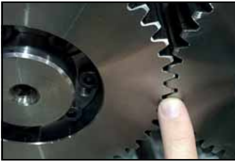
Figura 225 - Alinee el engranaje
