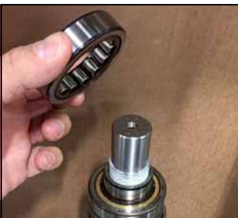
Figura 177 - Coloque el rodamiento en la pista
