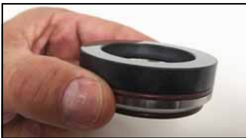
Figura 102 - Asiento de sello instalado en la tapa del sello
