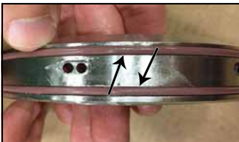
Figura 62 - Juntas tóricas del transportador para el cuerpo
