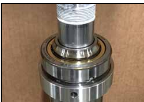
Figura 169 - Presione la pista en el rodamiento
