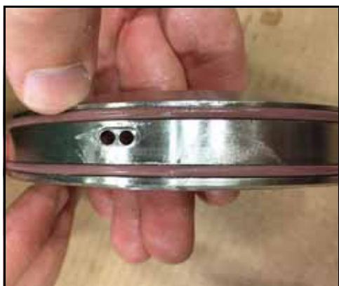
Figura 65 - Juntas tóricas instaladas
