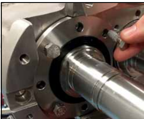
Figura 143 - Afloje y retire los tornillos de retención del rodamiento
