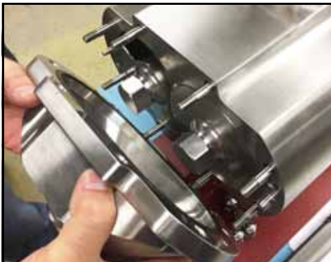
Figura 28 - Retire la cubierta de la bomba
