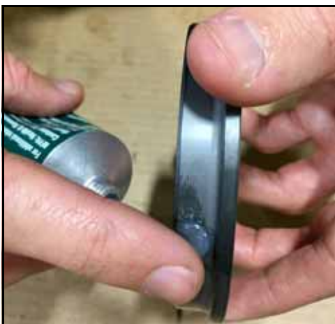
Figura 81 - Lubrique el diámetro exterior del sello
