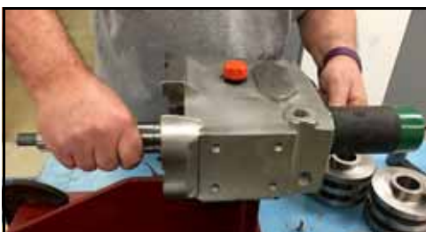
Figura 147 - Pegue sobre el eje corto para sacarlo de la caja de engranajes
