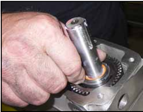
Figura 205 - Instale la tuerca de bloqueo
