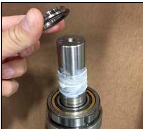
Figura 168 - Coloque la pista en el eje
