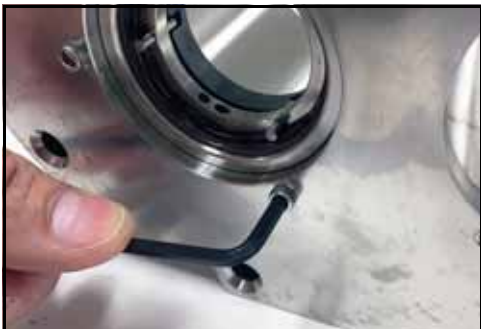
Figura 56 - Retire los tornillos del cabezal
