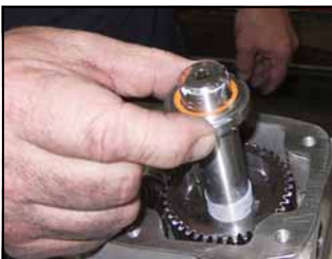
Figura 204 - Instale la tuerca de bloqueo
