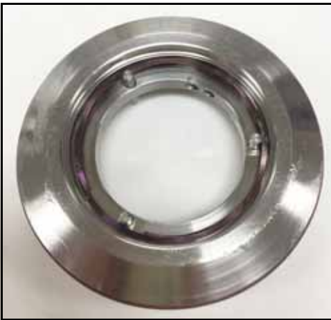
Figura 67 - Resorte de ondas del sello instalado
