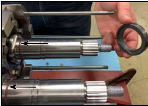
Figura 54 - Retire las juntas tóricas del eje
