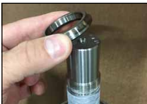
Figura 162 - Coloque la pista en el eje
