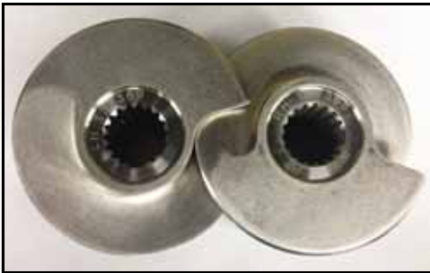
Figura 42 - Disposición de los husillos de la izquierda (LH) y la derecha (RH)
