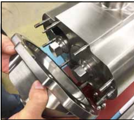
Figura 128 - Instale la cubierta de la bomba
