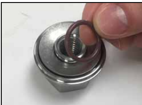
Figura 114 - Instale la junta tórica de retén de la arandela
