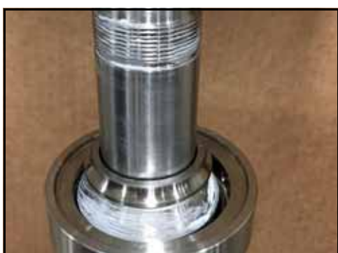
Figura 164 - Pista presionada en el eje
