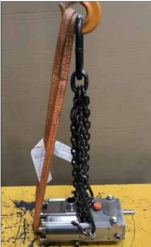
Figura 1 - Ubicación para la elevación - 015, 030-UTS
