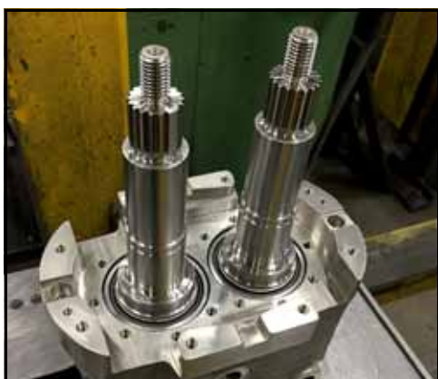
Figura 192 - Ejes asentados en la caja de engranajes
