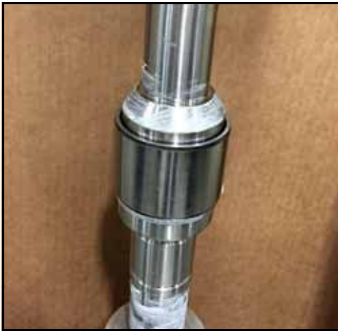
Figura 156 - Pista interna instalada en el eje
