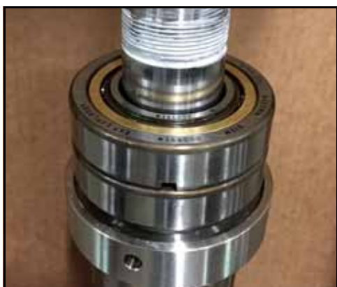
Figura 173 - Segundo rodamiento instalado
