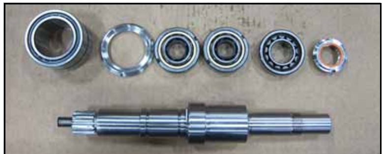
Figura 151 - Eje corto: elementos de montaje necesarios
