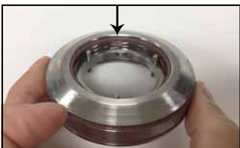
Figura 59 - Junta tórica del portador al sello instalada
