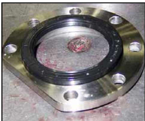
Figura 193 - Centre el sello del retén del rodamiento
