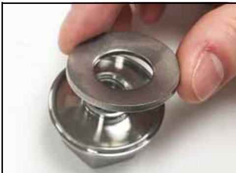
Figura 113 - Instale la arandela Belleville
