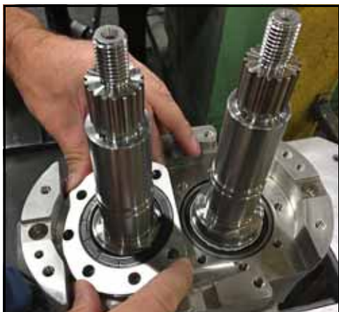
Figure 199 – Installation du dispositif de retenue des roulements
