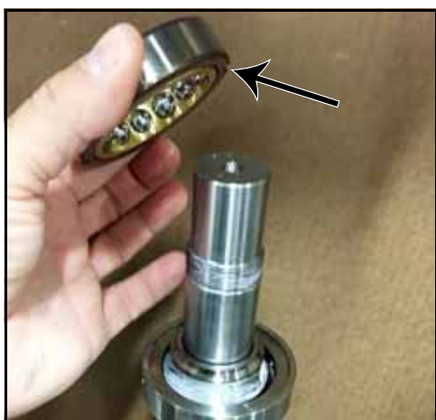
Figure 165 – Placement du roulement sur la bague
