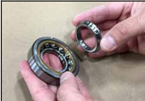
Figure 160 – Dépose de la bague inférieure
