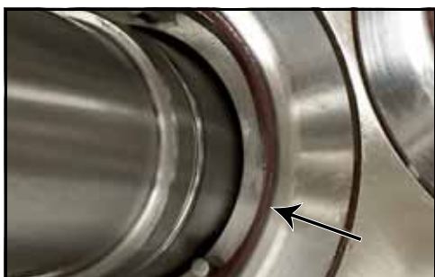
Figure 93 – Installation du joint torique entre le couvercle et la garniture
