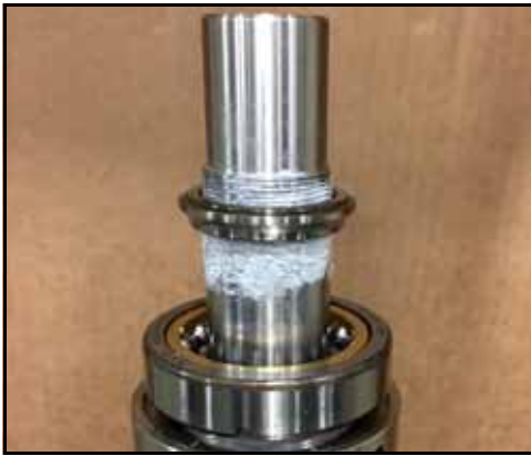
Figure 166 – Placement de la bague sur l'arbre
