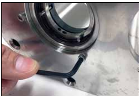
Figure 80 – Mise en place des vis d'assemblage
