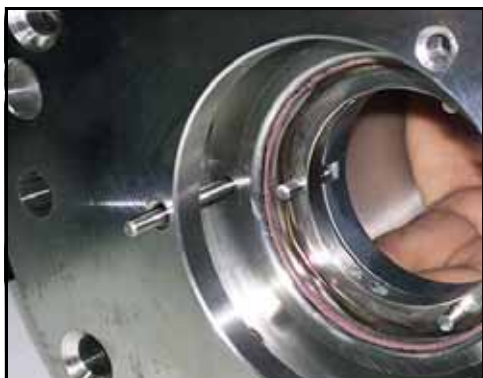
Figure 78 – Utilisation d'une broche d'assemblage pour aligner les orifices
