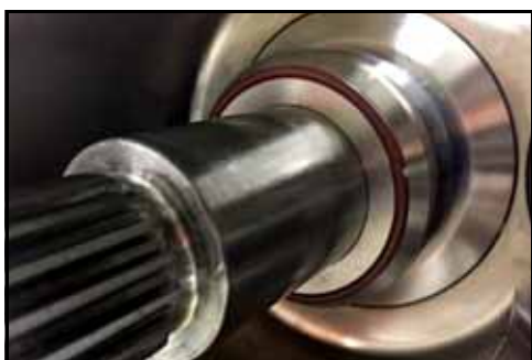
Figure 104 – Bouchon de la garniture placé sur l'arbre
