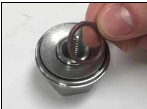
Figure 114 – Installation du joint torique de retenue de la rondelle
