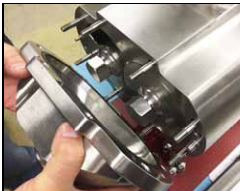
Figure 28 – Retrait du couvercle de la pompe
