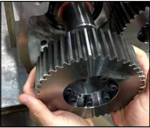
Figure 213 – Installation des engrenages sur les arbres de la pompe
