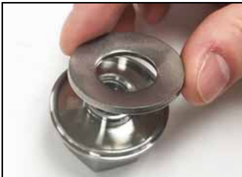
Figure 40 – Dépose de la rondelle Belleville
