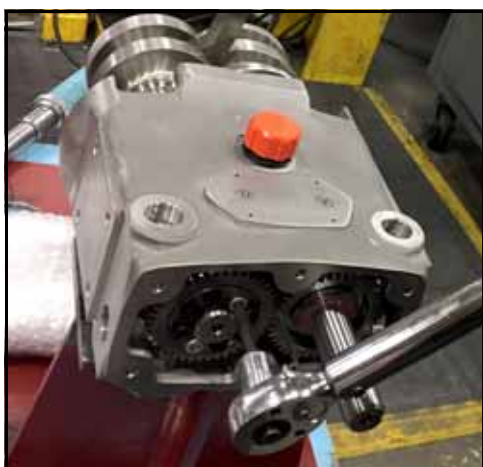
Figure 227 – Vissage des boulons du dispositif de blocage
