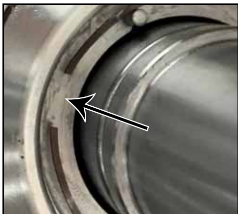
Figure 92 – Position du ressort ondulé de la garniture
