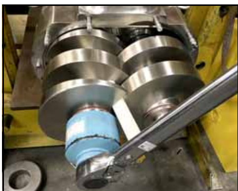
Figure 125 – Serrage de l'écrou de rotor gauche
