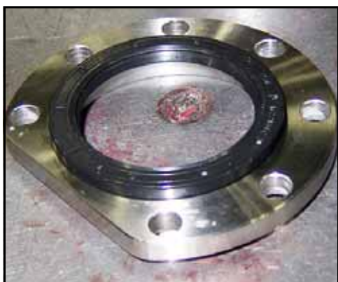
Figure 193 – Centrage du joint du dispositif de retenue des roulements
