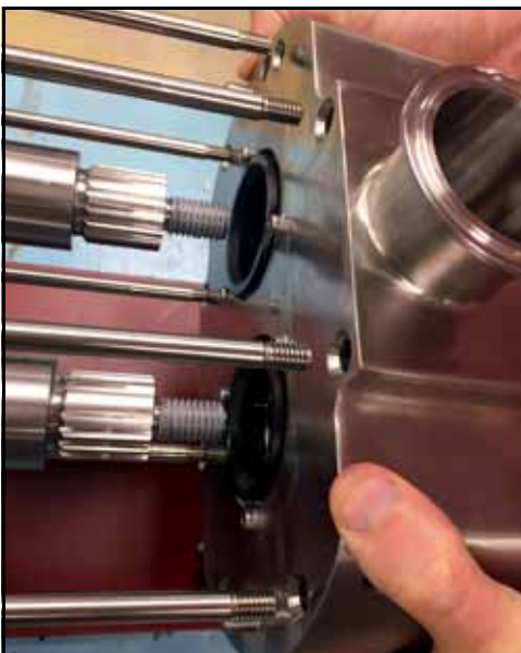
Figure 87 – Installation du corps de la pompe sur les arbres
