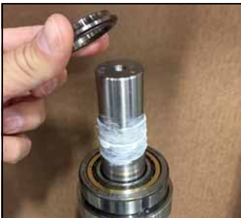
Figure 168 – Placement de la bague sur l'arbre
