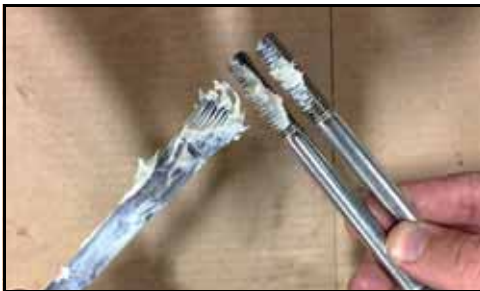
Figure 89 – Application d'antigrippant sur les filetages
