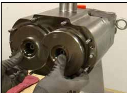
Figure 41 – Dépose des rotors
