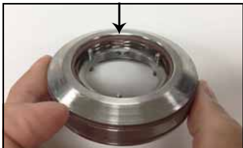
Figure 70 – Joint torique entre le couvercle et la garniture installé
