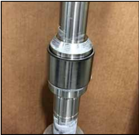
Figure 156 – Bague interne placée sur l'arbre
