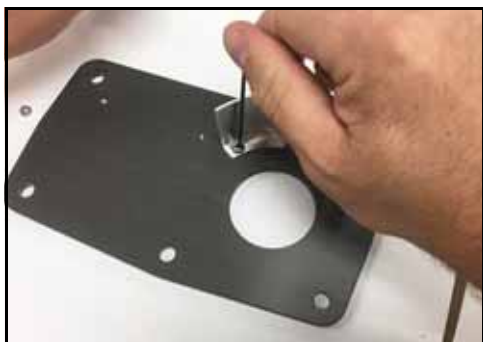
Figure 232 – Serrage des vis du protecteur
