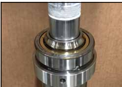
Figure 169 – Enfoncement de la bague dans le roulement à l'aide de la presse
