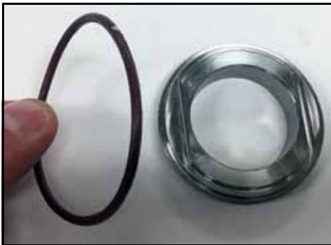
Figure 97 – Installation du joint torique entre le bouchon et le siège
