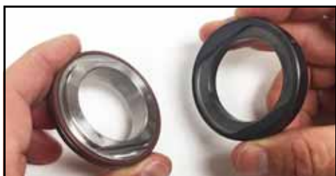
Figure 101 – Alignement du bouchon et du siège de la garniture
