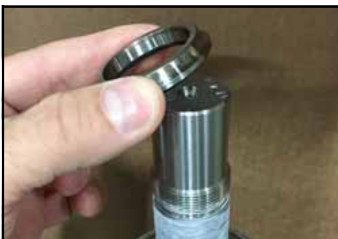
Figure 162 – Placement de la bague sur l'arbre
