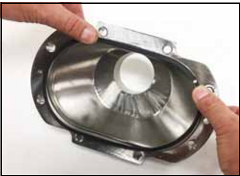
Figure 127 – Installation du joint d'étanchéité
