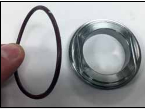
Figure 46 – Dépose du joint torique entre le bouchon et le siège
