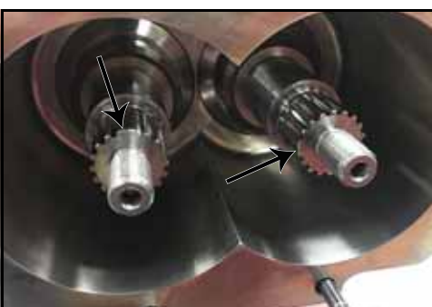
Figure 108 – Alignement du rotor et de la cannelure de l'arbre
