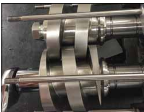
Figure 220 – Installation des écrous de rotor
