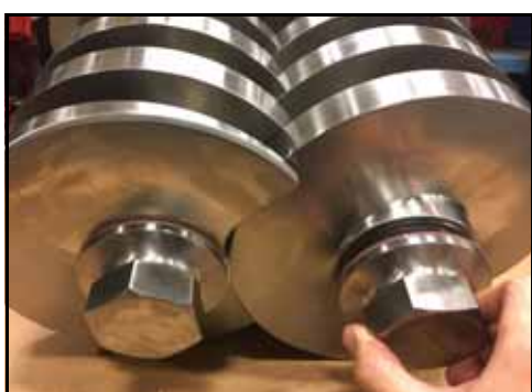
Figure 37 – Dépose des écrous des rotors
