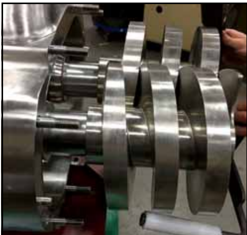
Figure 110 – Glissement des rotors sur les arbres
