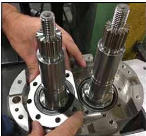
Figure 144 – Dépose du dispositif de retenue des roulements
