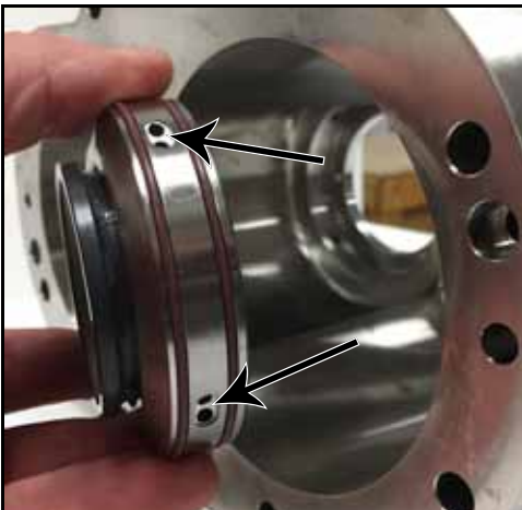
Figure 76 – Installation du couvercle de la garniture dans le corps de la pompe
