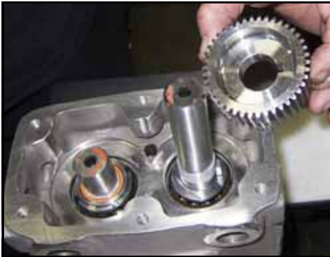
Figure 202 – Installation de l'engrenage d'entraînement
