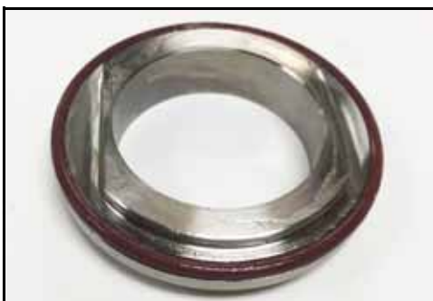
Figure 98 – Joint torique entre le bouchon et le siège installé
