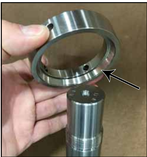
Figure 157 – Placement de l'entretoise de roulement sur l'arbre
