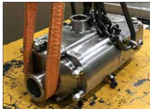
Figure 2 – Détail des points de levage – Modèles 015, 030-UTS
