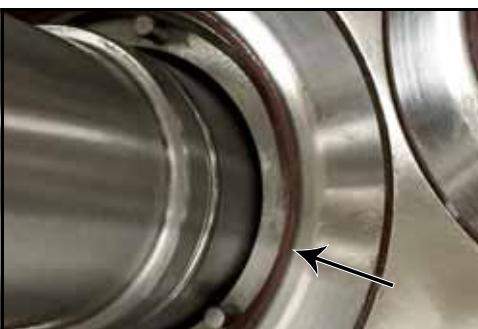
Figure 49 – Dépose du joint torique entre le couvercle et la garniture
