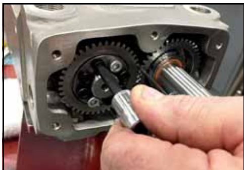
Figure 137 – Desserrage des boulons du dispositif de blocage
