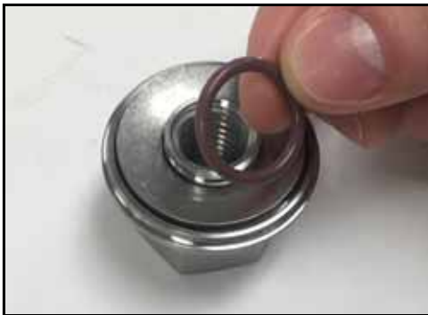
Figure 39 – Dépose du joint torique de retenue de la rondelle
