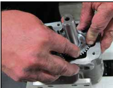
Figure 203 – Installation de l'engrenage d'entraînement
