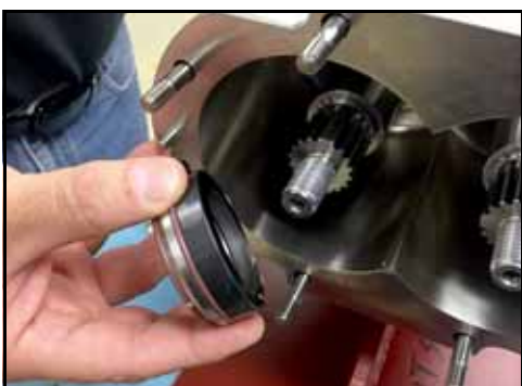
Figure 43 – Dépose du bouchon de la garniture
