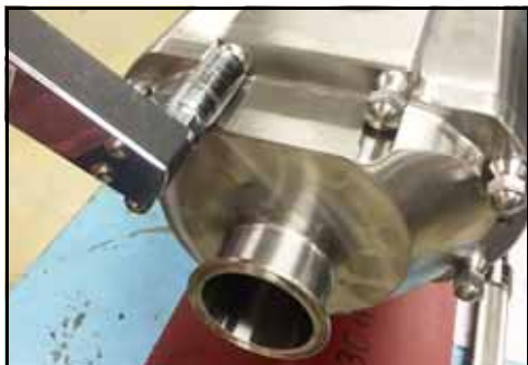
Figure 27 – Retrait des écrous du couvercle
