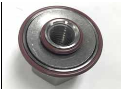
Figure 117 – Écrou du rotor complet
