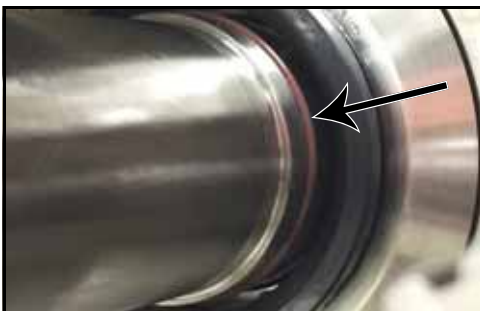
Figure 91 – Installation du joint torique de l'arbre
