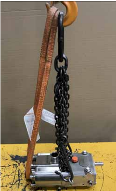
Figure 1 – Points de levage – Modèles 015, 030-UTS
