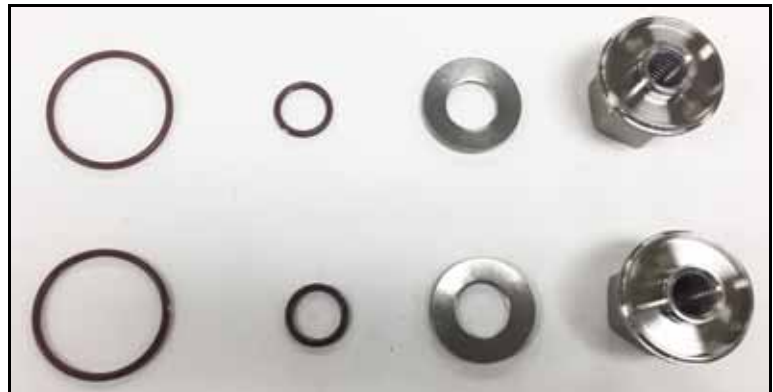
Figure 112 – Composants de l'écrou du rotor
