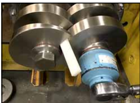
Figure 36 – Insertion de l'outil de blocage
