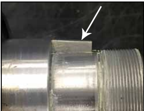
Figure 183 – Positionnement de la clavette
