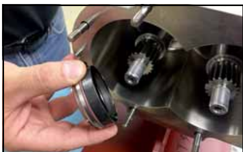
Figure 103 – Installation du bouchon de la garniture
