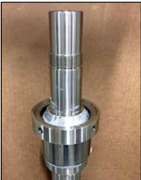
Figure 158 – Entretoise de roulement installée
