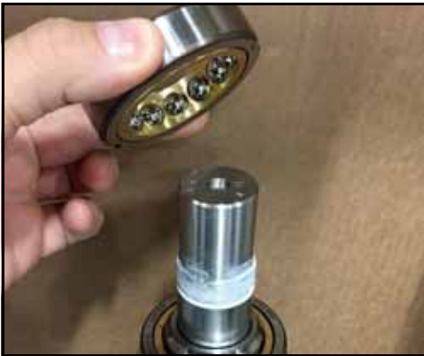
Figure 170 – Placement du roulement sur la bague
