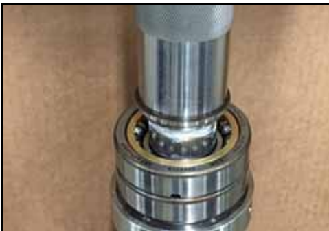
Figure 172 – Enfoncement de la bague dans le roulement à l'aide de la presse
