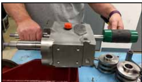
Figure 145 – Tapotage de l'arbre d'entraînement hors du carter d'engrenages
