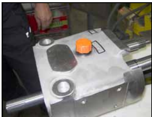
Figure 208 – Installation du bouchon du reniflard d'huile
