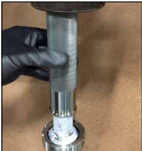
Figure 163 – Enfoncement de la bague sur l'arbre à l'aide de la presse
