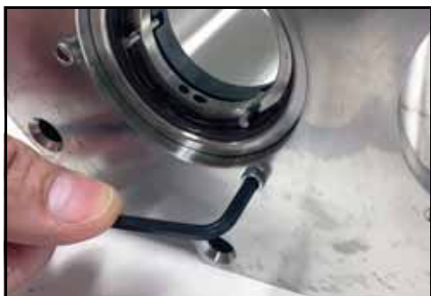
Figure 56 - Dépose des vis d'assemblage
