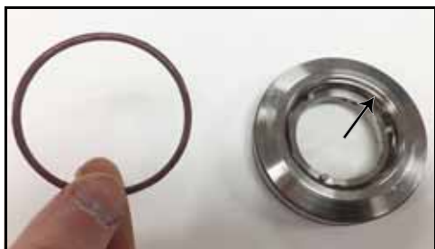
Figure 69 – Joint torique entre le couvercle et la garniture
