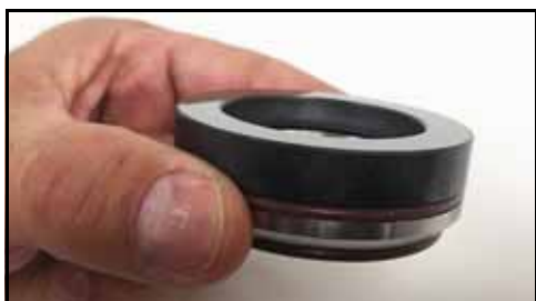
Figure 102 – Siège de la garniture placé sur le bouchon de la garniture
