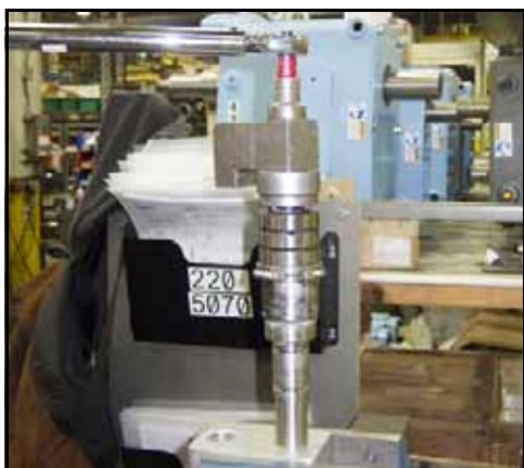
Figure 179 – Serrage du contre-écrou
