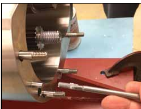
Figure 51 – Dépose des vis de fixation du corps de la pompe
