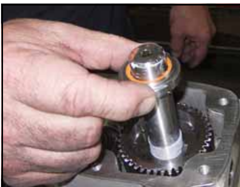
Figure 204 – Installation du contre-écrou
