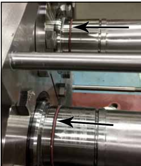
Figure 84 – Installation des joints toriques d'arbre
