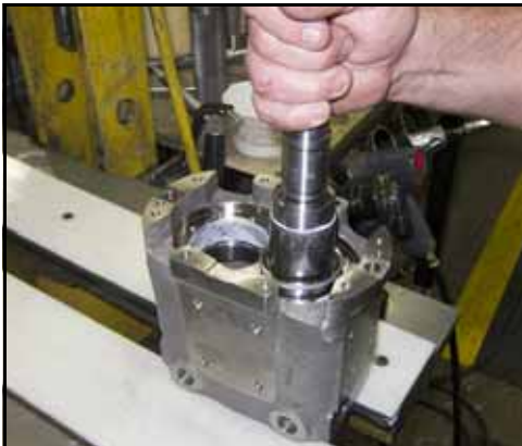
Figure 186 – Placement de l'arbre court dans l'alésage
