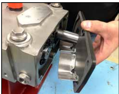
Figure 235 – Installation du couvercle du carter d'engrenages
