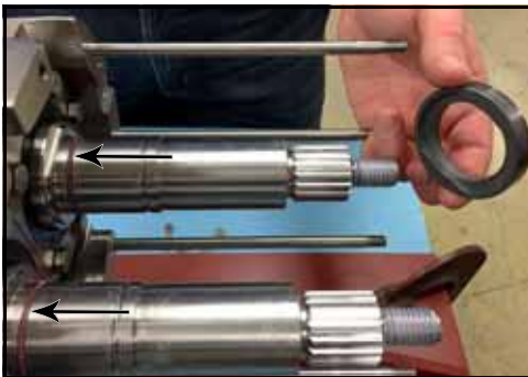
Figure 54 – Dépose des joints toriques d'arbre
