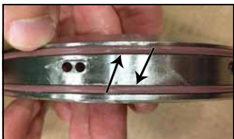
Figure 62 – Joints toriques entre le couvercle et le corps
