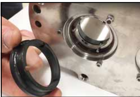
Figure 55 – Dépose de la garniture
