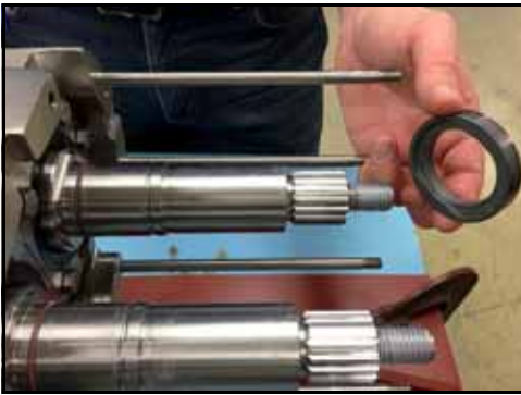
Figure 85 – Installation des sièges des garnitures
