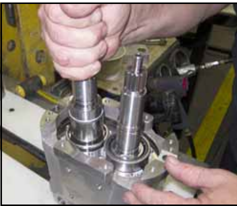
Figure 189 – Placement de l'arbre d'entraînement dans l'alésage
