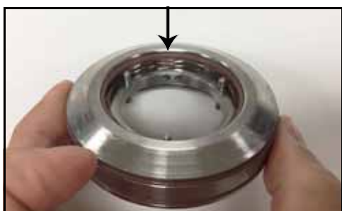
Figure 59 – Joint torique entre le couvercle et la garniture en place
