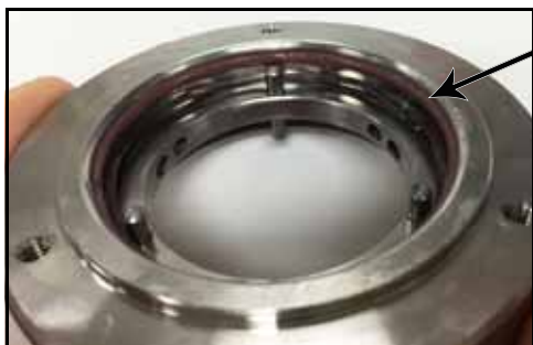
Figure 72 – Joint torique entre le couvercle et la garniture en place
