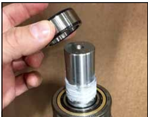
Figure 175 – Placement de la bague sur l'arbre
