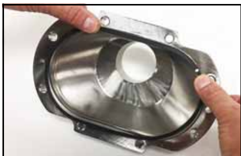
Figure 29 – Retrait du joint d'étanchéité du couvercle
