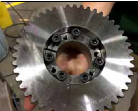
Figure 212 – Placement du dispositif de blocage dans l'engrenage
