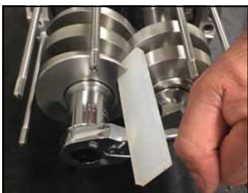
Figure 219 – Installation des écrous de rotor
