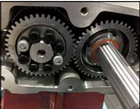
Figure 214 – Alignement de l'engrenage desserré sur l'engrenage d'entraînement
