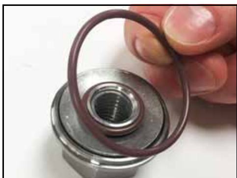
Figure 116 – Installation du joint torique de l'écrou du rotor
