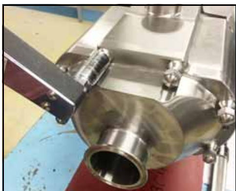
Figure 132 – Serrage des écrous du couvercle
