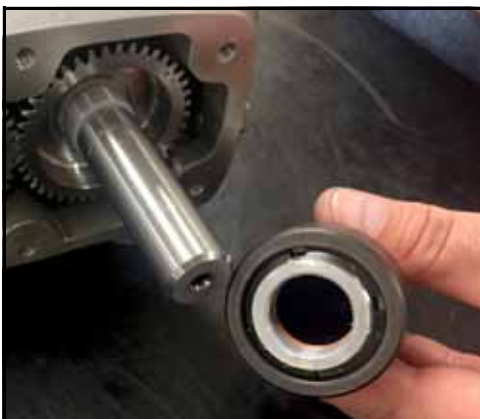
Figure 142 – Dépose du contre-écrou et de l'engrenage
