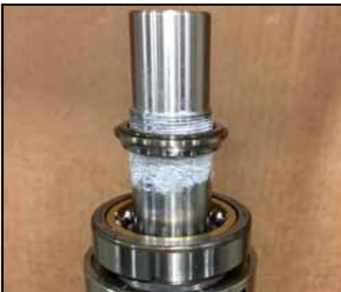
Figure 171 – Placement de la bague sur l'arbre
