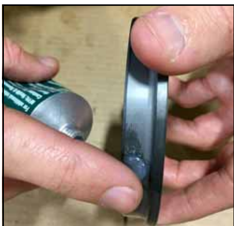
Figure 81 – Lubrification du diamètre extérieur de la garniture
