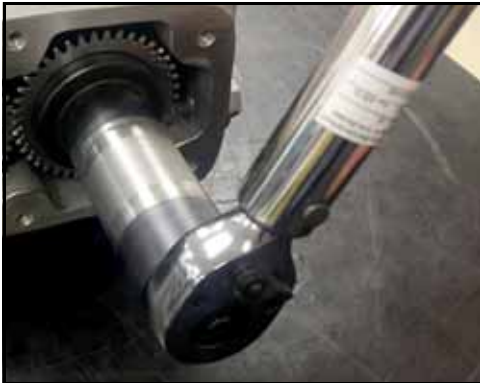
Figure 141 – Desserrage du contre-écrou
