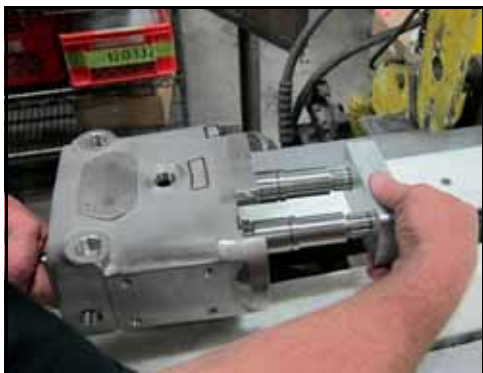
Figure 206 – Blocage des arbres
