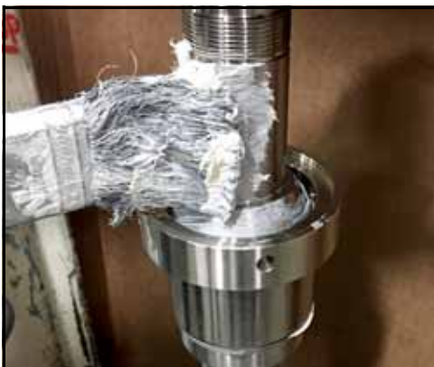
Figure 161 – Application d'antigrippant sur l'arbre
