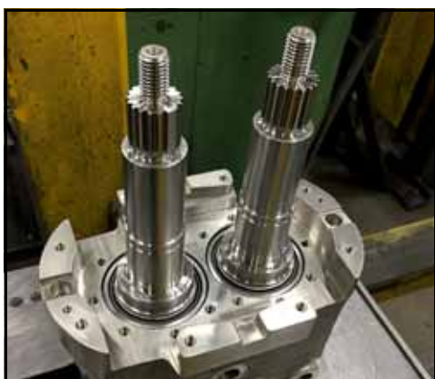
Figure 192 – Arbres installés dans le carter d'engrenages
