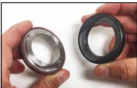
Figure 44 – Désolidarisation du siège de la garniture et du bouchon de la garniture
