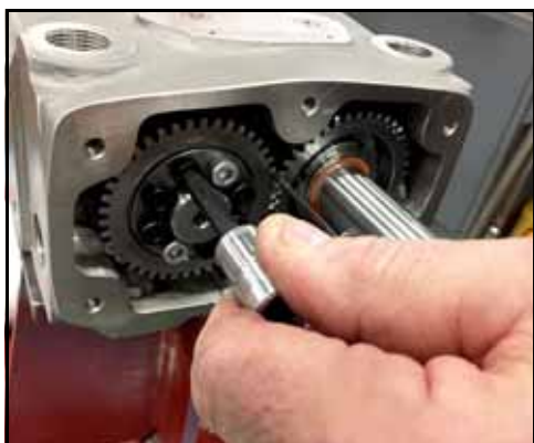
Figure 226 – Serrage à la main des boulons du dispositif de blocage
