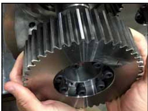
Figure 139 – Dépose de l'engrenage
