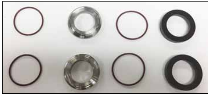
Figure 96 – Composants du bouchon de la garniture
