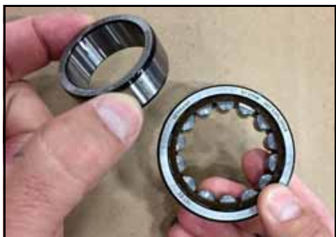
Figure 174 – Dépose de la bague du roulement
