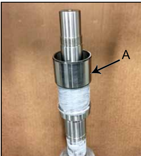
Figure 154 – Placement de la bague interne sur l'arbre
