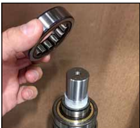
Figure 177 – Placement du roulement sur la bague
