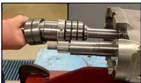
Figure 146 – Sortie de l'arbre d'entraînement hors du carter d'engrenages
