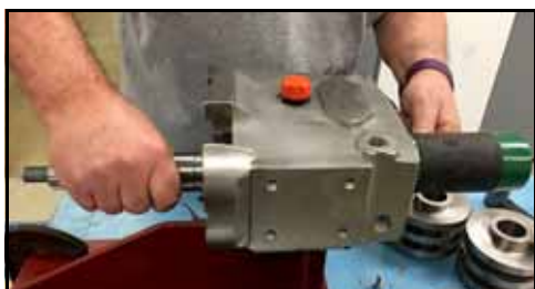
Figure 147 – Tapotage de l'arbre court hors du carter d'engrenages
