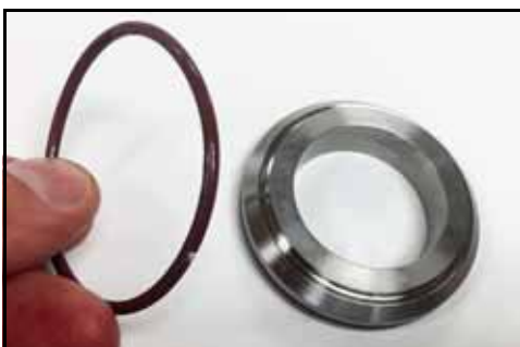
Figure 99 – Installation du joint torique entre le bouchon et le rotor
