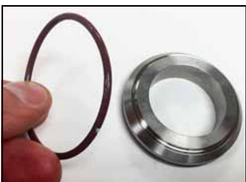
Figure 45 – Dépose du joint torique entre le bouchon et le rotor
