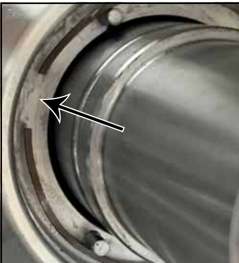
Figure 68 – Position du ressort ondulé de la garniture
