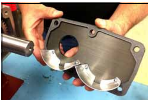
Figure 234 – Placement du joint d'étanchéité sur le couvercle
