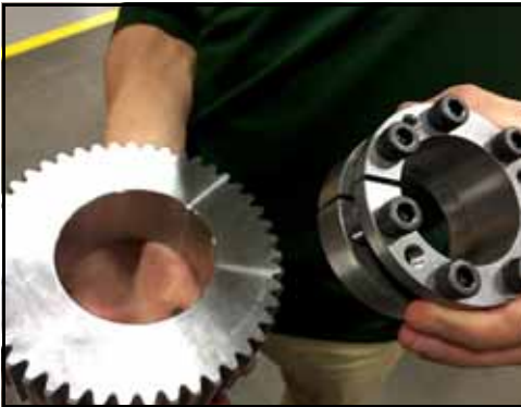
Figure 211 – Assemblage du dispositif de blocage dans l'engrenage
