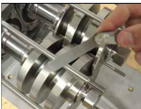
Figure 223 – Choix d'une jauge d'épaisseur
