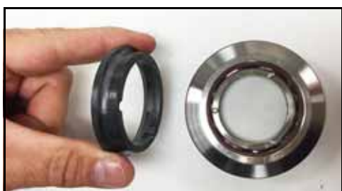
Figure 58 – Dépose de la garniture
