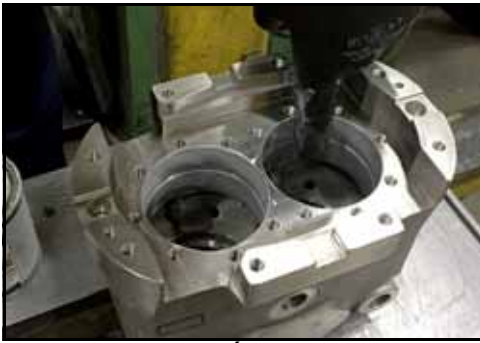
Figure 185 – Étalement d'une couche homogène
