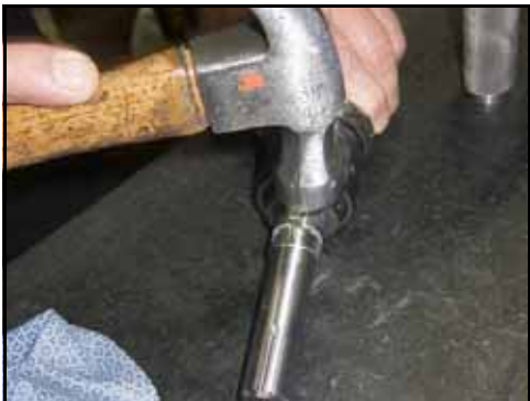
Figure 182 – Tapotage de la clavette pour l'enfoncer dans la rainure de clavette
