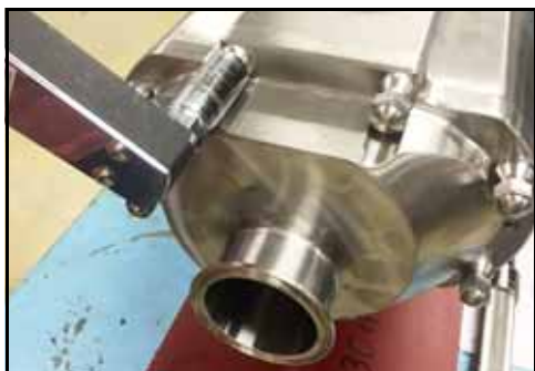
Εικόνα 27 - Αφαίρεση περικοχλίων καλύμματος
