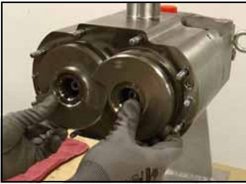
Εικόνα 109 - Τοποθετήστε τους κοχλίες
