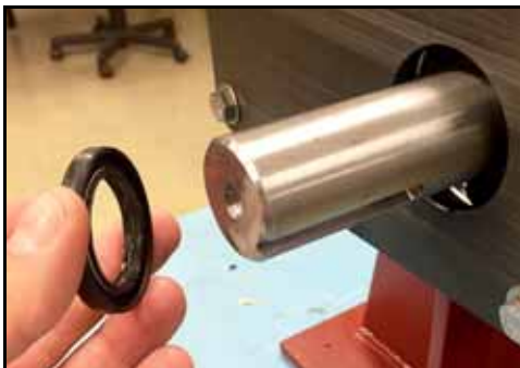
Εικόνα 238 - Τοποθετήστε το παρέμβυσμα του λαδιού
