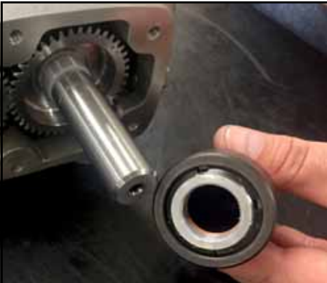
Εικόνα 142 - Αφαιρέστε το παξιμάδι ασφάλισης και το γρναζί
