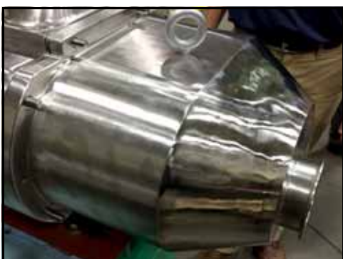
Εικόνα 130 - Τοποθετήστε το κάλυμμα της αντλίας πάνω στο σώμα της
