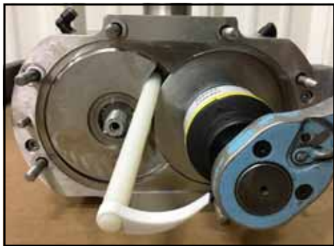
Εικόνα 34 - Τοποθετήστε τον πίρο
