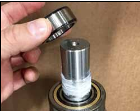
Εικόνα 175 - Τοποθετήστε τον δακτύλιο στον άξονα
