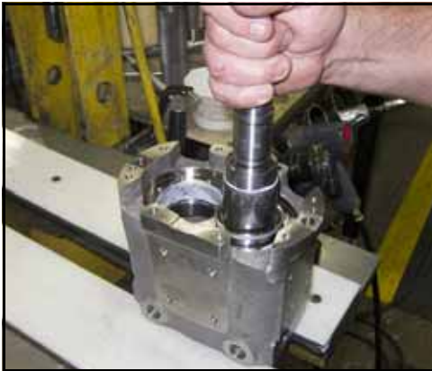
Εικόνα 186 - Τοποθετήστε τον βραχύ άξονα στην εσωτερική διάμετρο
