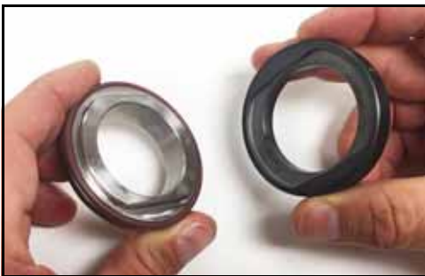
Εικόνα 44 - Αφαιρέστε την έδρα του παρεμβύσματος από το καπάκι στεγάνωσης
