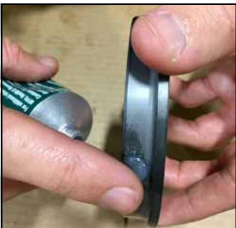
Εικόνα 81 - Λιπάνετε την εξωτερική διάμετρο του παρεμβύσματος
