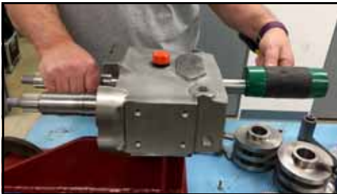
Εικόνα 145 - Χτυπήστε τον κινητήριο άξονα ώστε να βγει από το κιβώτιο των γραναζιών
