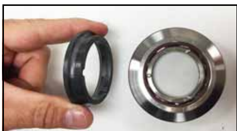
Εικόνα 58 - Αφαιρέστε το παρέμβυσμα
