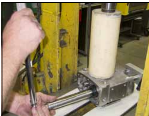
Εικόνα 207 - Στρέψτε το περικόχλιο ασφάλισης
