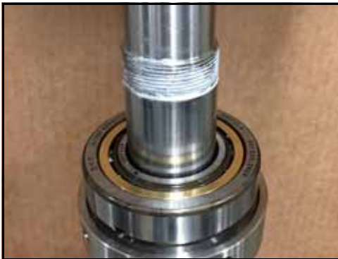
Εικόνα 167 - Δακτύλιος τοποθετημένος στον άξονα
