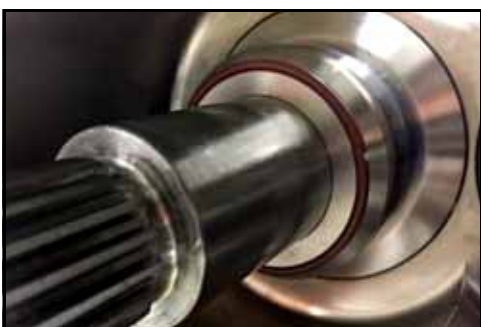
Εικόνα 104 - Καπάκι στεγάνωσης τοποθετημένο στον άξονα
