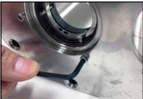
Εικόνα 80 - Τοποθετήστε με τα καλύμματα των κοχλίων.
