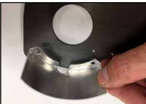
Εικόνα 230 - Ευθυγραμμίστε τις οπές των κοχλιών
