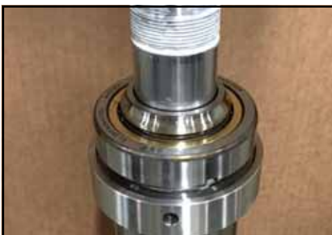
Εικόνα 169 - Περάστε τον δακτύλιο στο ρουλεμάν
