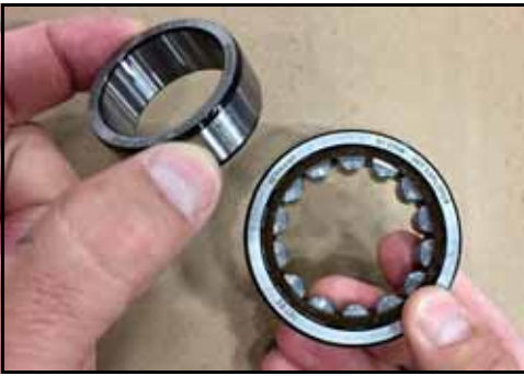
Εικόνα 174 - Αφαιρέστε τον δακτύλιο από το ρουλεμάν
