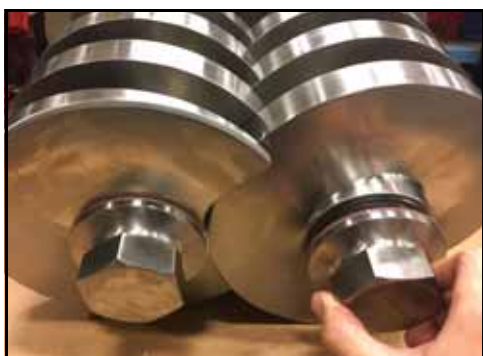
Εικόνα 37 - Αφαιρέστε τα περικόχλια
