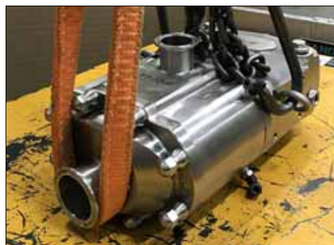
Εικόνα 2 - Θέση ανύψωσης, λεπτομέρεια - 015, 030-UTS
