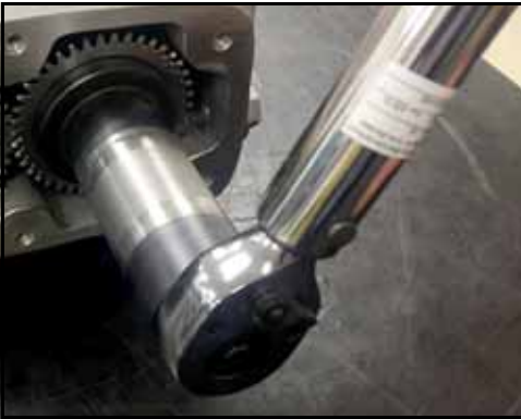
Εικόνα 141 - Χαλαρώστε το περικόχλιο ασφάλισης
