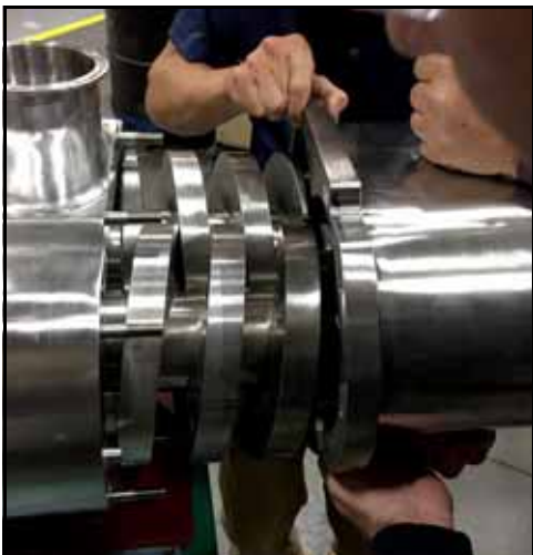
Εικόνα 129 - Τοποθετήστε το κάλυμμα της αντλίας (μοντέλο 220-UTS)
