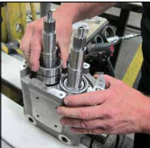
Εικόνα 190 - Τοποθετήστε τον εξωτερικό δακτύλιο στον άξονα
