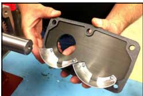
Εικόνα 234 - Τοποθετήστε τη φλάντζα στο κάλυμμα
