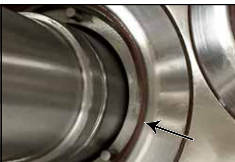
Εικόνα 49 - Αφαιρέστε τον δακτύλιο στεγανοποίησης του μεταφορέα
