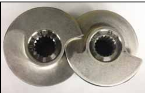
Εικόνα 107 - Βάλτε τους κοχλίες σε σωστή σειρά LH-RH
