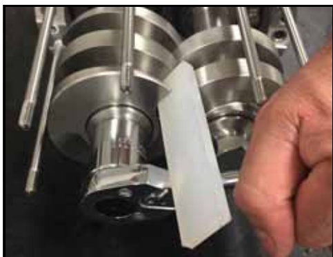
Εικόνα 219 - Τοποθετήστε τα περικόχλια
