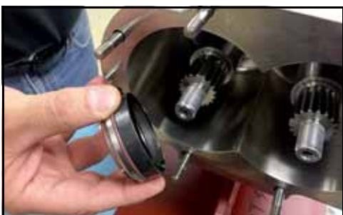
Εικόνα 103 - Τοποθέτηση καπακιού στεγάνωσης
