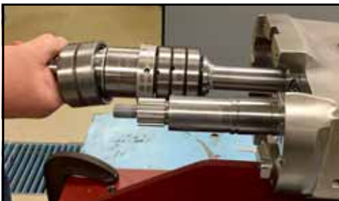
Εικόνα 146 - Τραβήξτε τον άξονα από το κιβώτιο των γραναζιών
