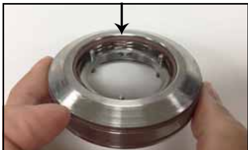
Εικόνα 70 - Τοποθετημένος δακτύλιος στεγανοποίησης του μεταφορέα
