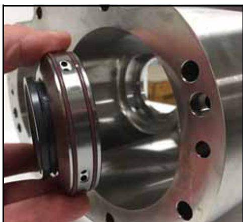
Εικόνα 57 - Αφαιρέστε τους μεταφορείς του παρεμβύσματος από το σώμα
