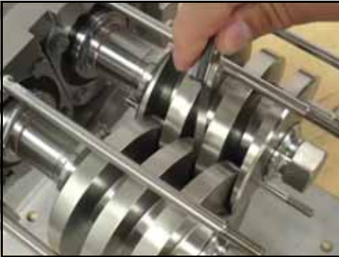
Εικόνα 222 - Μετρήστε το διάκενο
