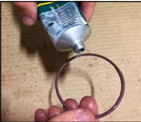
Εικόνα 83 - Λιπάνετε τους δακτυλίους
