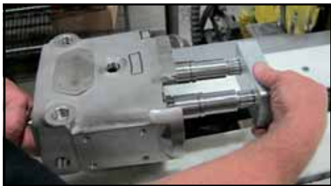
Εικόνα 136 - Μπλοκάρτε τους άξονες
