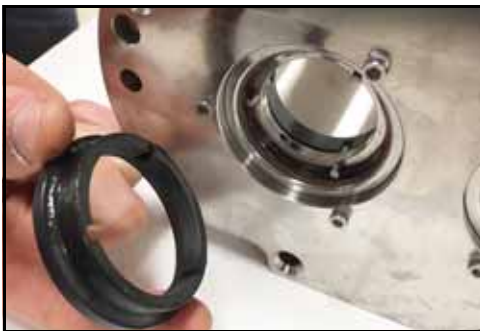
Εικόνα 55 - Αφαιρέστε το παρέμβυσμα
