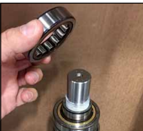
Εικόνα 177 - Τοποθετήστε το ρουλεμάν στον δακτύλιο
