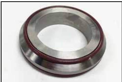
Εικόνα 100 - Τοποθετημένος δακτύλιος βιδωτού καπακιού
