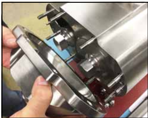
Εικόνα 28 - Αφαιρέστε το κάλυμμα της αντλίας
