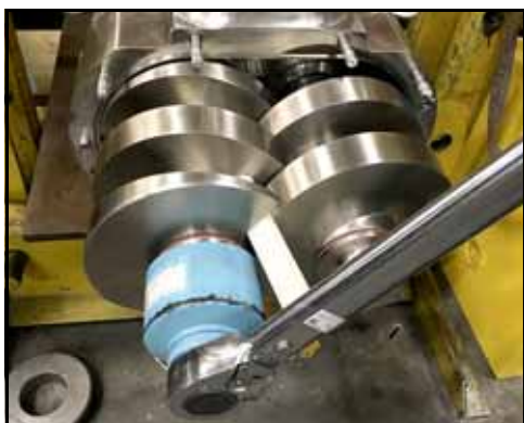
Εικόνα 125 - Περιστρέψτε το αριστερό περικόχλιο
