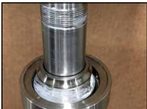
Εικόνα 164 - Δακτύλιος πιεσμένος στον άξονα
