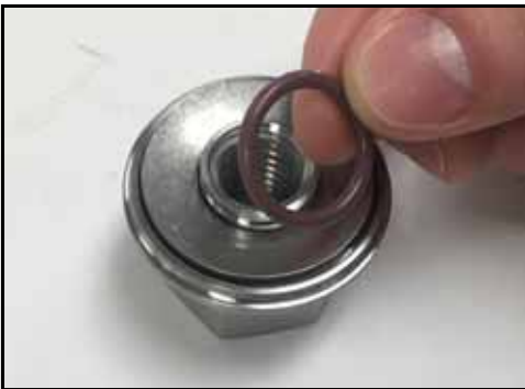
Εικόνα 39 - Αφαιρέστε τον δακτύλιο συγκράτησης της ροδέλας
