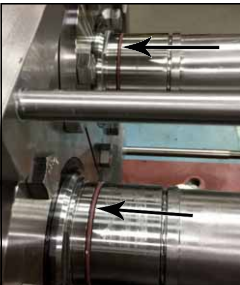
Εικόνα 84 - Τοποθετήστε τους δακτυλίους του άξονα
