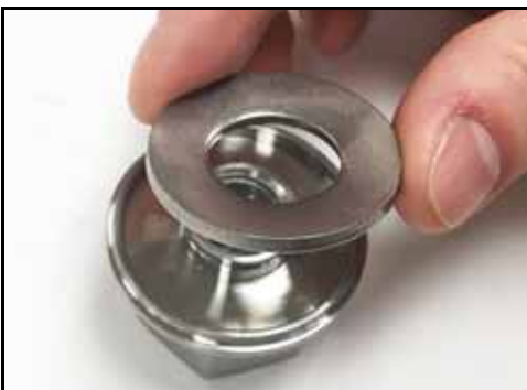
Εικόνα 40 - Τοποθετήστε τη ροδέλα belleville
