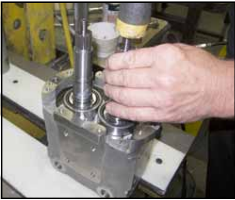
Εικόνα 191 - Χτυπήστε τους άξονες για να τους κεντράρετε στην εσωτερική διάμετρο.
