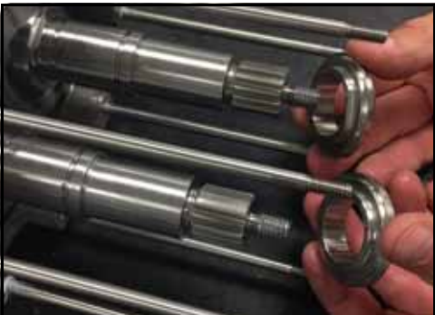
Εικόνα 215 - Τοποθετήστε τα καλύμματα στεγάνωσης
