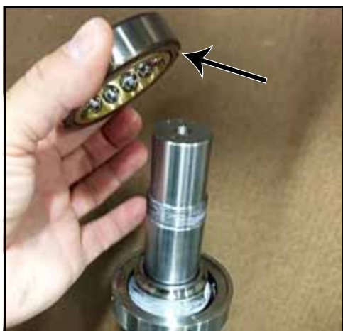
Εικόνα 165 - Τοποθετήστε το ρουλεμάν στον δακτύλιο
