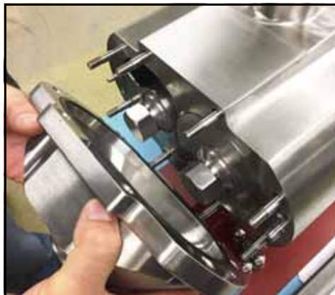
Εικόνα 128 - Τοποθετήστε το κάλυμμα της αντλίας
