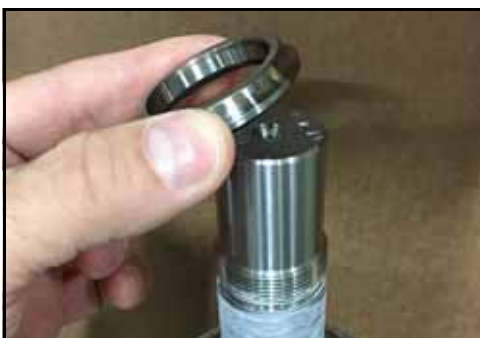
Εικόνα 162 - Τοποθετήστε τον δακτύλιο στον άξονα
