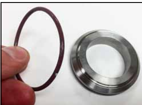
Εικόνα 45 - Αφαιρέστε τον δακτύλιο του βιδωτού καπακιού
