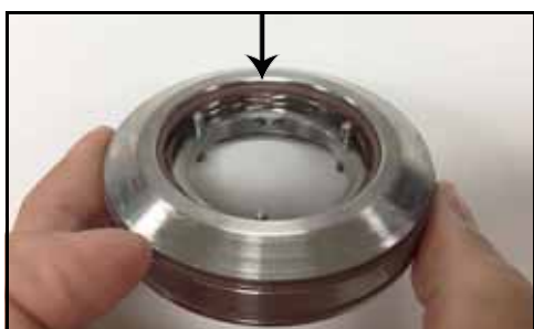
Εικόνα 59 - Τοποθετημένος δακτύλιος στεγανοποίησης του μεταφορέα
