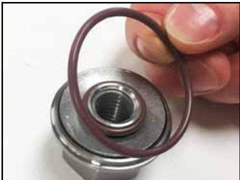
Εικόνα 116 - Τοποθετήστε τον δακτύλιο του περικοχλίου
