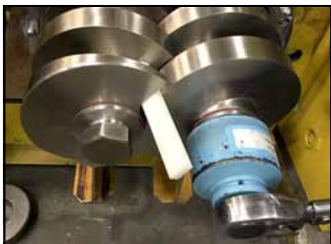
Εικόνα 36 - Τοποθετήστε τη σφήνα
