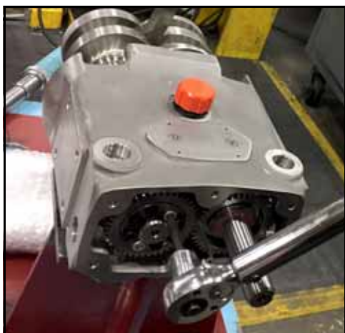
Εικόνα 227 - Στρέψτε τα μπουλόνια του συγκροτήματος ασφάλισης
