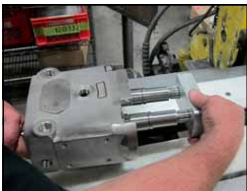
Εικόνα 206 - Μπλοκάρτε τους άξονες
