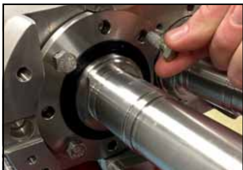
Εικόνα 200 - Τοποθετήστε τους κοχλίες
