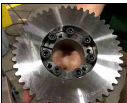
Εικόνα 212 - Τοποθετήστε το συγκρότημα ασφάλισης στο γρανάζι
