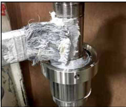
Εικόνα 161 - Εφαρμόστε αντιπριβικό στον άξονα
