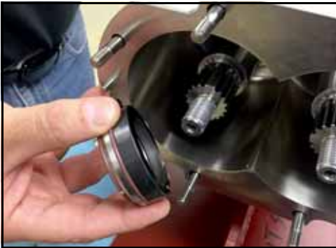
Εικόνα 43 - Αφαιρέστε το καπάκι στεγάνωσης
