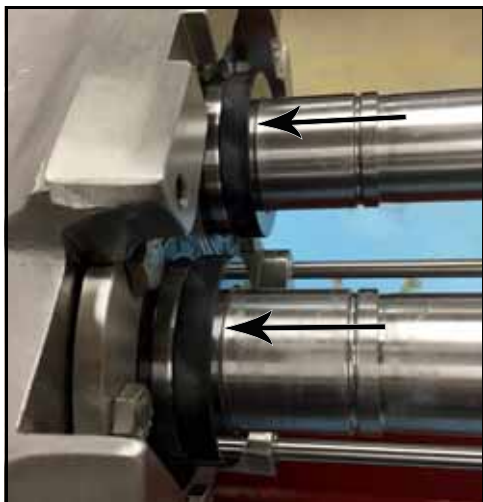
Εικόνα 86 - Τοποθετημένες έδρες παρεμβυσμάτων
