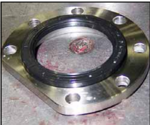
Εικόνα 193 - Κεντράρετε το παρέμβυσμα του εξαρτήματος συγκράτησης του ρουλεμάν
