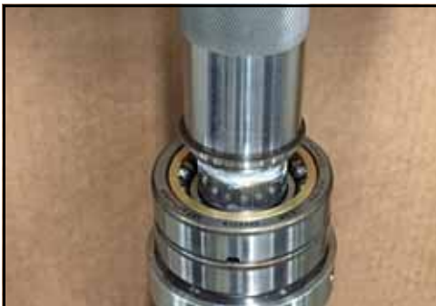
Εικόνα 172 - Περάστε τον δακτύλιο στο ρουλεμάν
