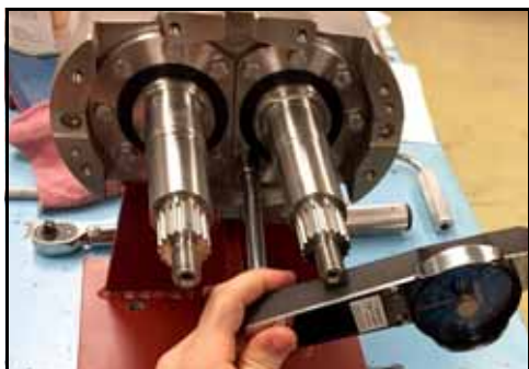
Εικόνα 201 - Στρέψτε τους κοχλίες συγκράτησης του ρουλεμάν
