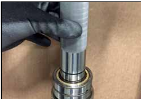
176. ábra – A menet feltolása a tengelyre
