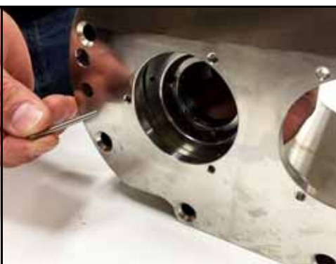
77. ábra – A furatok összeigazításához használjon áttolható tűskét
