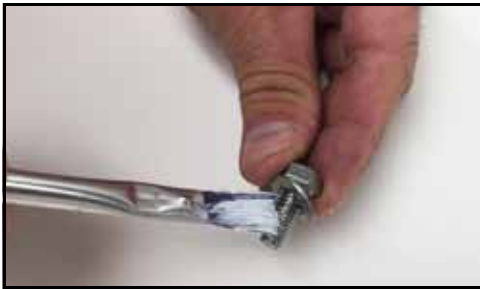
236. ábra – Korróziógátló anyag felvitele
