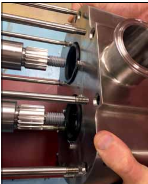
87. ábra – A szivattyúház felszerelése a tengelyekre
