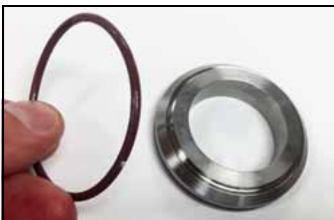
99. ábra – A sapka és a csavar közötti O-gyűrű behelyezése
