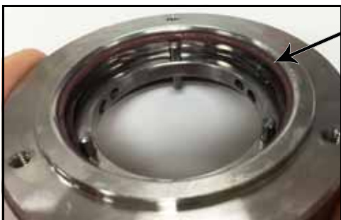
72. ábra – A tartó és a tömítés közötti O-gyűrű a helyén van
