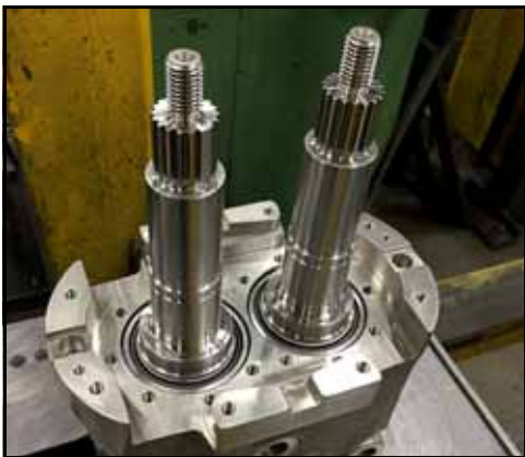
192. ábra – A tengelyek a fogaskerékházban
