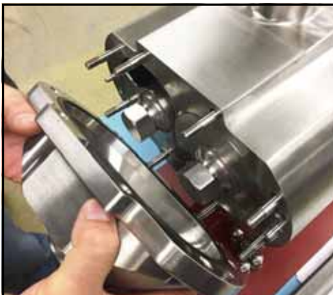
128. ábra – A szivattyúfedél felszerelése
