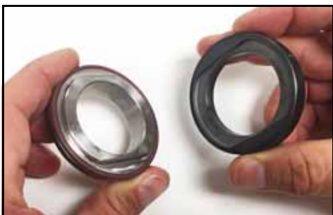
44. ábra – A tömitésfészek eltávolítása a tömitéssapkából
