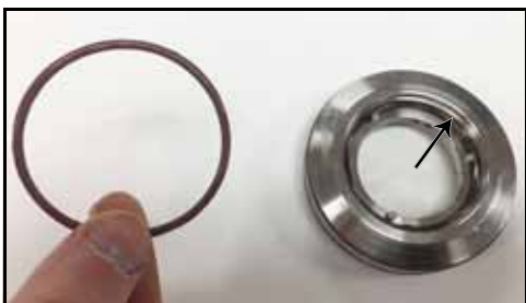
69. ábra – A tartó és a tömítés közötti O-gyűrű
