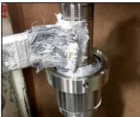
161. ábra – Korróziógátló anyag felvitele a tengelyre
