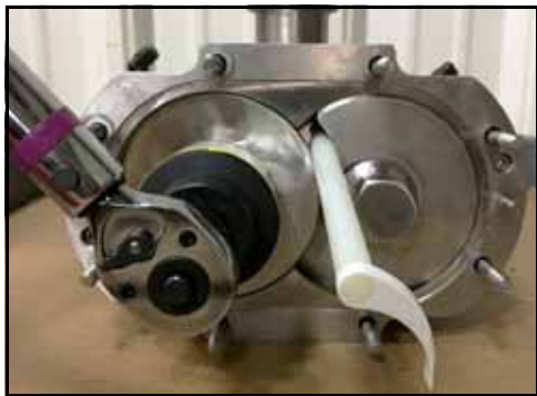
123. ábra – A csap behelyezése
