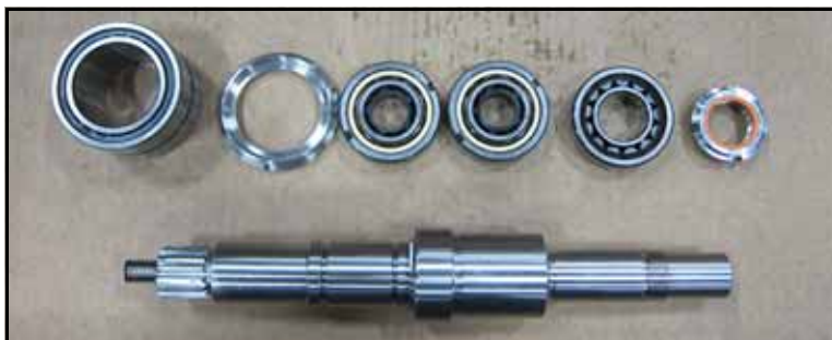
151. ábra – Rövid tengely: Az összeszereléshez szükséges elemek
