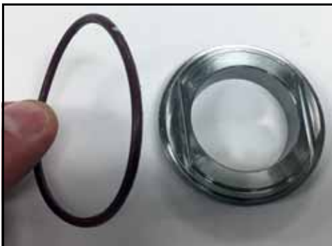
97. ábra – A sapka és a fészek közötti O-gyűrű behelyezése
