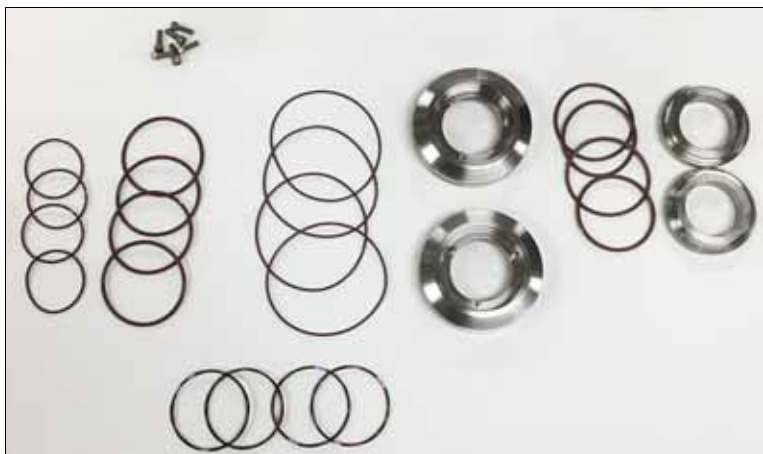
63. ábra – A tömítőegység részei
