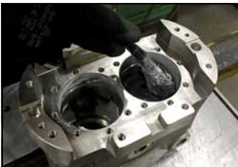
184. ábra – Korróziógátló anyag felvitele
