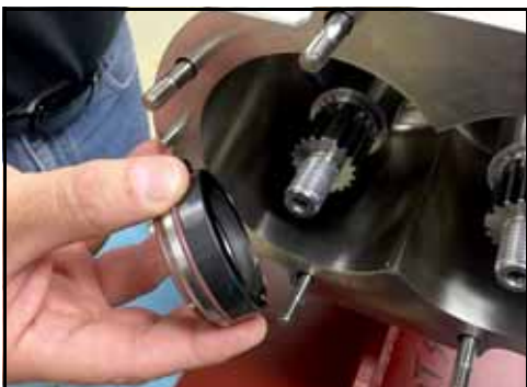
43. ábra – A tömitéssapka-egység eltávolítása
