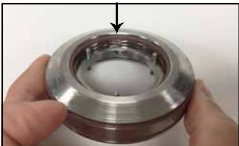
70. ábra – A tartó és a tömítés közötti O-gyűrű a helyén van
