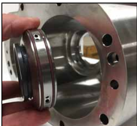
57. ábra – A tömítéstartó eltávolítása a házról
