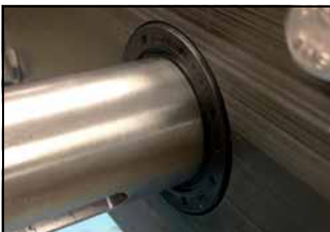
239. ábra – Felhelyezett olajtömítés
