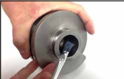
106. ábra – Korróziógátló anyag felvitele
