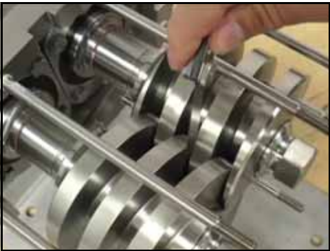
222. ábra – Hézag mérése
