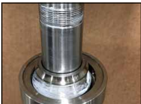
164. ábra – A menet feltolva a tengelyre
