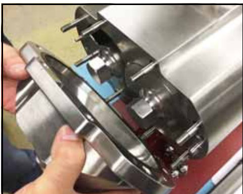
28. ábra – A szivattyúfedél eltávolítása
