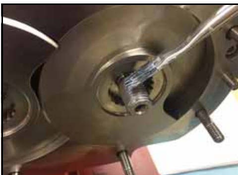
118. ábra – Korróziógátló anyag felvitele
