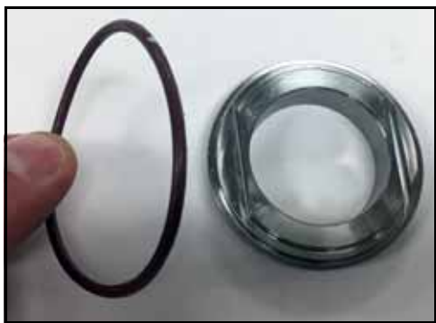
46. ábra – A sapka és a fészek közötti O-gyűrű eltávolítása
