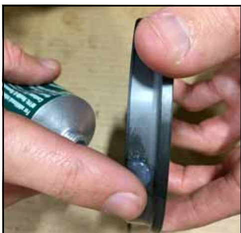
81. ábra – A tömítés külső felületének megkenése
