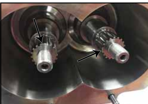
108. ábra – A csavarok és a tengelyborda elrendezése
