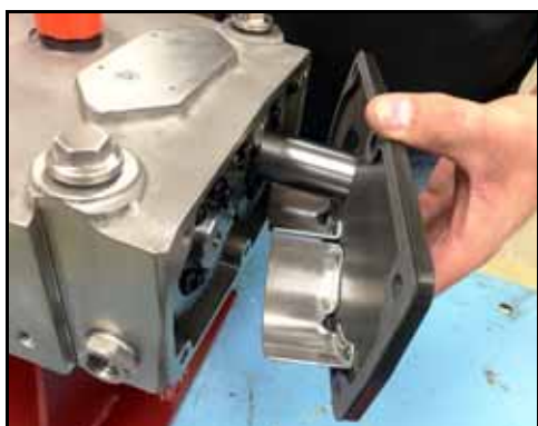
235. ábra – A fogaskerékház fedelének felszerelése
