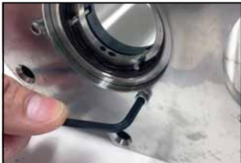
**Figura 80 - Installare con viti a brugola**
