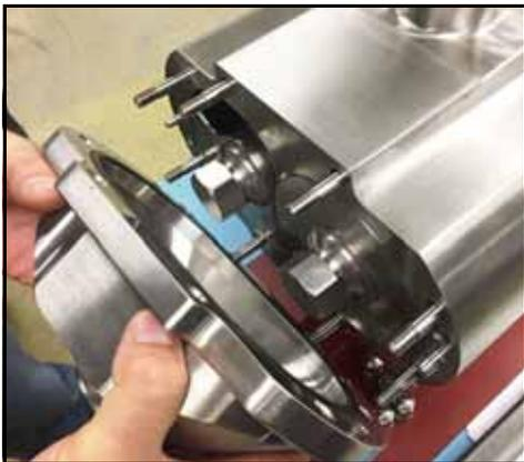
**Figura 128 - Montare il coperchio della pompa**
