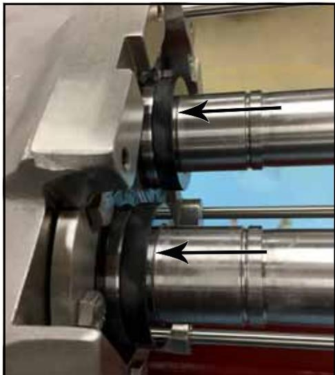
**Figura 53 - Rimuovere le sedi delle tenute**
