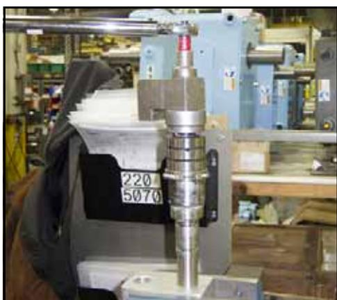
**Figura 179 - Serrare il dado di bloccaggio**
