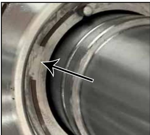
**Figura 92 - Posizione della molla ondolata di tenuta**
