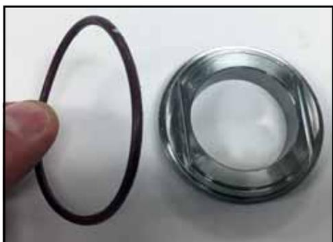
*Figura 97 - Installare l'O-ring tra tappo e tenuta*
