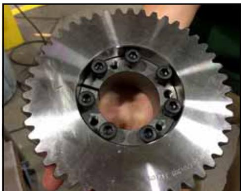
**Figura 212 - Posizionare il gruppo di bloccaggio nell'ingranaggio**
