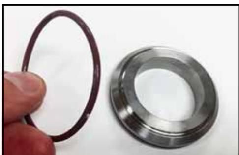
*Figura 99 - Installare l'O-ring tra tappo e vite*
