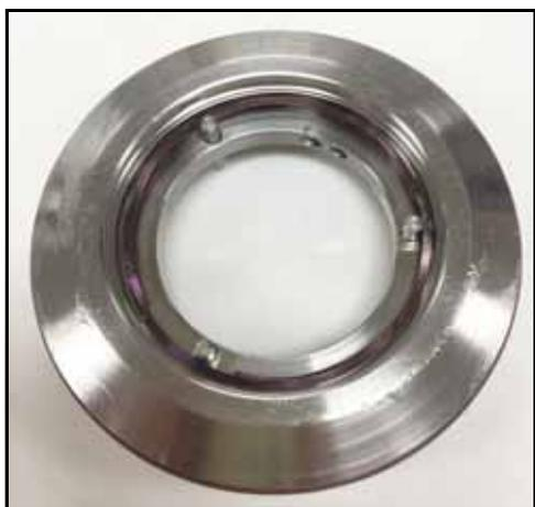
Figura 67 - Molla ondolata di tenuta installata
