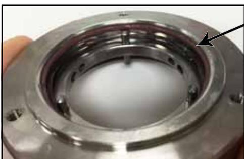
Figura 72 - O-ring tra portatenuta e tenuta installato
