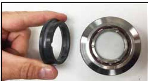
Figura 73 - Lubrificare e installare la tenuta
