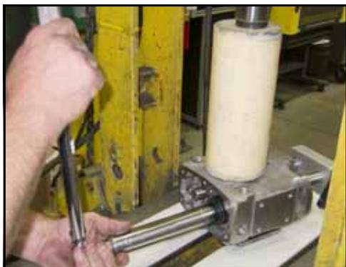
**Figura 207 - Serrare il dado di bloccaggio**
