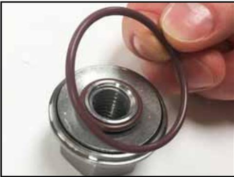
**Figura 38 - Rimuovere l'O-ring del dado della vite**
