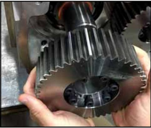
**Figura 213 - Montare gli ingranaggi sugli alberi della pompa**
