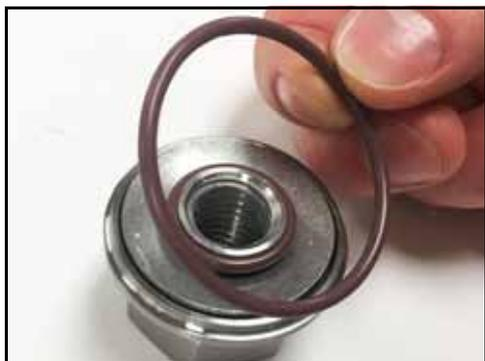
**Figura 116 - Installare l'O-ring del dado della vite**
