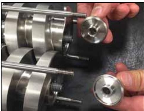
Figura 217 - Installare i dadi delle viti
