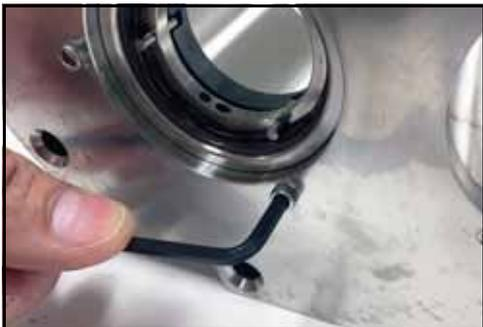
**Figura 56 - Rimuovere le viti a brugola**
