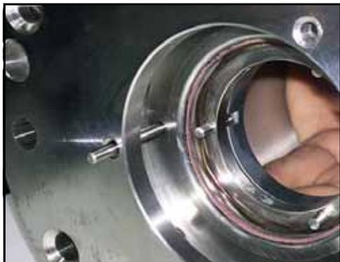
**Figura 78 - Usare un perno cilindrico per allineare i fori**
