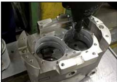
Figura 185 - Spalmare uno strato uniforme
