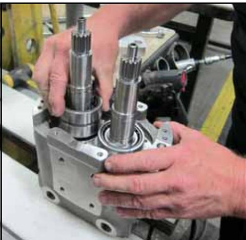
**Figura 190 - Posizionare la pista esterna sull'albero**
