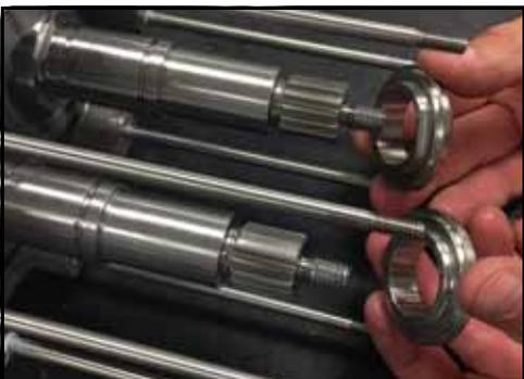
**Figura 215 - Installare i tappi di tenuta**
