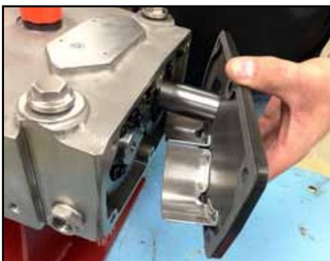
**Figura 135 - Rimuovere il coperchio della scatola ingranaggi**
