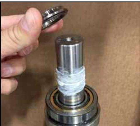
**Figura 168 - Posizionare la pista sull'albero**
