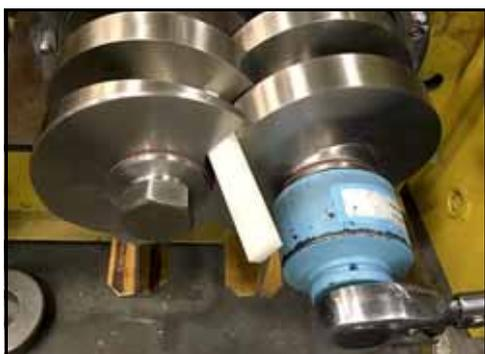
**Figura 36 - Inserire il dispositivo di bloccaggio**
