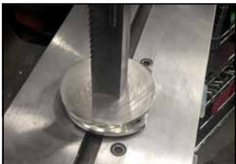
**Figura 194 - Installare la tenuta del fermo del cuscinetto**
