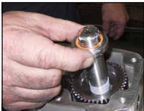
**Figura 204 - Installare il dado di bloccaggio**
