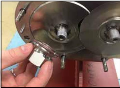
**Figura 119 - Installare i dadi delle viti**
