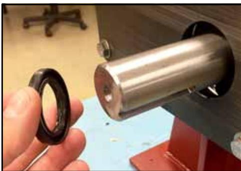
**Figura 238 - Installare la tenuta dell'olio**
