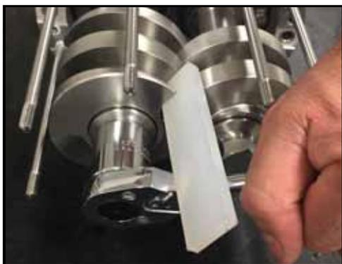
Figura 219 - Installare i dadi delle viti
