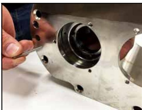
**Figura 77 - Usare un perno cilindrico per allineare i fori**
