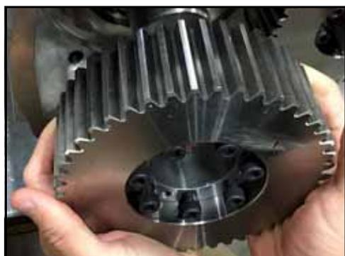
**Figura 139 - Rimuovere l'ingranaggio**
