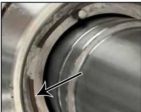
**Figura 50 - Rimuovere la molla ondulata di tenuta**
