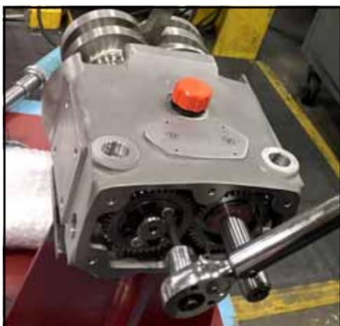
Figura 227 - Serrare i bulloni del gruppo di bloccaggio
