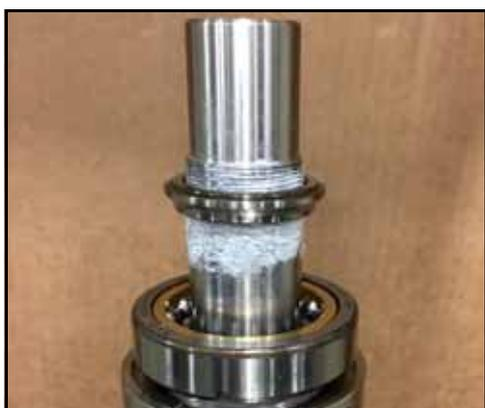
**Figura 171 - Posizionare la pista sull'albero**
