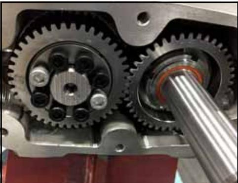
**Figura 214 - Allineare l'ingranaggio allentato con l'ingranaggio conduttore**
