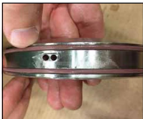
**Figura 65 - O-ring installati**
