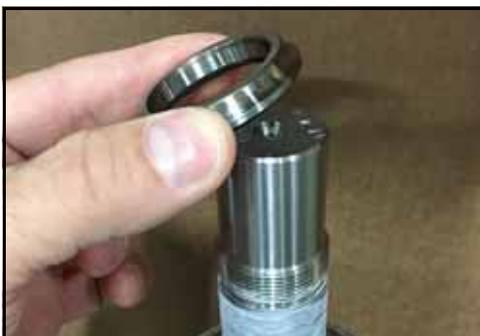
**Figura 162 - Posizionare la pista sull'albero**
