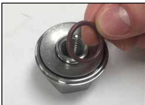
**Figura 114 - Installare l'O-ring di ritegno della rondella**
