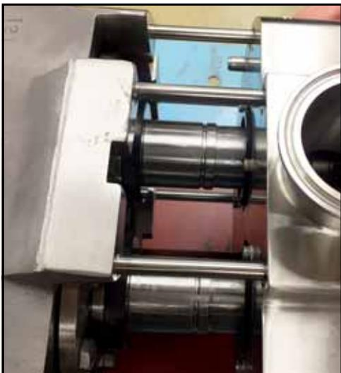
**Figura 52 - Rimuovere il corpo pompa**
