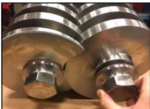
**Figura 37 - Rimuovere i dadi delle viti**
