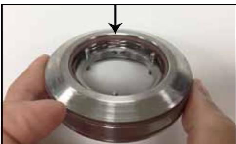
**Figura 59 - O-ring tra portatenuta e tenuta installato**
