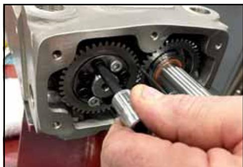
**Figura 137 - Allentare i bulloni del gruppo di bloccaggio**
