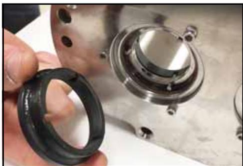
Figura 82 - Installare la tenuta
