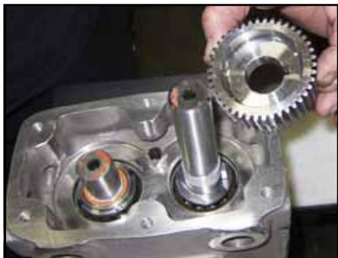
**Figura 202 - Installare l'ingranaggio conduttore**
