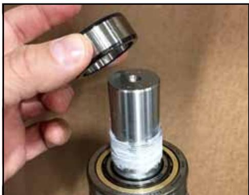
**Figura 175 - Posizionare la pista sull'albero**
