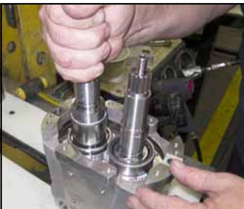
**Figura 189 - Inserire l'albero di trasmissione nel foro**
