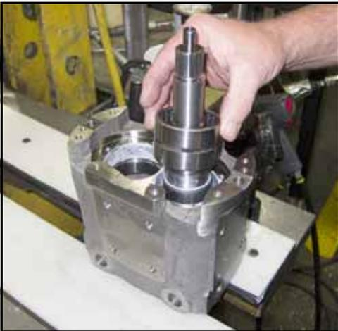
**Figura 188 - Posizionare la pista esterna sull'albero**
