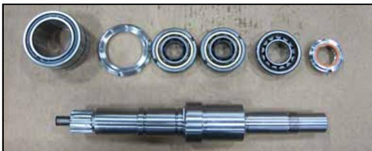
**Figura 151 - Albero corto: elementi di montaggio necessari**
