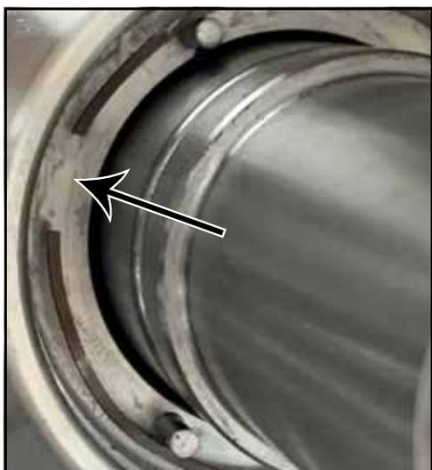
Figura 68 - Posizione della molla ondolata di tenuta
