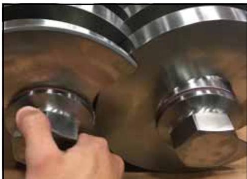
Figura 124 - Installare i dadi delle viti
