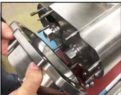
Figura 28 - Rimuovere il coperchio della pompa
