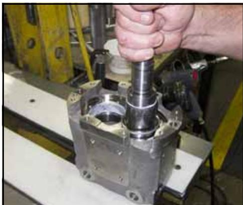
Figura 186 - Inserire l'albero corto nel foro
