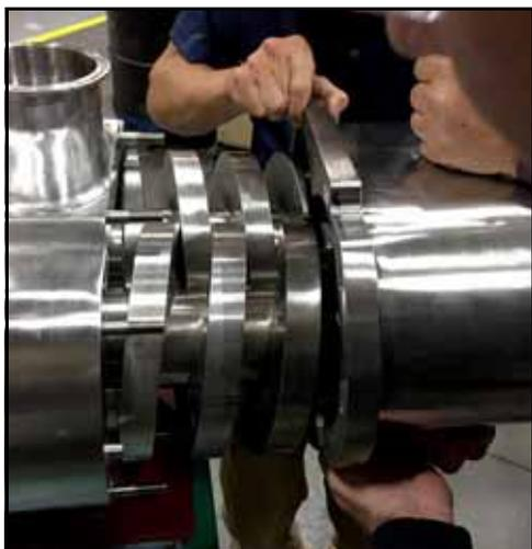
**Figura 129 - Montare il coperchio della pompa 220-UTS**
