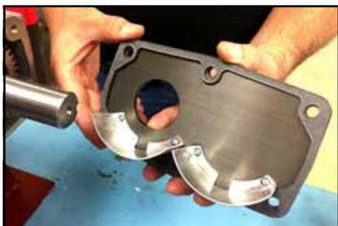
**Figura 234 - Posizionare la guarnizione sul coperchio**
