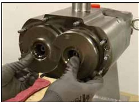
Figura 109 - Installare le viti
