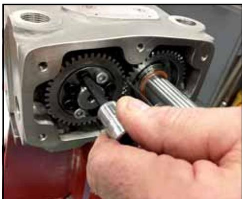
Figura 226 - Serrare manualmente i bulloni del gruppo di bloccaggio
