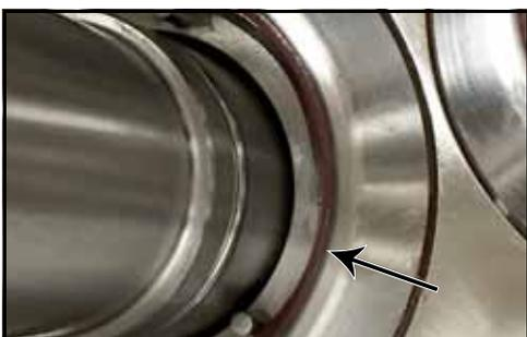
**Figura 93 - Installare l'O-ring tra portatenuta e tenuta**
