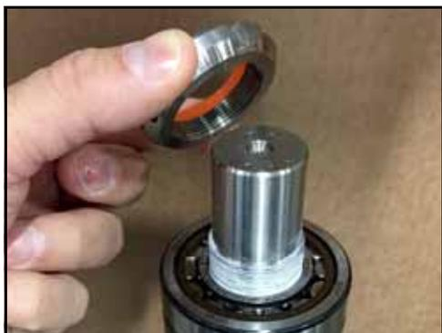
**Figura 178 - Posizionare il dado di bloccaggio sull'albero**
