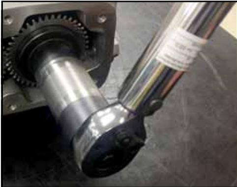
**Figura 141 - Allentare il dado di bloccaggio**
