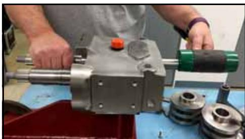
**Figura 145 - Picchiare l'albero di trasmissione per estrarlo dalla scatola ingranaggi**
