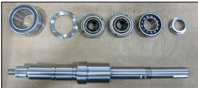
**Figura 150 - Albero di trasmissione: elementi di montaggio necessari**
