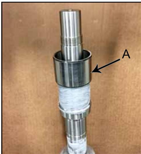
**Figura 154 - Posizionare la pista interna sull'albero**
