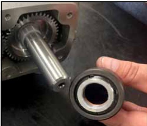
**Figura 142 - Rimuovere dado di bloccaggio e ingranaggio**
