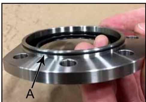
**Figura 197 - O-ring del fermo del cuscinetto installato**
