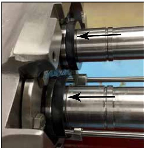
Figura 86 - Sedi delle tenute installate
