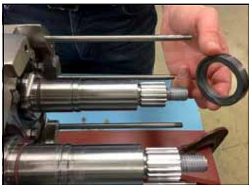
Figura 85 - Installare le sedi delle tenute
