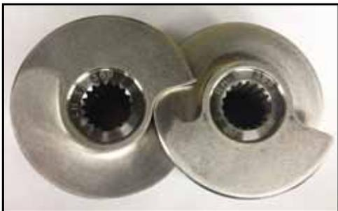
**Figura 42 - Disposizione delle viti contrassegnate LH e RH**
