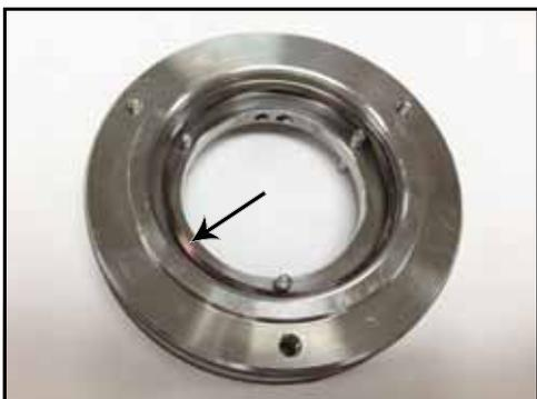
Figura 71 - Molla ondolata di tenuta installata
