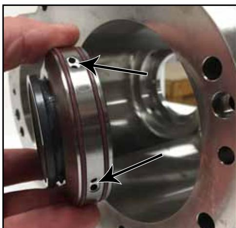
**Figura 76 - Installare il portatenuta nel corpo**
