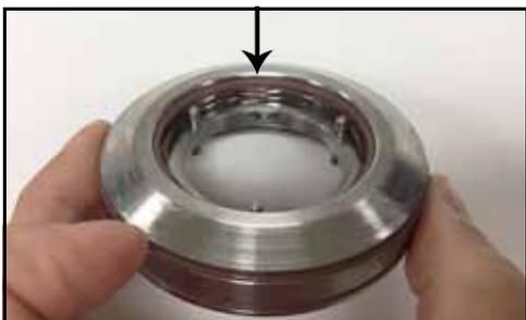
Figura 70 - O-ring tra portatenuta e tenuta installato
