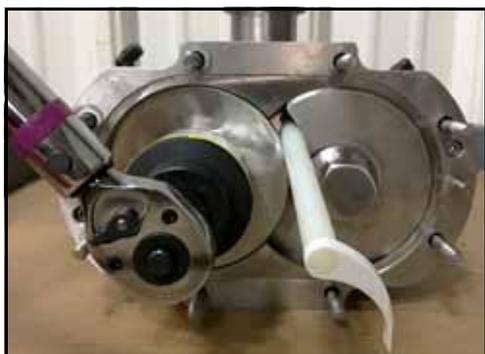
Figura 123 - Inserire il perno
