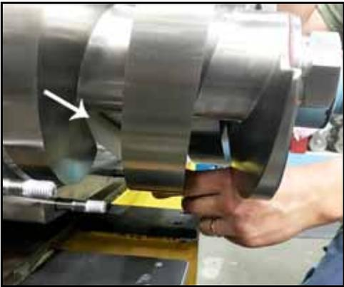
**Figura 126 - Bloccare la vite destra**
