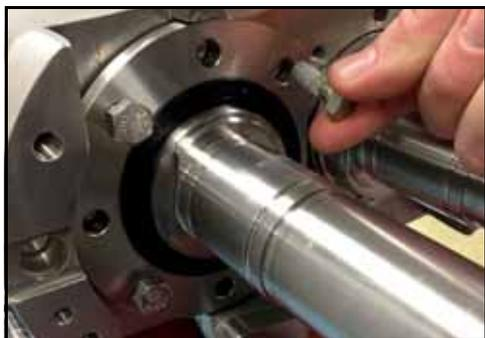
Figura 200 - Installare le viti
