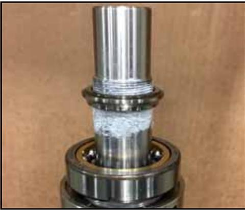
**Figura 166 - Posizionare la pista sull'albero**
