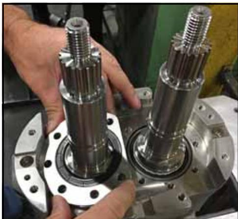
Figura 199 - Installare il fermo del cuscinetto
