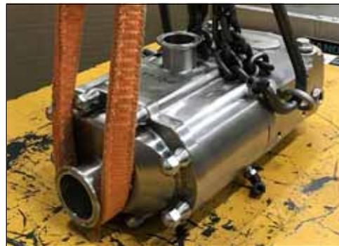
Figura 2 - Dettaglio del punto di sollevamento - 015, 030-UTS
