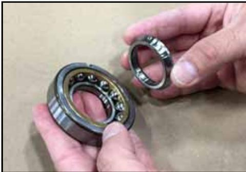
**Figura 160 - Staccare la pista inferiore**
