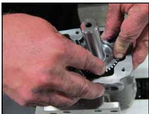
**Figura 203 - Installare l'ingranaggio conduttore**
