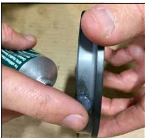
**Figura 81 - Lubrificare il diametro esterno della tenuta**
