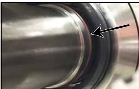
**Figura 91 - Installare l'O-ring dell'albero**
