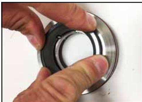
**Figura 74 - Installare la tenuta**
