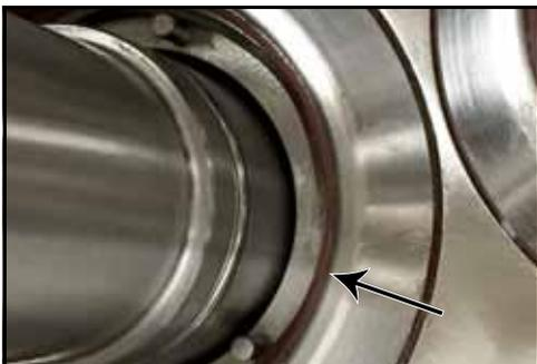
**Figura 49 - Rimuovere l'O-ring tra portatenuta e tenuta**
