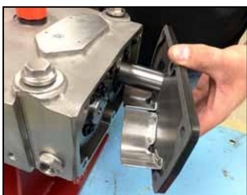
**Figura 235 - Installare il coperchio della scatola ingranaggi**
