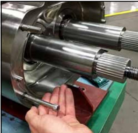
**Figura 90 - Installare le viti di ritegno del corpo**
