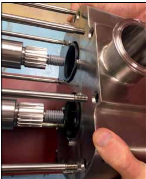
Figura 87 - Installare il corpo pompa sugli alberi
