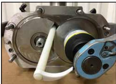
**Figura 34 - Inserire il perno**
