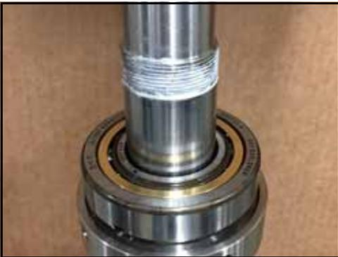
**Figura 167 - Pista installata sull'albero**
