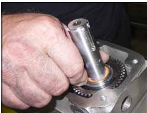
**Figura 205 - Installare il dado di bloccaggio**
