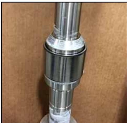
**Figura 156 - Pista interna installata sull'albero**
