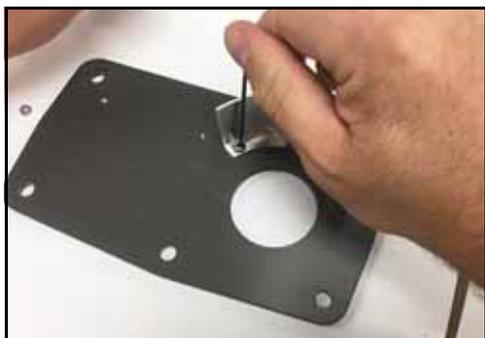
**Figura 232 - Serrare le viti della protezione**
