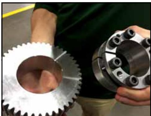
**Figura 211 - Montare il gruppo di bloccaggio nell'ingranaggio**
