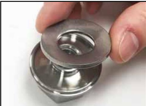
**Figura 40 - Installare la rondella Belleville**
