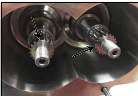
Figura 108 - Allineare le scanalature di viti e alberi
