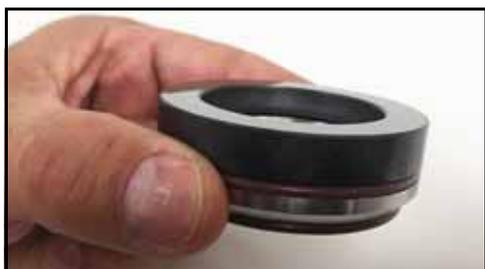
**Figura 102 - Sede della tenuta installata sul tappo di tenuta**
