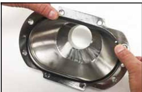
Figura 29 - Rimuovere la guarnizione del coperchio
