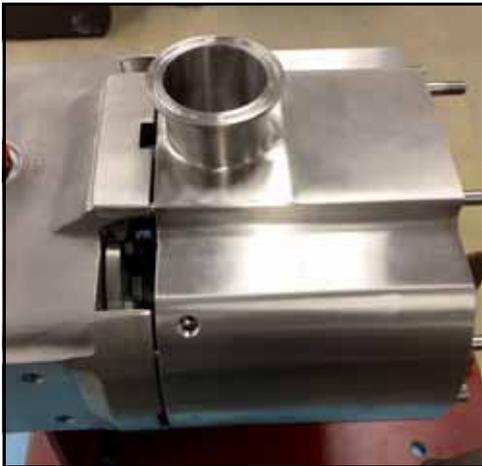
**Figura 88 - Corpo pompa installato**
