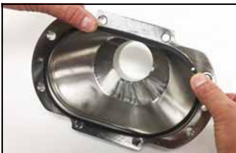
Rysunek 29 — Wyjęcie uszczelnienia pokrywy
