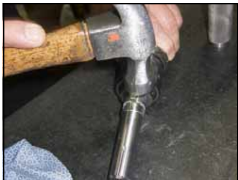
Rysunek 182 — Wstukiwanie klina do rowka
