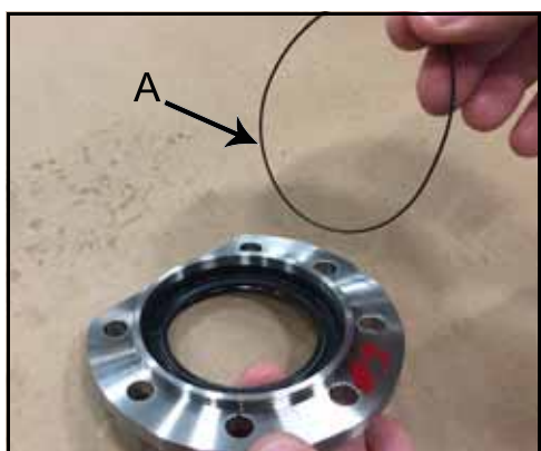
Rysunek 196 — Założenie o-ring koszyka łożyska
