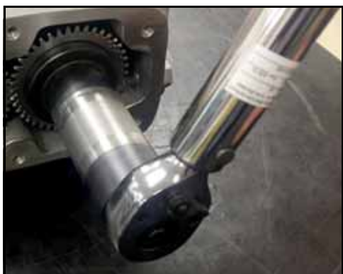
Rysunek 141 — Odkręcenie nakrętki zabezpieczającej
