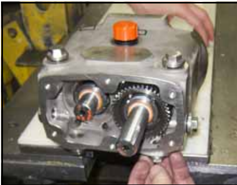
Rysunek 209 — Montaż korków
