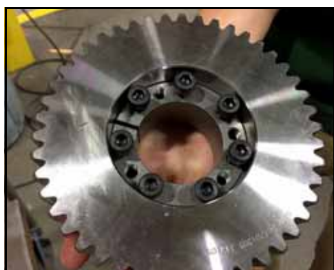
Rysunek 212 — Umieszczenie zespołu blokującego w kole zębatym
