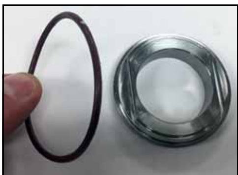
Rysunek 97 — Zainstalować o-ring łączący zaślepkę z gniazdem
