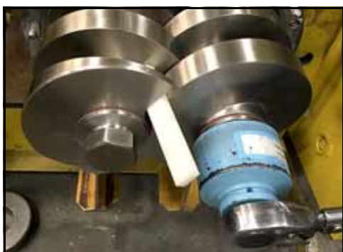
Rysunek 36 — Wsunięcie blokad
