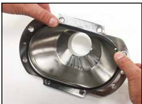
Rysunek 127 — Założenie uszczelki pokrywy
