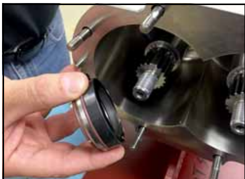
Rysunek 43 — Wyjęcie zespołu zaślepki uszczelniającej
