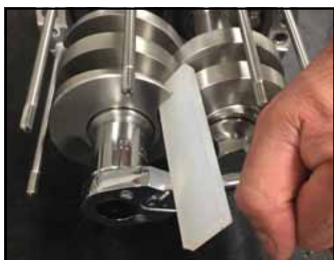
Rysunek 219 — Zakładanie nakrętki wirnika
