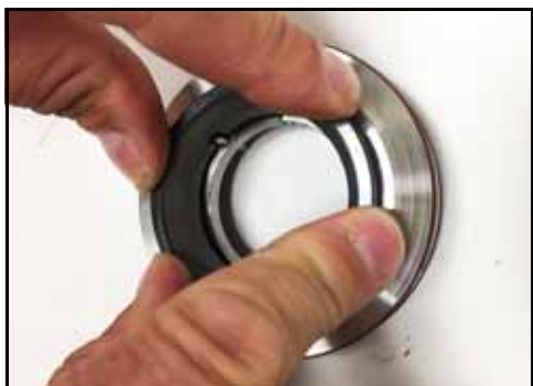
Rysunek 74 — Zakładanie uszczelki
