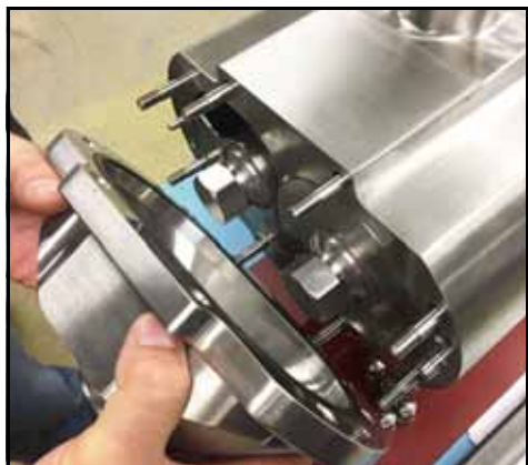
Rysunek 128 — Montaż pokrywy pompy
