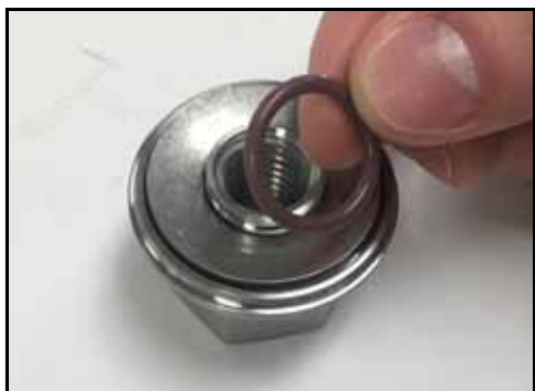
Rysunek 114 — Założenie o-ring elementu ustalającego podkładki
