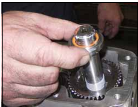
Rysunek 204 — Założenie nakrętki zabezpieczającej
