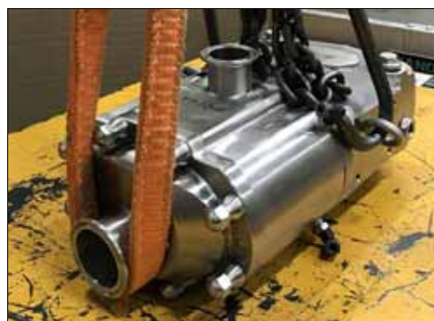
Rysunek 2 — Szczegóły miejsca podnoszenia — 015, 030-UTS
