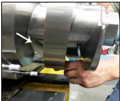
Rysunek 126 — Blokowanie prawego wirnika
