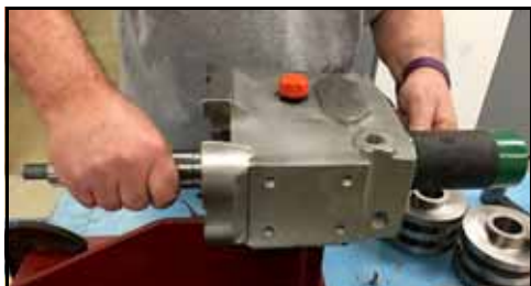
Rysunek 147 — Wysłunięcie krótkiego wału z obudowy przekładni
