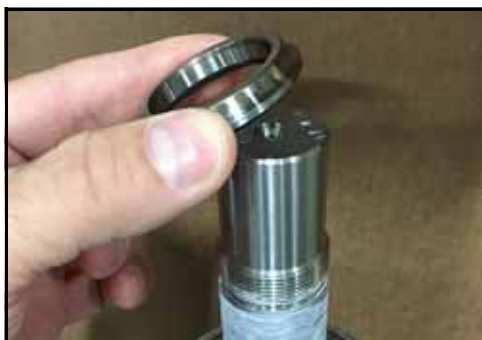
Rysunek 162 — Umieszczenie pierścienia nośnego na wale
