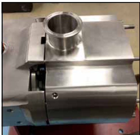
Rysunek 88 — Zamontowany korpus pompy
