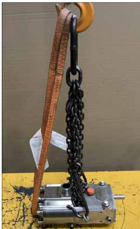
Rysunek 1 — Miejsce podnoszenia — 015, 030-UTS
