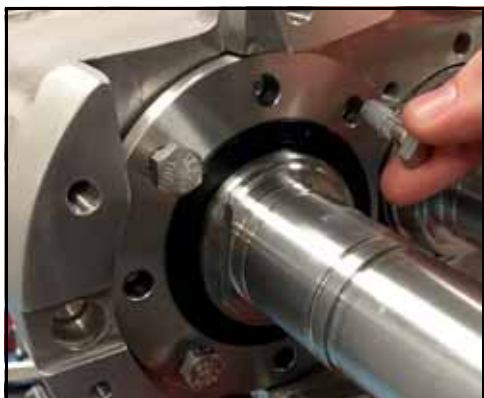
Rysunek 143 — Wykręcenie i wyjęcie wkrętów koszyka łożyska
