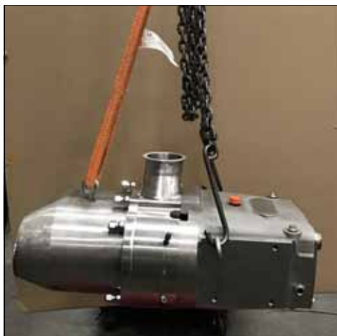
Rysunek 3 — Miejsce podnoszenia — 130, 220-UTS
