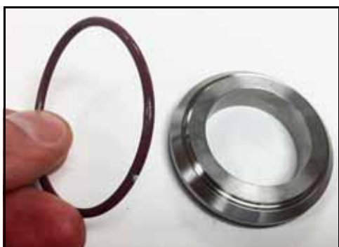
Rysunek 45 — Zdjęcie o-ringa łączącego zaślepkę z wirnikiem
