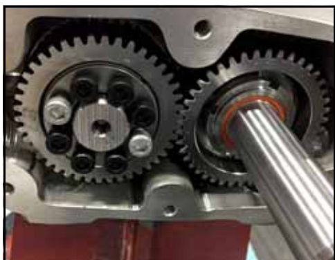
Rysunek 214 — Wyrównanie luźnego koła zębatego z kołem napędowym
