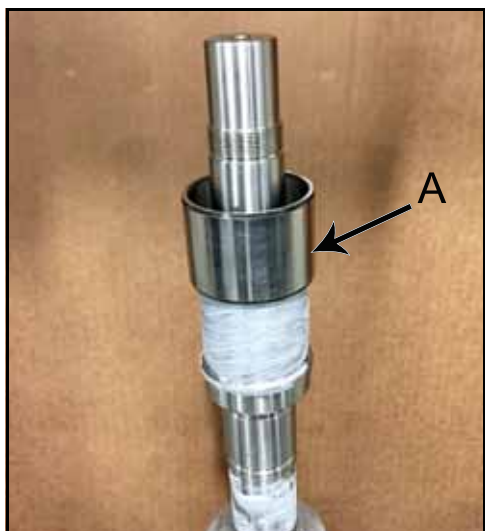
Rysunek 154 — Umieszczenie wewnętrznego pierścienia nośnego na wale
