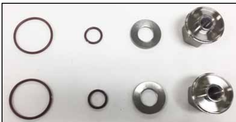
Rysunek 112 — Części nakrętki wirnika
