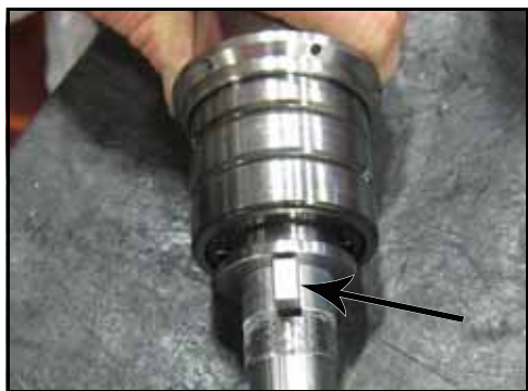
Rysunek 181 — Umieszczenie klina w rowku klinowym
