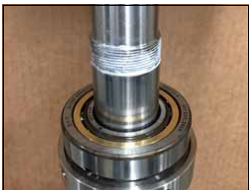
Rysunek 167 — Pierścień zamontowany na wale
