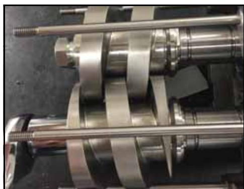
Rysunek 220 — Zakładanie nakrętki wirnika
