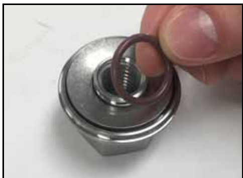
Rysunek 39 — Zdjęcie o-ringa elementu ustalającego podkładki
