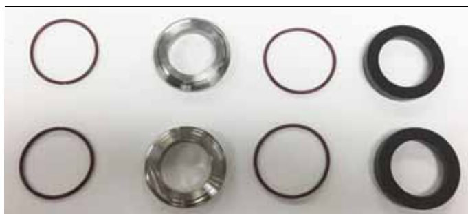
Rysunek 96 — Części zespołu zaślepki uszczelniającej
