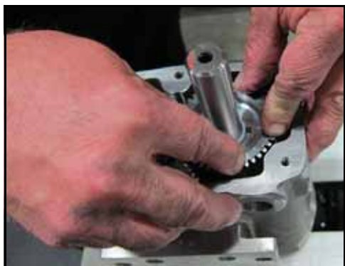
Rysunek 203 — Instalacja koła napędowego
