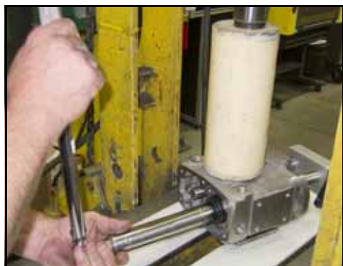
Rysunek 207 — Dokręcenie nakrętki zabezpieczającej
