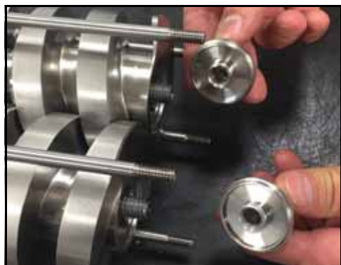
Rysunek 217 — Zakładanie nakrętki wirnika
