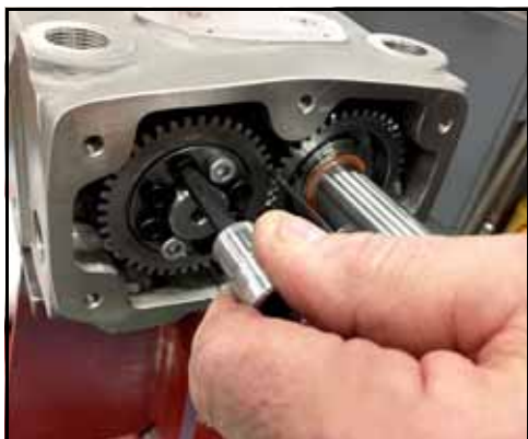
Rysunek 226 — Ręczne dokręcenie śrub zespołu blokującego
