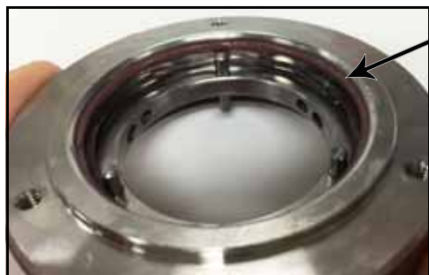
Rysunek 72 — Założony o-ring łączący uchwyt z uszczelką
