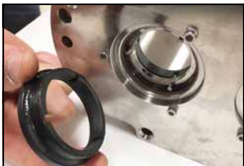
Rysunek 55 — Wyjęcie uszczelki
