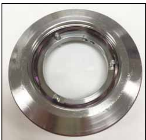
Rysunek 67 — Założona podkładka sprężysta uszczelki
