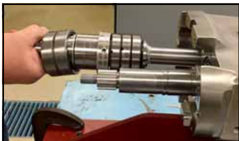
Rysunek 146 — Wyjęcie wału napędowego z obudowy przekładni
