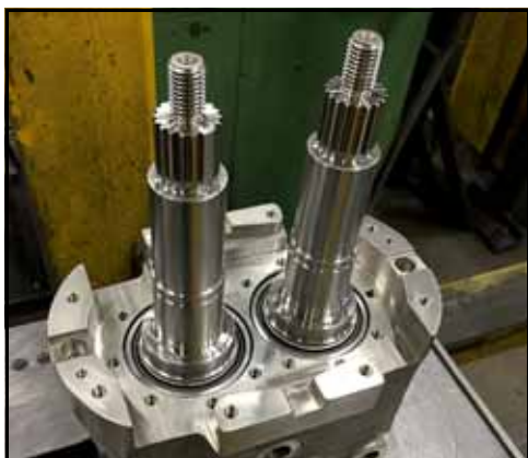
Rysunek 192 — Wały osadzone w przekładni
