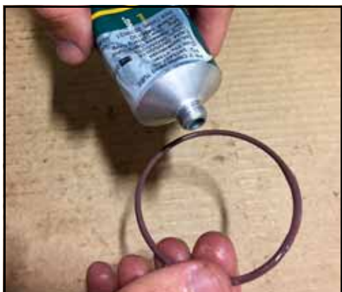
Rysunek 83 — Smarowanie o-ringów
