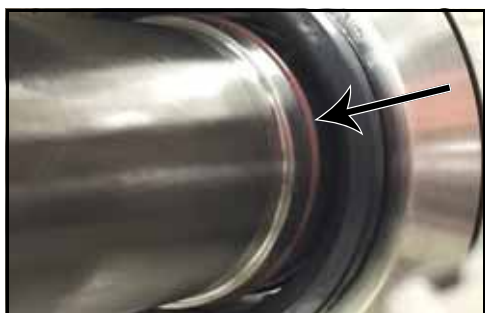
Rysunek 91 — Zakładanie o-ring na wale
