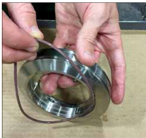
Rysunek 64 — Uchwyt uszczelki
