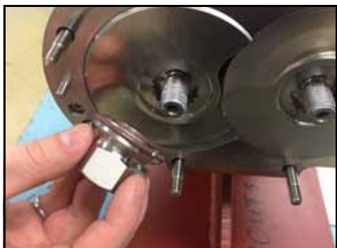
Rysunek 119 — Zakładanie nakrętki wirnika
