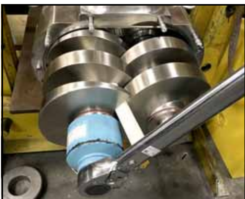
Rysunek 125 — Dokręcić nakrętkę lewego wirnika
