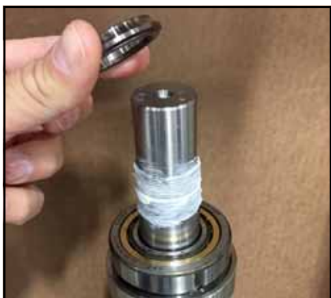
Rysunek 168 — Umieszczenie pierścienia nośnego na wale
