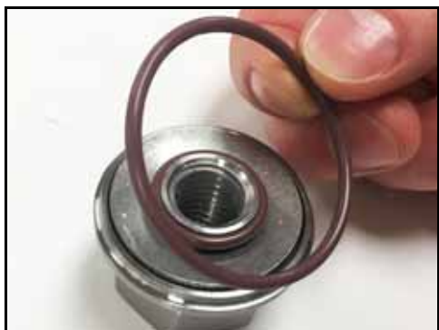
Rysunek 38 — Zdjęcie o-ringa nakrętki wirnika
