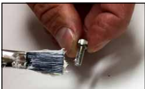
Rysunek 79 — Nakładanie środka antykorozyjnego
