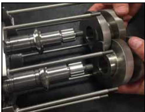
Rysunek 216 — Zakładanie wałów
