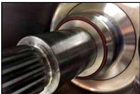
Rysunek 104 — Zaślepka uszczelniająca zamontowana na wale
