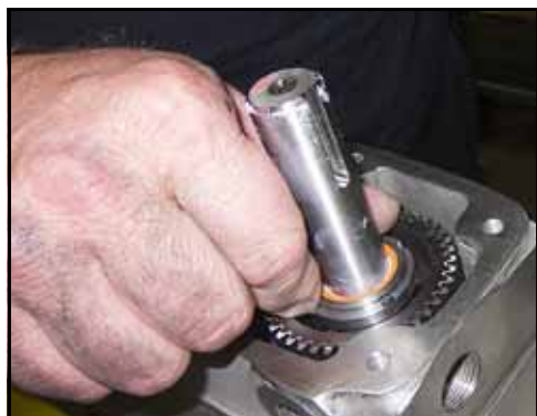
Rysunek 205 — Instalacja nakrętki zabezpieczającej
