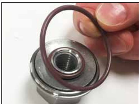
Rysunek 116 — Założenie o-ringa nakrętki wirnika
