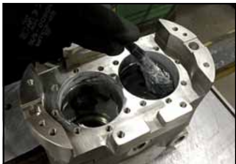
Rysunek 184 — Nakładanie środka antykorozyjnego
