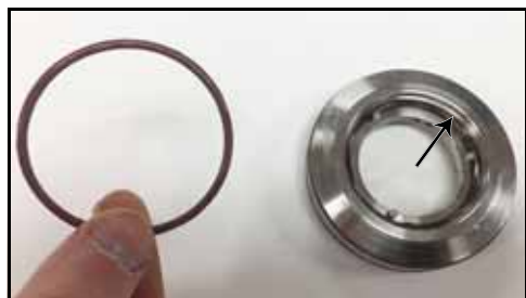
Rysunek 69 — O-ring łączący uchwyt z uszczelką
