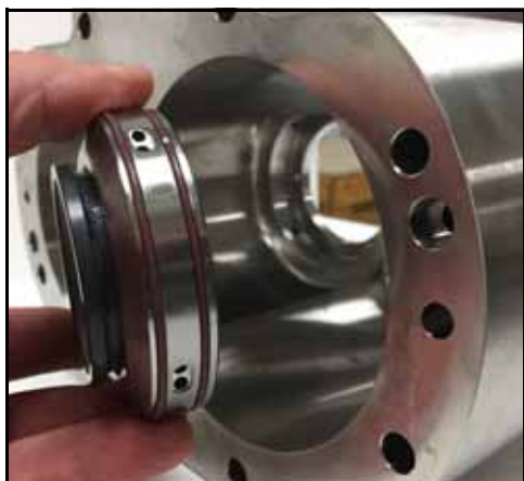
Rysunek 57 — Zdjęcie uchwytu uszczelki z korpusu
