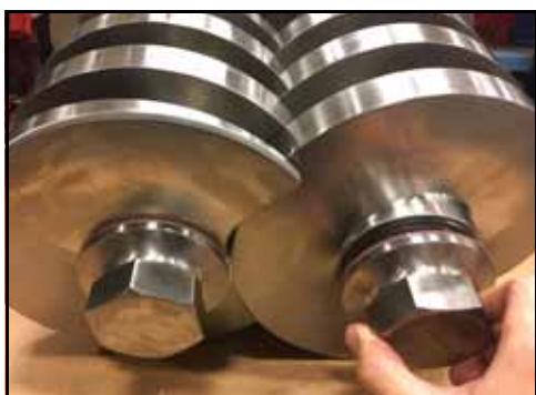
Rysunek 37 — Usunięcie nakrętek wirnika
