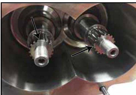
Rysunek 108 — Ustawienie wirnika i wypustu wału
