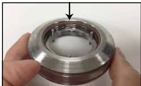
Rysunek 70 — Założony o-ring łączący uchwyt z uszczelką
