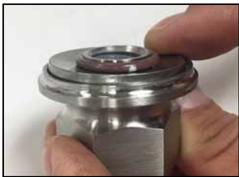
Rysunek 115 — Założona podkładka Belleville
