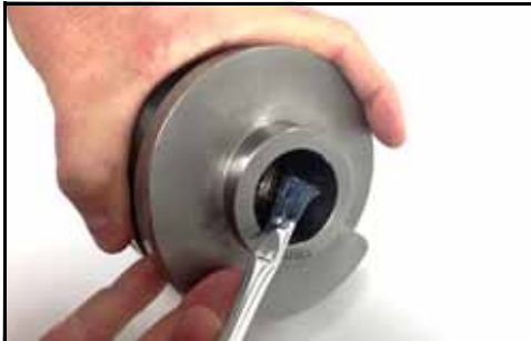
Rysunek 106 — Nakładanie środka antykorozyjnego
