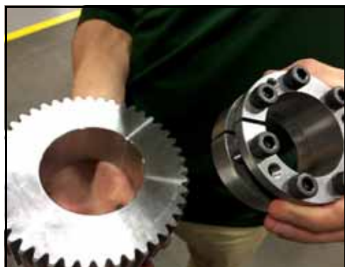
Rysunek 211 — Montaż zespołu blokującego w kole zębatym
