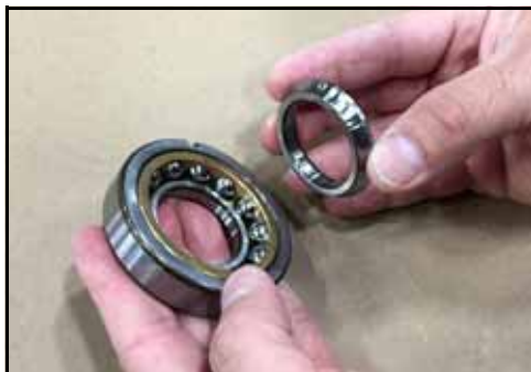
Rysunek 160 — Zdjęcie dolnego pierścienia nośnego
