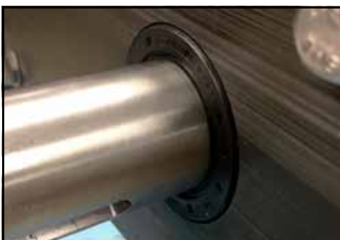
Rysunek 239 — Zainstalowana uszczelka olejowa
