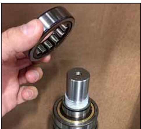
Rysunek 177 — Nałożenie łożyska na pierścień nośny
