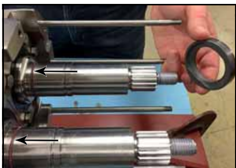
Rysunek 54 — Zdjęcie o-ringów z wału
