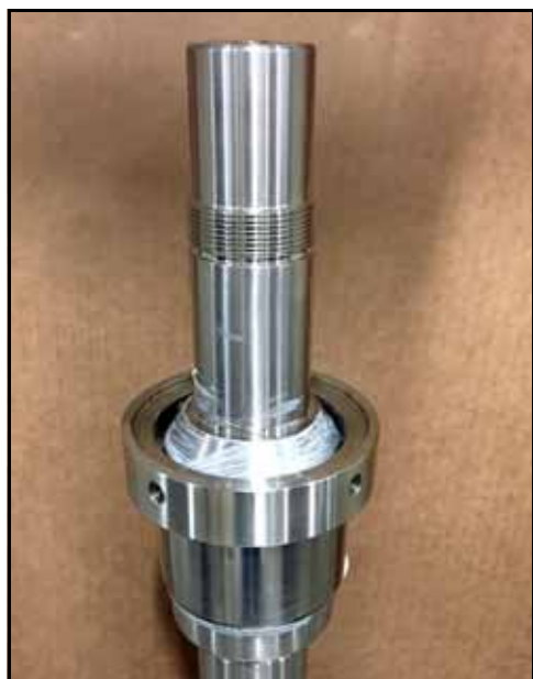
Rysunek 158 — Założony element dystansujący łożyska
