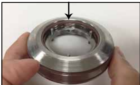
Rysunek 59 — Założony o-ring łączący uchwyt z uszczelką
