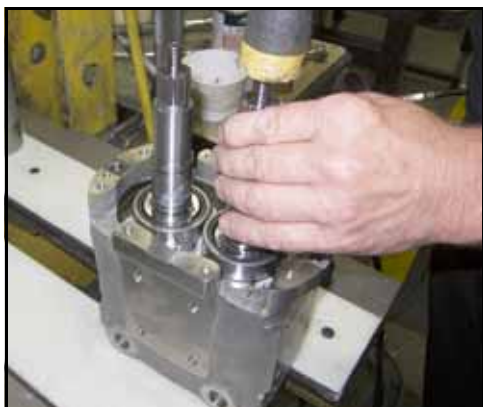
Rysunek 191 — Wstukiwanie wałów do środka otworów
