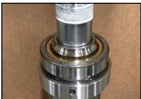
Rysunek 169 — Wciśnięcie pierścienia nośnego do łożyska
