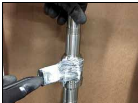
Rysunek 152 — Nakładanie środka antykorozyjnego
