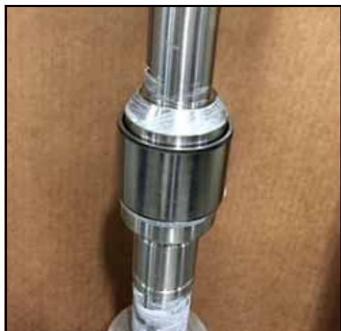
Rysunek 156 — Wewnętrzny pierścień zamontowany na wale
