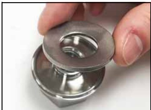
Rysunek 113 — Założenie podkładki Belleville
