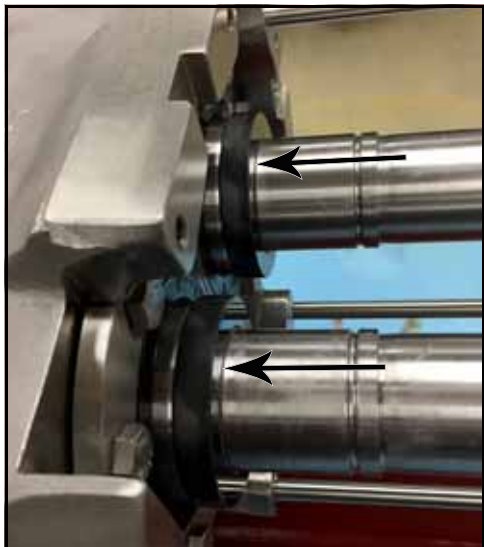
Rysunek 53 — Zdjęcie gniazd uszczelki
