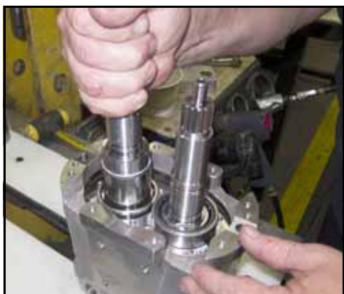
Rysunek 189 — Umieszczenie wału napędowego w otworze
