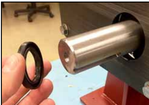
Rysunek 238 — Założenie uszczelki olejowej
