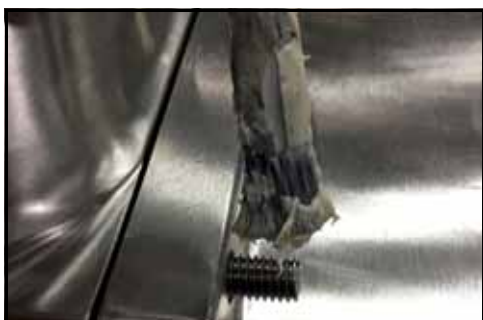
Rysunek 131 — Nakładanie środka antykorozyjnego na gwinty
