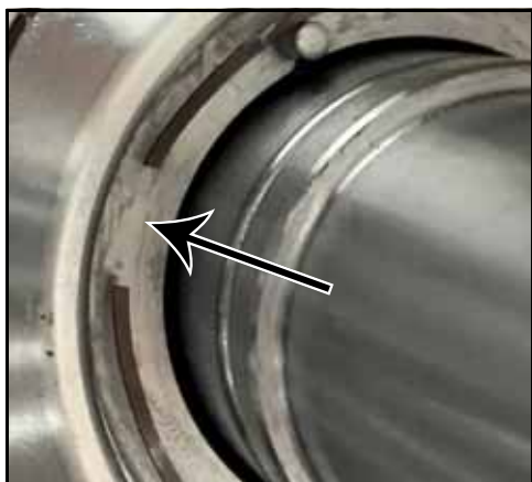
Rysunek 92 — Pozycja podkładki sprężystej uszczelki
