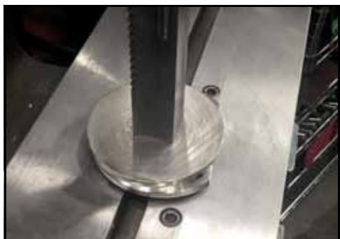
Rysunek 194 — Założenie uszczelki koszyka łożyska
