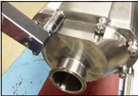
Rysunek 27 — Demontaż nakrętek pokrywy
