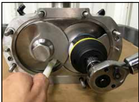
Rysunek 122 — Obrót kołka ustalającego
