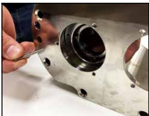
Rysunek 77 — Otwory wyosiować za pomocą trzpienia do współosiowego ustawiania otworów
