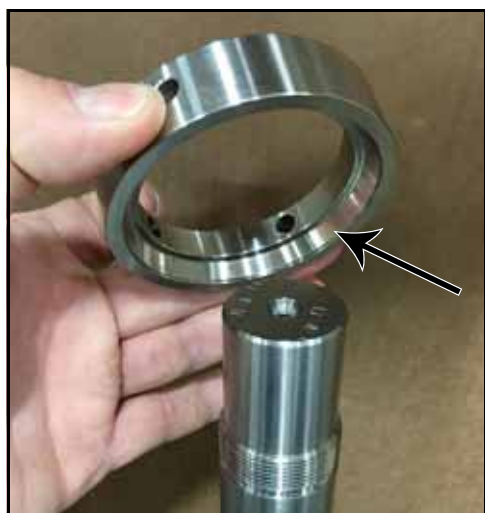
Rysunek 157 — Umieszczenie elementu dystansującego łożyska na wale
