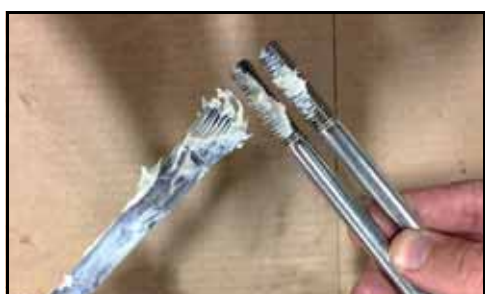
Rysunek 89 — Nakładanie środka antykorozyjnego na gwinty
