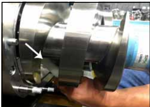
Rysunek 35 — Blokada wirnika
