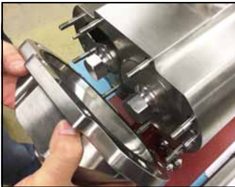
Rysunek 28 — Zdjęcie osłony pompy
