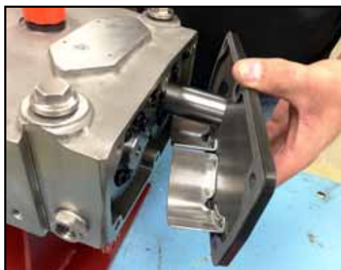
Rysunek 135 — Zdjęcie pokrywy obudowy przekładni
