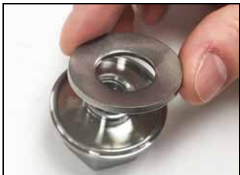
Rysunek 40 — Założenie podkładki Belleville
