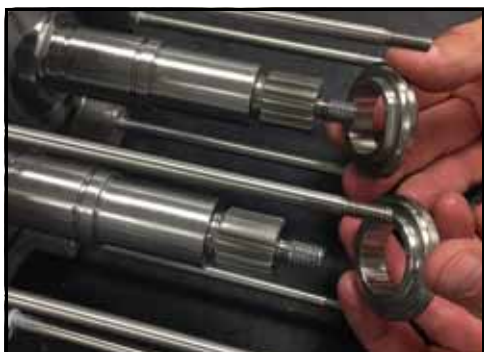
Rysunek 215 — Zakładanie zaślepek uszczelniających
