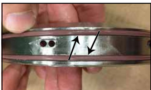
Rysunek 62 — O-ringi łączące uchwyt z korpusem
