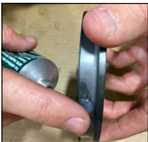
Rysunek 81 — Smarowanie zewnętrznej średnicy uszczelki
