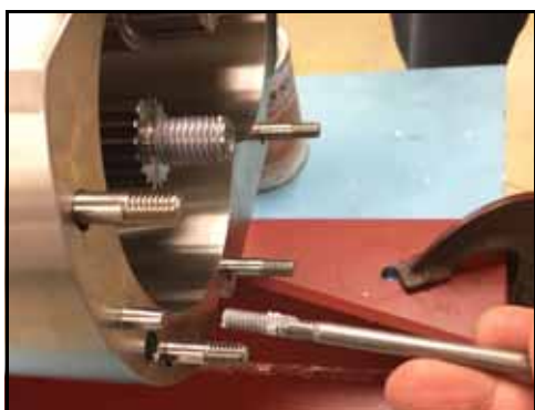
Rysunek 51 — Usunięcie wkrętów mocujących korpus
