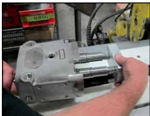
Rysunek 206 — Blokowanie wałów
