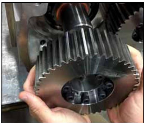
Rysunek 213 — Założenie kół zębatach na wały pompy
