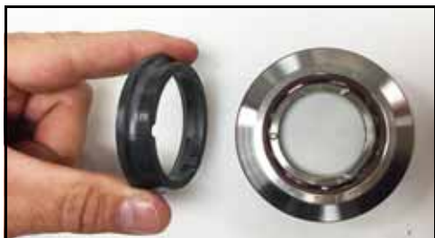
Rysunek 58 — Wyjęcie uszczelki
