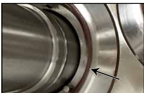
Rysunek 93 — Zakładanie o-ringu łączącego uchwyt z uszczelką
