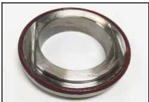
Rysunek 98 — Założony o-ring łączący zaślepkę z gniazdem
