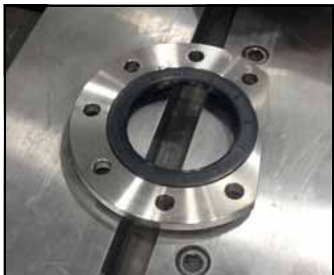
Rysunek 195 — Założona uszczelka koszyka łożyska
