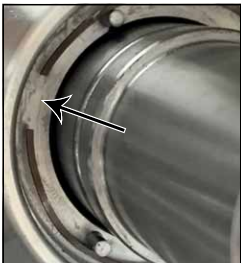
Rysunek 68 — Pozycja podkładki sprężystej uszczelki
