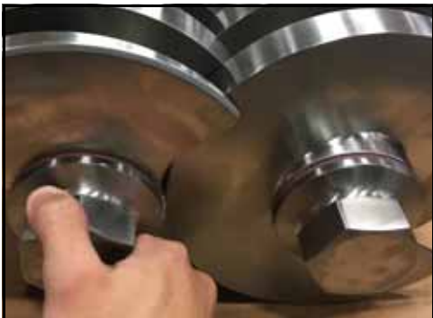
Rysunek 124 — Zakładanie nakrętki wirnika
