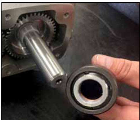
Rysunek 142 — Usunięcie nakrętki zabezpieczającej i koła zębatego
